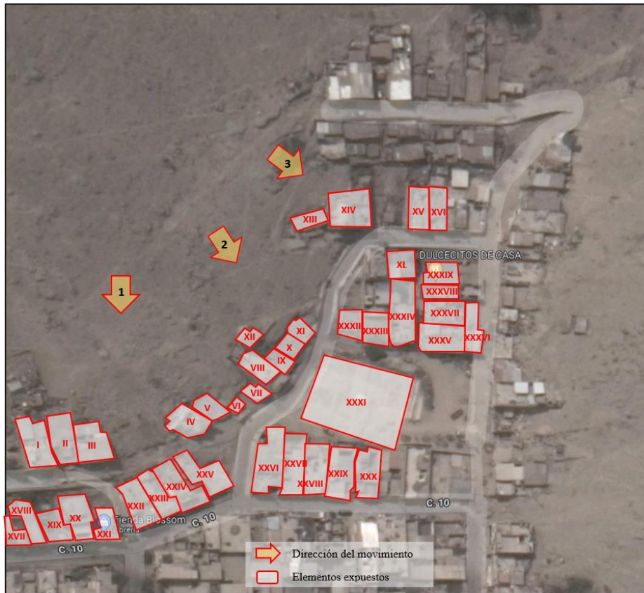
Figura 15. Elementos expuestos y dirección de movimientos en el talud analizado (Elaboración propia).
