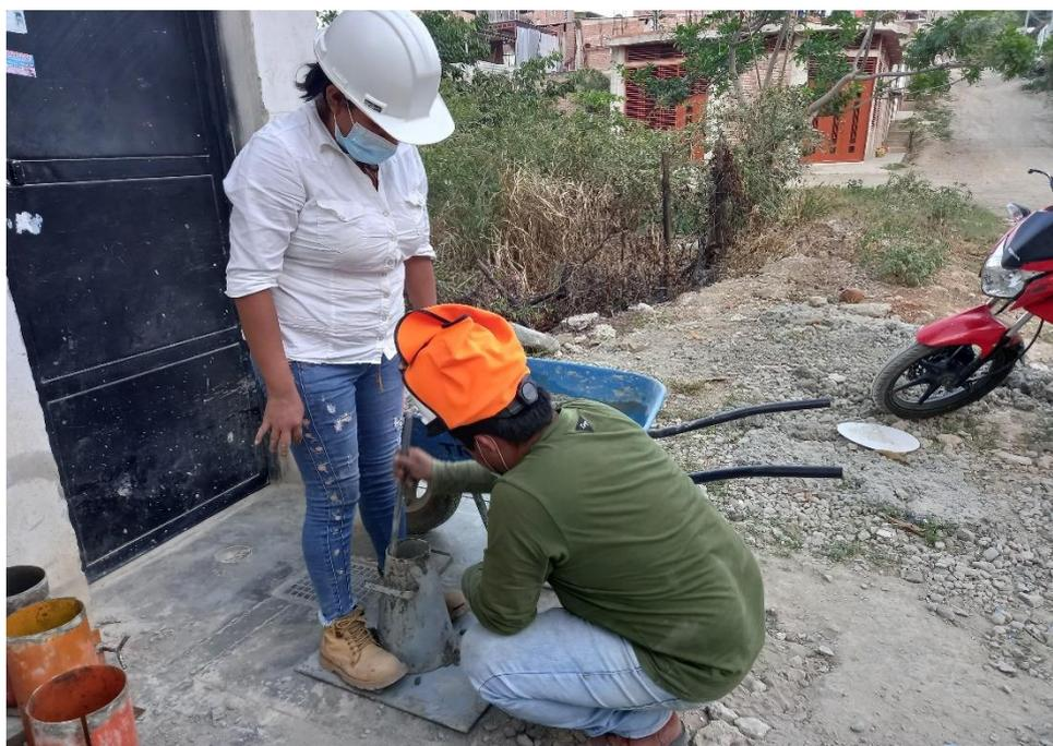
FOTO N.º 13: Realizando el ensayo de Cono de Abrams este consiste en rellenar un molde metálico de dimensiones normalizadas, en tres capas apasionadas con 25 de golpes de Varilla
