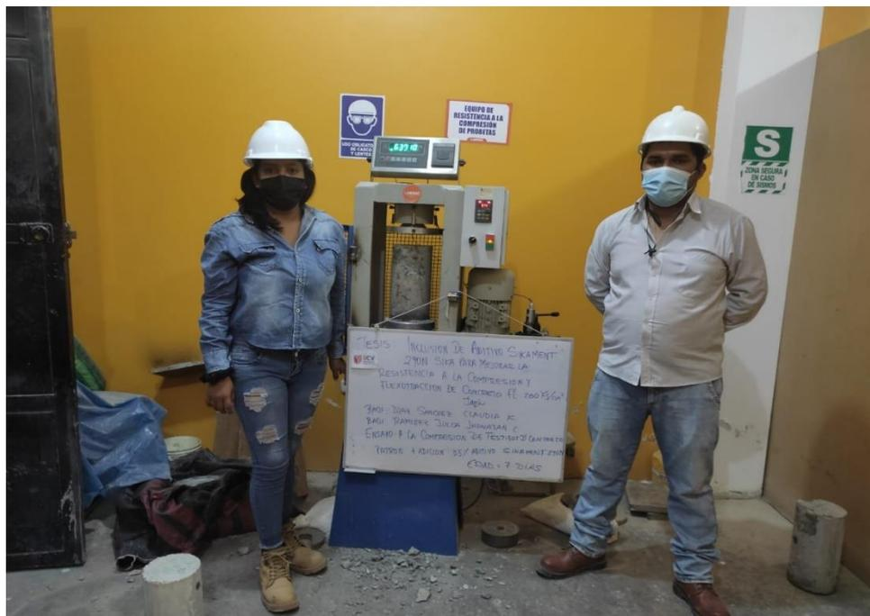
FOTO N.º 24: Ruptura de Probeta con la Inclusión del 5% del aditivo Sikament 290N a los 7 días.
