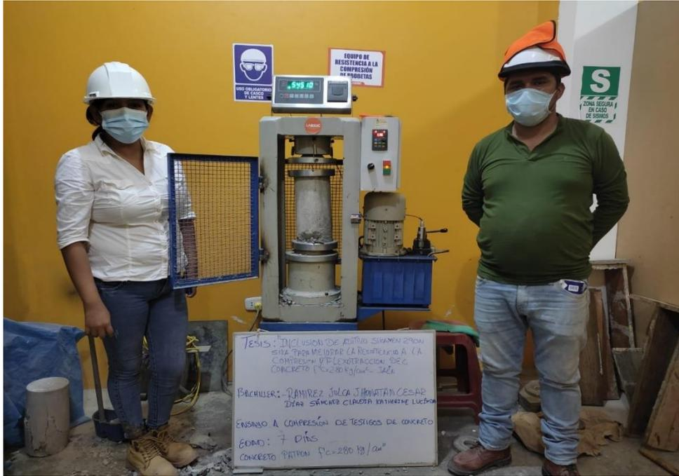
FOTO N.º 17: Ruptura de Probeta Cilíndrica De Concreto Patrón a los 7 días
