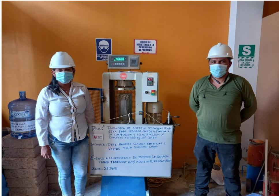
FOTO N.º 23: Ruptura de Probeta con la Inclusión del 4% del aditivo Sikament 290N a los 21 días.
