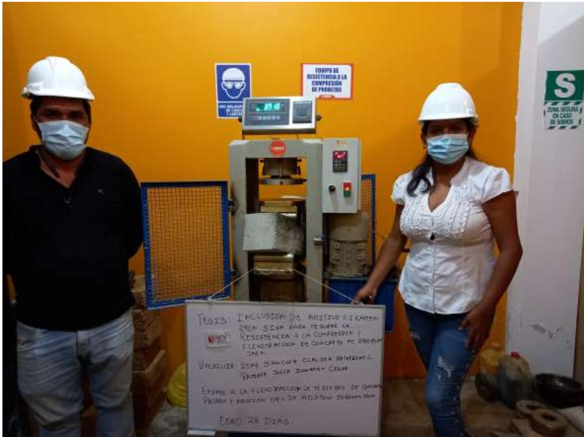
**FOTOGRAFIA 8:** Ensayo a Resistencia A La Flexión Del Concreto Endurecido ASTM C78 de la muestra de concreto patrón adicionando el 0.4 % de Aditivo Sikament 290N, a los 28 días del Proyecto Tesis: de la Tesis: "Inclusión De Aditivo Sikament 290N Para Mejorar La Resistencia A La Compresión Y Flexotracción Del Concreto F´C 280 Kg/Cm2, Jaén".
