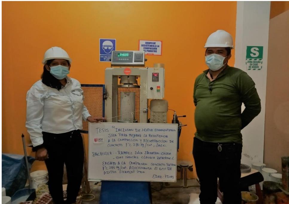
FOTO N.º 21: Ruptura de Probeta con la Inclusión del 4% del aditivo Sikament 290N a los 7 días.
