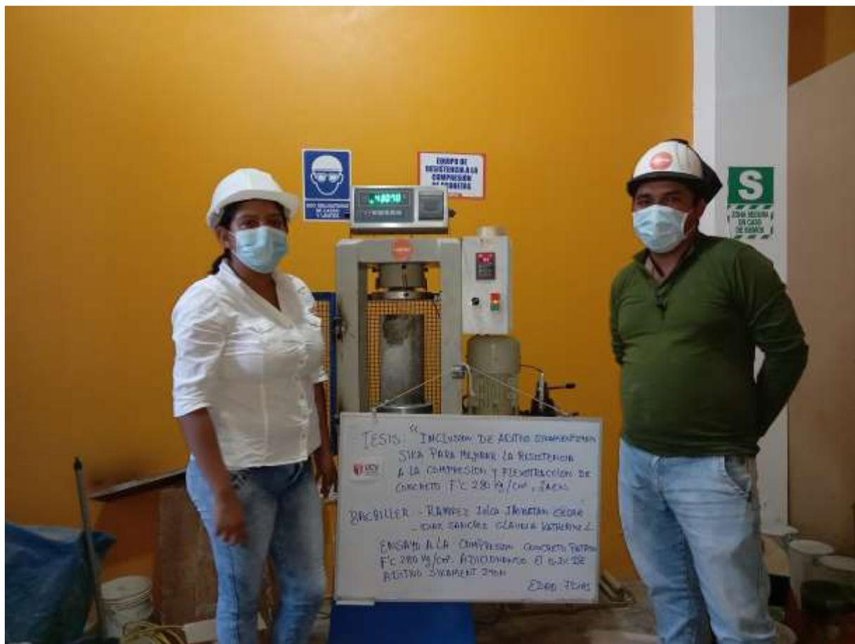
**FOTOGRAFIA 04:** Ensayo a compresión de testigos de concreto bajo la norma ASTM C39 de la muestra de concreto patrón adicionando el 0.3 % de Aditivo Sikament 290N, a los 7 días de la Tesis: "Inclusión De Aditivo Sikament 290N Para Mejorar La Resistencia A La Compresión Y Flexotracción Del Concreto F´C 280 Kg/Cm2, Jaén".
