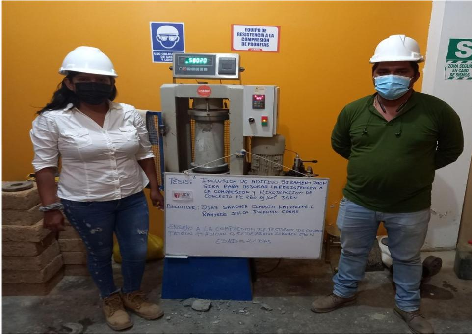
FOTO N.º 25: Ruptura de Probeta con la Inclusión del 5% del aditivo Sikament 290N a los 21 días.
