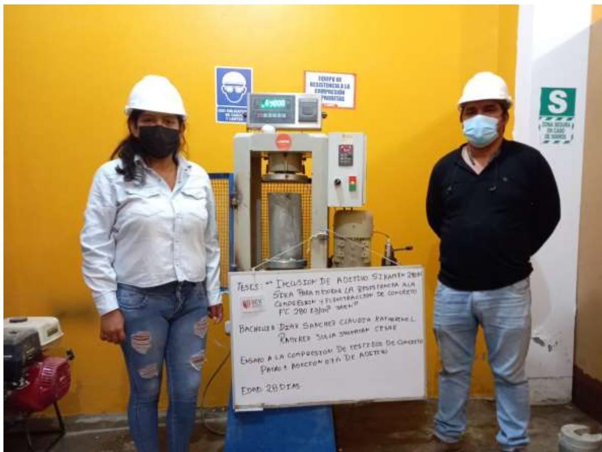
**FOTOGRAFIA 16:** Ensayo a compresión de testigos de concreto bajo la norma ASTM C39 de la muestra de concreto patrón adicionando el 0.7 % de Aditivo Sikament 290N, a los 28 días de la Tesis: "Inclusión De Aditivo Sikament 290N Para Mejorar La Resistencia A La Compresión Y Flexotracción Del Concreto F´C 280 Kg/Cm2, Jaén".
