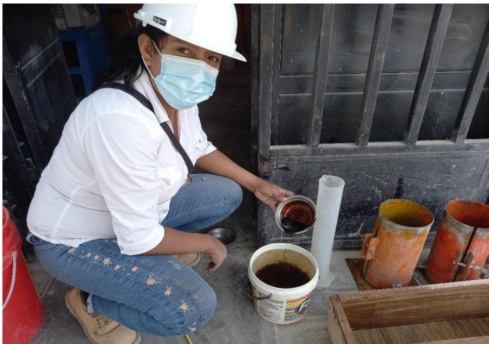
FOTO N.º 10: Procediendo con la Inclusión del Aditivo Sikament 290N para los Ensayos de Probetas Cilíndricas y Vigas.
