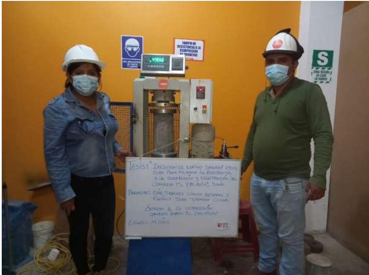
**FOTOGRAFIA 02:** Ensayo a compresión de testigos de concreto bajo la norma ASTM C39 de la muestra de concreto patrón a los 14 días de la Tesis: "Inclusión De Aditivo Sikament 290N Para Mejorar La Resistencia A La Compresión Y Flexotracción Del Concreto F' C 280 Kg/Cm2, Jaén"
