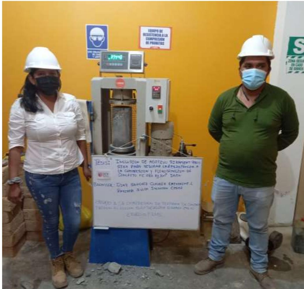
**FOTOGRAFIA 14:** Ensayo a compresión de testigos de concreto bajo la norma ASTM C39 de la muestra de concreto patrón adicionando el 0.6 % de Aditivo Sikament 290N, a los 7 días de la Tesis: "Inclusión De Aditivo Sikament 290N Para Mejorar La Resistencia A La Compresión Y Flexotracción Del Concreto F´C 280 Kg/Cm2, Jaén".
