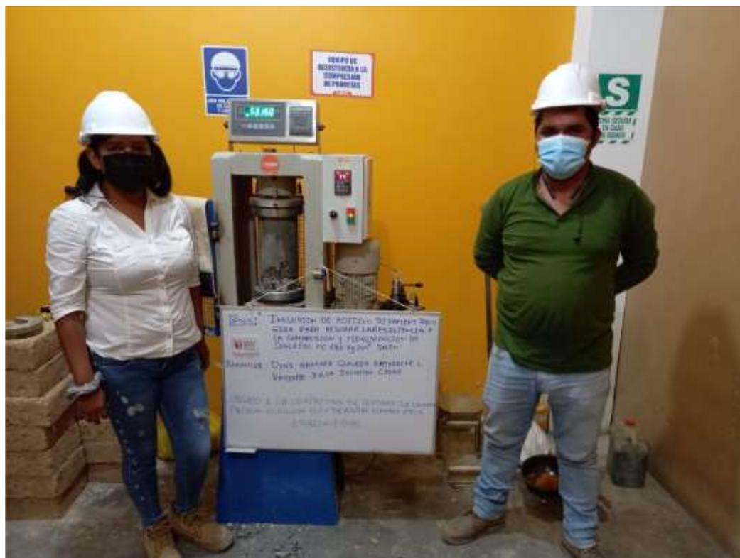
**FOTOGRAFIA 15:** Ensayo a compresión de testigos de concreto bajo la norma ASTM C39 de la muestra de concreto patrón adicionando el 0.6 % de Aditivo Sikament 290N, a los 7 días de la Tesis: "Inclusión De Aditivo Sikament 290N Para Mejorar La Resistencia A La Compresión Y Flexotracción Del Concreto F ´C 280 Kg/Cm2, Jaén".
