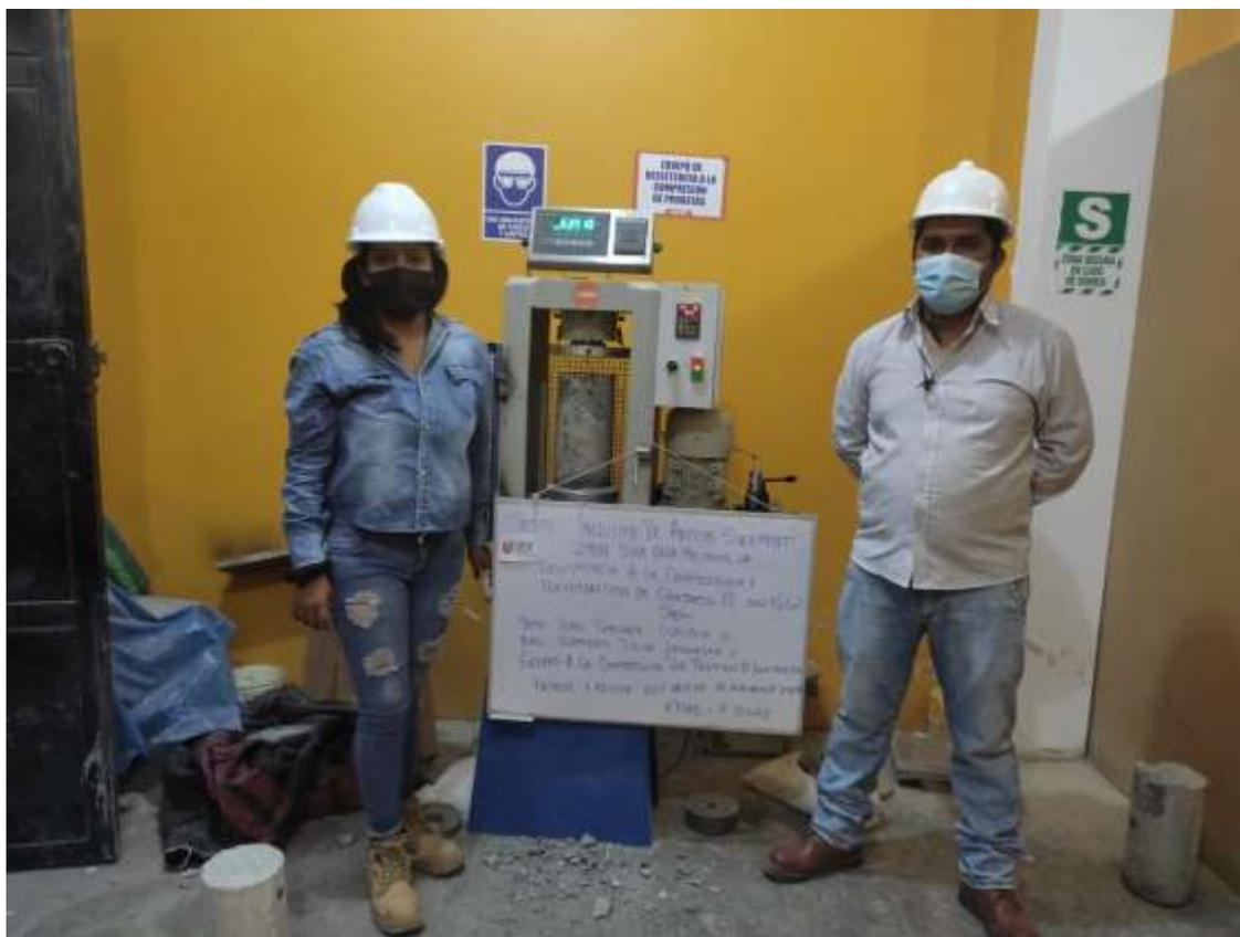
**FOTOGRAFIA 11:** Ensayo a compresión de testigos de concreto bajo la norma ASTM C39 de la muestra de concreto patrón adicionando el 0.5 % de Aditivo Sikament 290N, a los 7 días de la Tesis: "Inclusión De Aditivo Sikament 290N Para Mejorar La Resistencia A La Compresión Y Flexotracción Del Concreto F´C 280 Kg/Cm2, Jaén".
