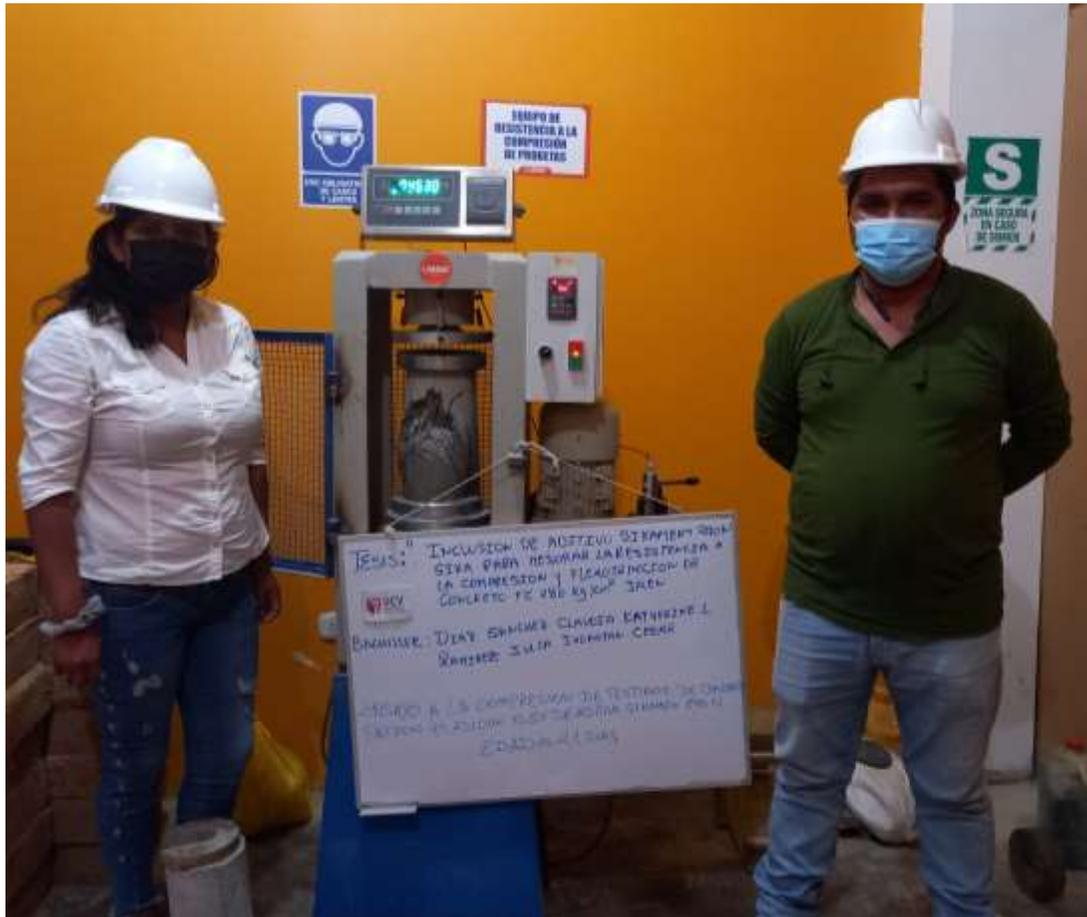
**FOTOGRAFIA 12:** Ensayo a compresión de testigos de concreto bajo la norma ASTM C39 de la muestra de concreto patrón adicionando el 0.5 % de Aditivo Sikament 290N, a los 21 días de la Tesis: "Inclusión De Aditivo Sikament 290N Para Mejorar La Resistencia A La Compresión Y Flexotracción Del Concreto F´C 280 Kg/Cm2, Jaén".
