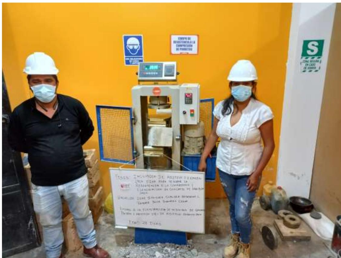
**FOTOGRAFIA 9:** Ensayo a Resistencia A La Flexión Del Concreto Endurecido ASTM C78 de la muestra de concreto patrón adicionando el 0.4 % de Aditivo Sikament 290N, a los 28 días del Proyecto Tesis: de la Tesis: "Inclusión De Aditivo Sikament 290N Para Mejorar La Resistencia A La Compresión Y Flexotracción Del Concreto F´C 280 Kg/Cm2, Jaén".
