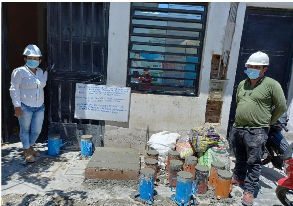
FOTO N.º 16: Elaboración de Probetas Cilíndricas y Vigas Con la Adición del Aditivo Sikament 290N
