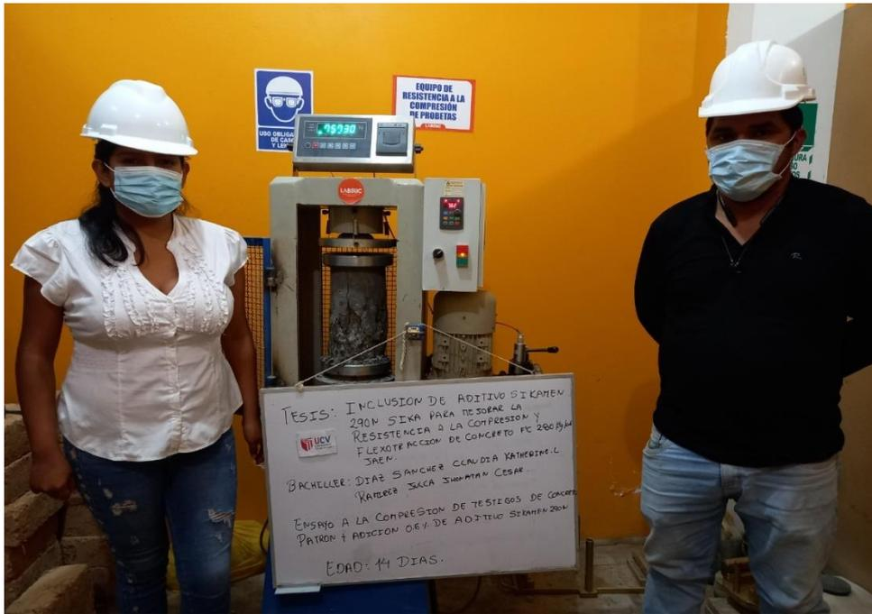
FOTO N.º 27: Ruptura de Probeta con la Inclusión del 6% del aditivo Sikament 290N a los 14 días.
