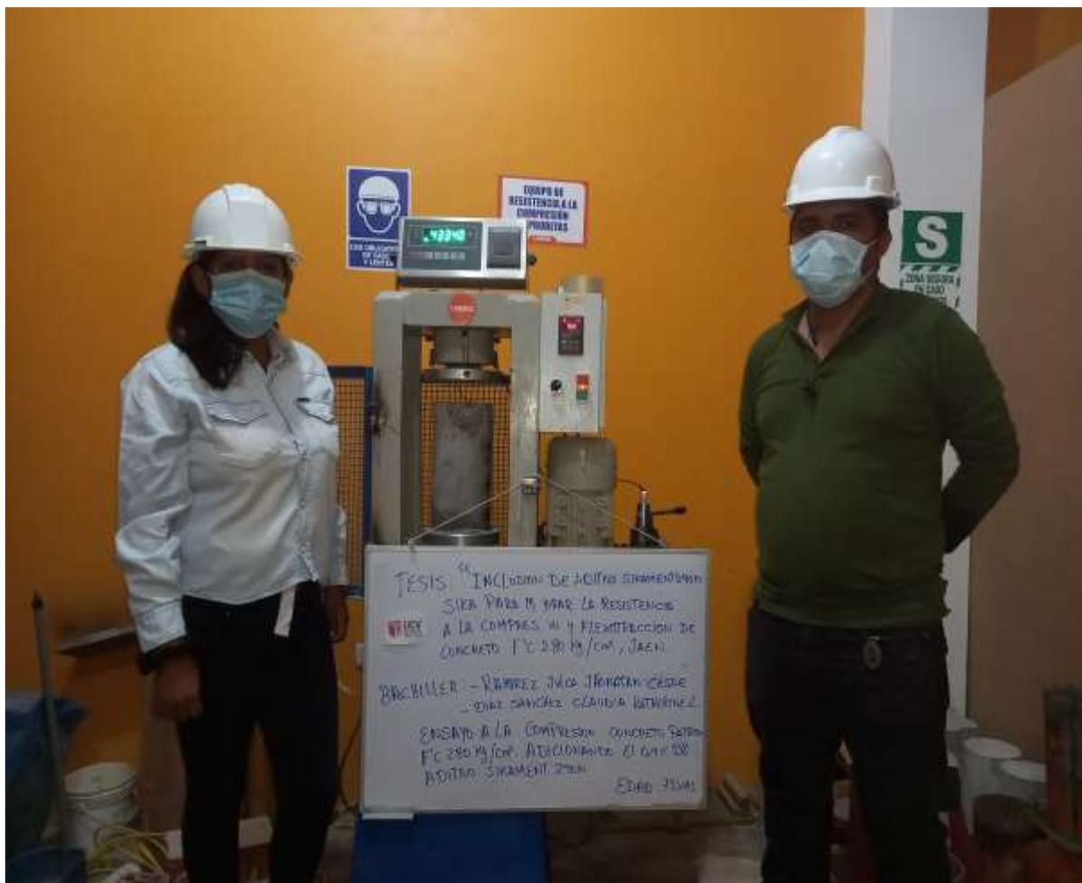
**FOTOGRAFIA 06:** Ensayo a compresión de testigos de concreto bajo la norma ASTM C39 de la muestra de concreto patrón adicionando el 0.4 % de Aditivo Sikament 290N, a los 7 días de la Tesis: "Inclusión De Aditivo Sikament 290N Para Mejorar La Resistencia A La Compresión Y Flexotracción Del Concreto F´C 280 Kg/Cm2, Jaén".
