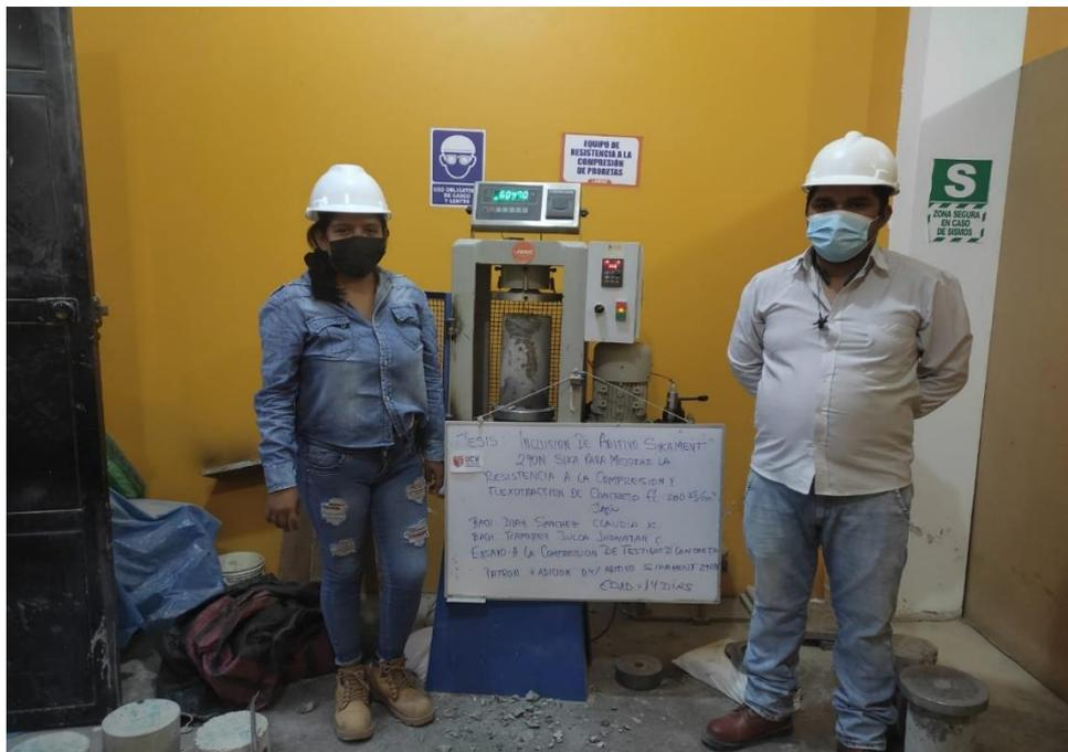
FOTO N.º 22: Ruptura de Probeta con la Inclusión del 4% del aditivo Sikament 290N a los 14 días.
