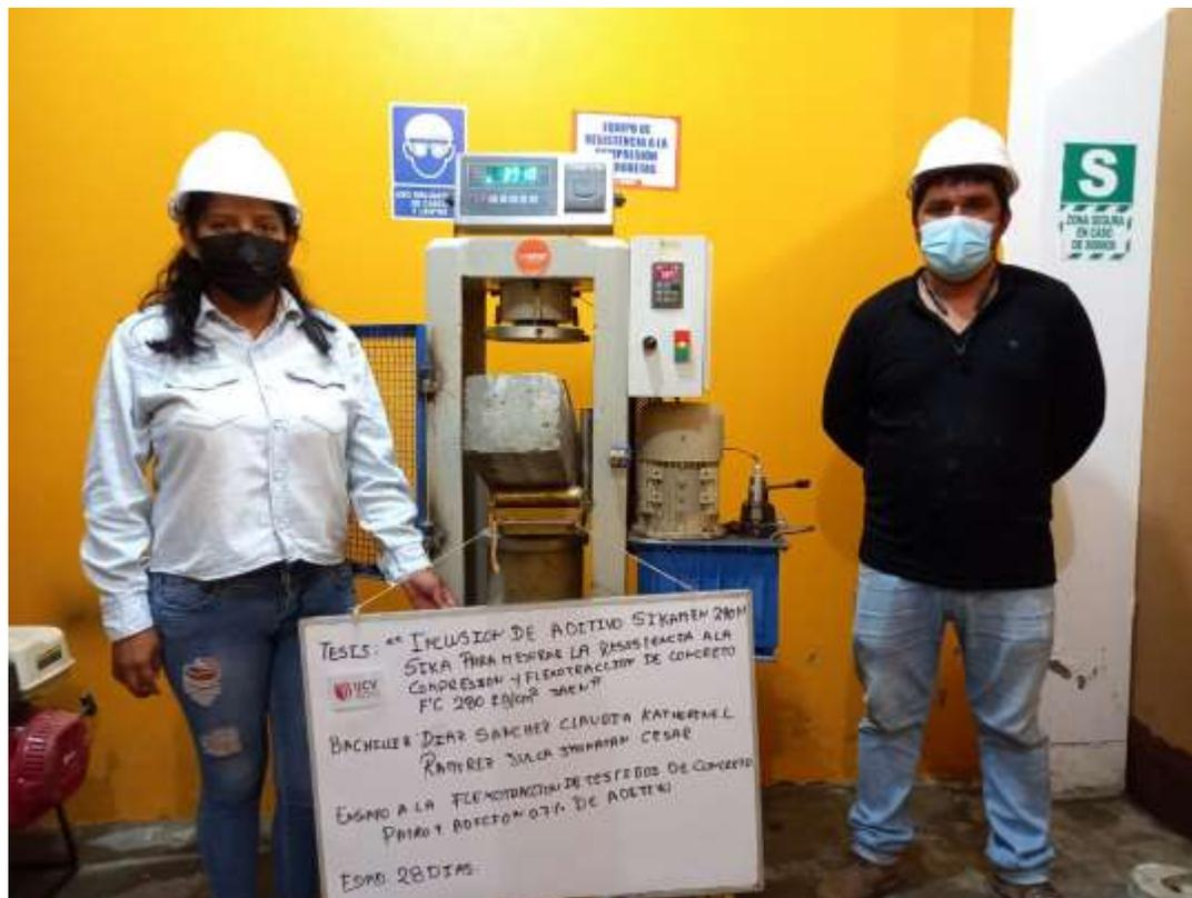
**FOTOGRAFIA 18:** Ensayo a Resistencia A La Flexión Del Concreto Endurecido ASTM C78 de la muestra de concreto patrón adicionando el 0.7 % de Aditivo Sikament 290N, a los 28 días del Proyecto Tesis: de la Tesis: "Inclusión De Aditivo Sikament 290N Para Mejorar La Resistencia A La Compresión Y Flexotracción Del Concreto F´C 280 Kg/Cm2, Jaén".
