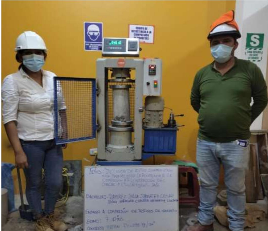
**FOTOGRAFIA 01:** Ensayo a compresión de testigos de concreto bajo la norma ASTM C39 de la muestra de concreto patrón a los 7 días de la Tesis: "Inclusión De Aditivo Sikament 290N Para Mejorar La Resistencia A La Compresión Y Flexotracción Del Concreto F´C 280 Kg/Cm2, Jaén"
