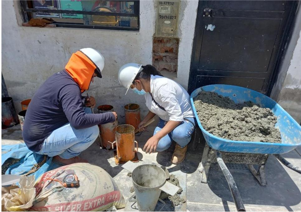
FOTO N.º 11: Ejecutando Golpes con el Martillo de goma en el Molde de la Probeta Cilíndrica
