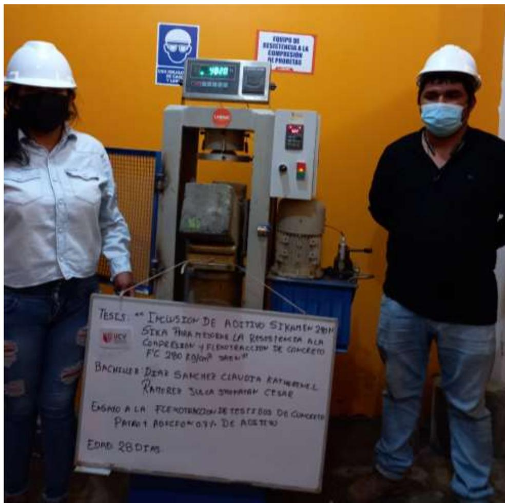
**FOTOGRAFIA 17:** Ensayo a Resistencia A La Flexión Del Concreto Endurecido ASTM C78 de la muestra de concreto patrón adicionando el 0.7 % de Aditivo Sikament 290N, a los 28 días del Proyecto Tesis: de la Tesis: "Inclusión De Aditivo Sikament 290N Para Mejorar La Resistencia A La Compresión Y Flexotracción Del Concreto F´C 280 Kg/Cm2, Jaén".
