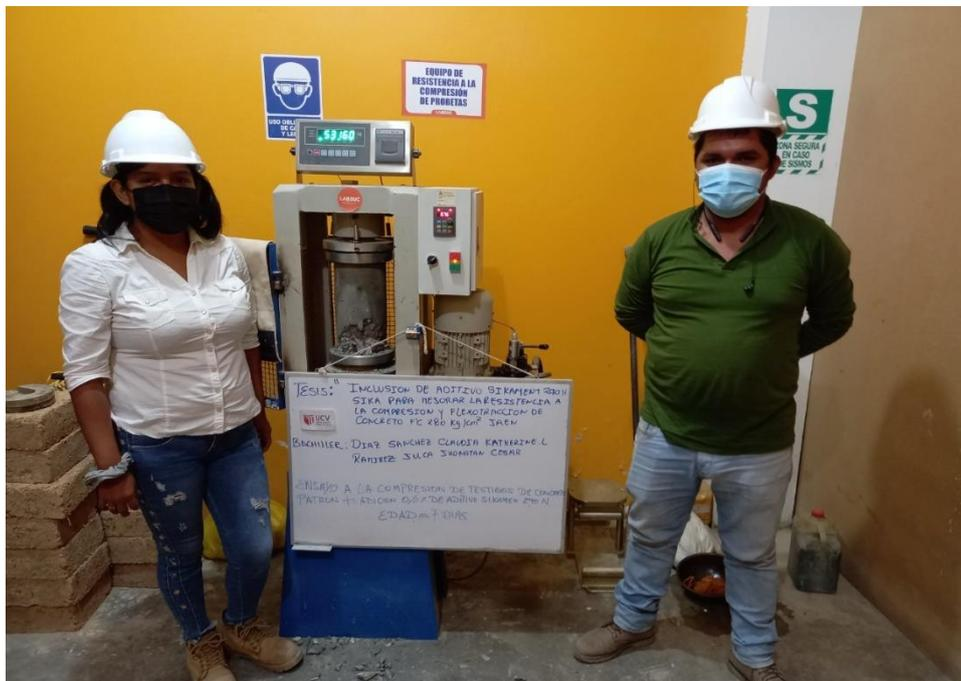
FOTO N.º 26: Ruptura de Probeta con la Inclusión del 6% del aditivo Sikament 290N a los 7 días.
