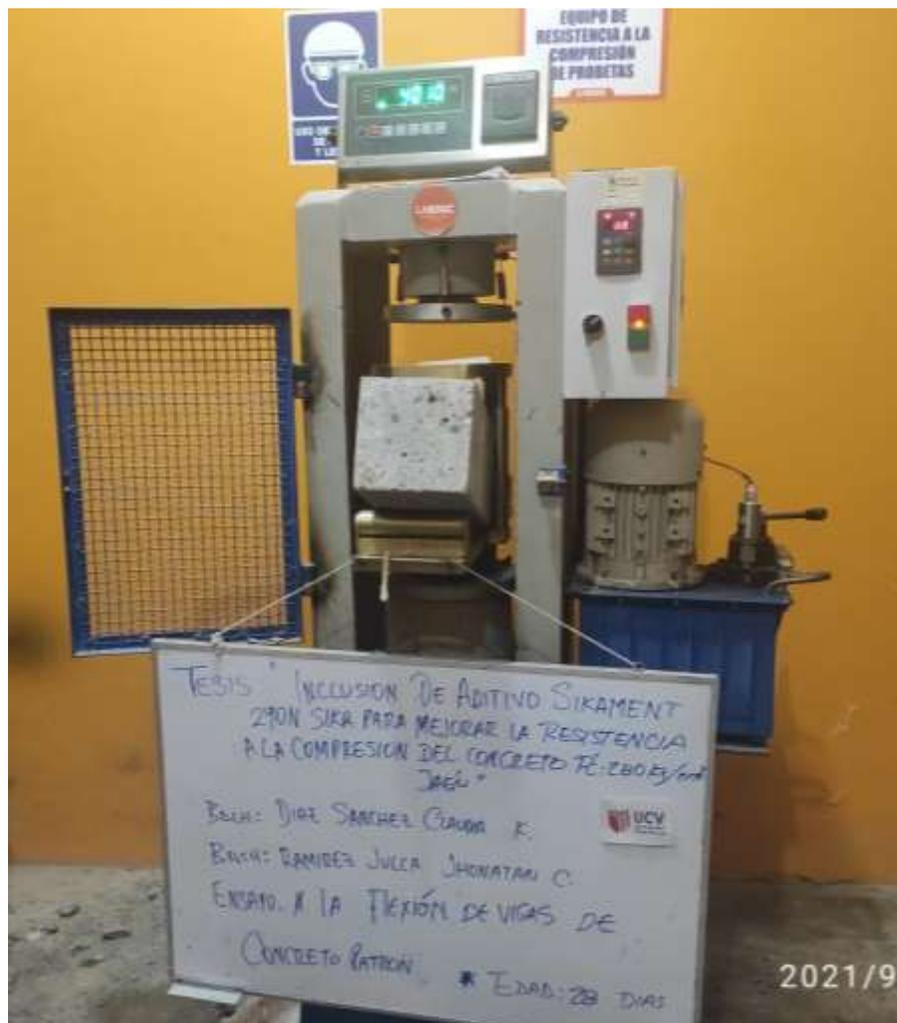
**FOTOGRAFIA 03:** Ensayo a Resistencia A La Flexión Del Concreto Endurecido ASTM C78 de la muestra de concreto patrón a los 28 días del Proyecto Tesis: "Inclusión De Aditivo Sikament 290N Para Mejorar La Resistencia A La Compresión Y Flexotracción Del Concreto F´C 280 Kg/Cm2, Jaén".
