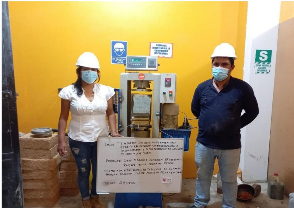
FOTO N.º 20: Ruptura de Viga con la Inclusión del 3% del aditivo Sikament 290N a los 28 días.
