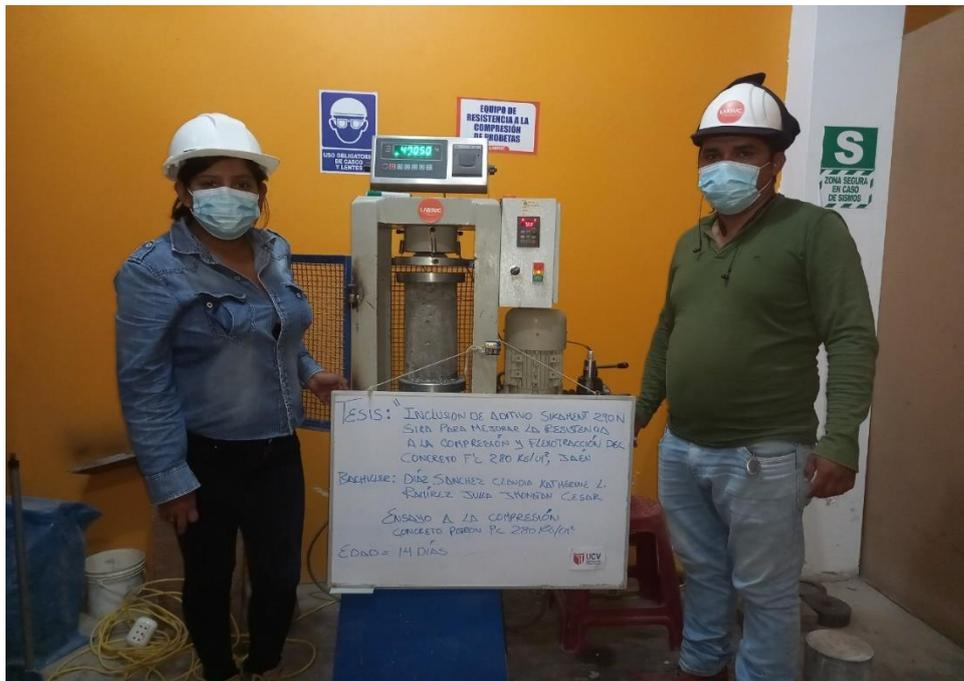
FOTO N.º 18: Ruptura de Probeta De Concreto Patrón a los 14 días
