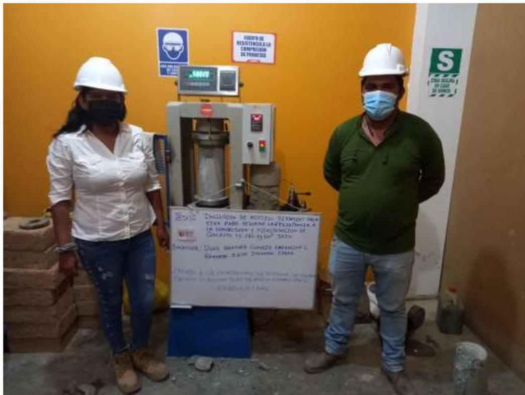
**FOTOGRAFIA 13:** Ensayo a compresión de testigos de concreto bajo la norma ASTM C39 de la muestra de concreto patrón adicionando el 0.5 % de Aditivo Sikament 290N, a los 21 días de la Tesis: "Inclusión De Aditivo Sikament 290N Para Mejorar La Resistencia A La Compresión Y Flexotracción Del Concreto F´C 280 Kg/Cm2, Jaén".
