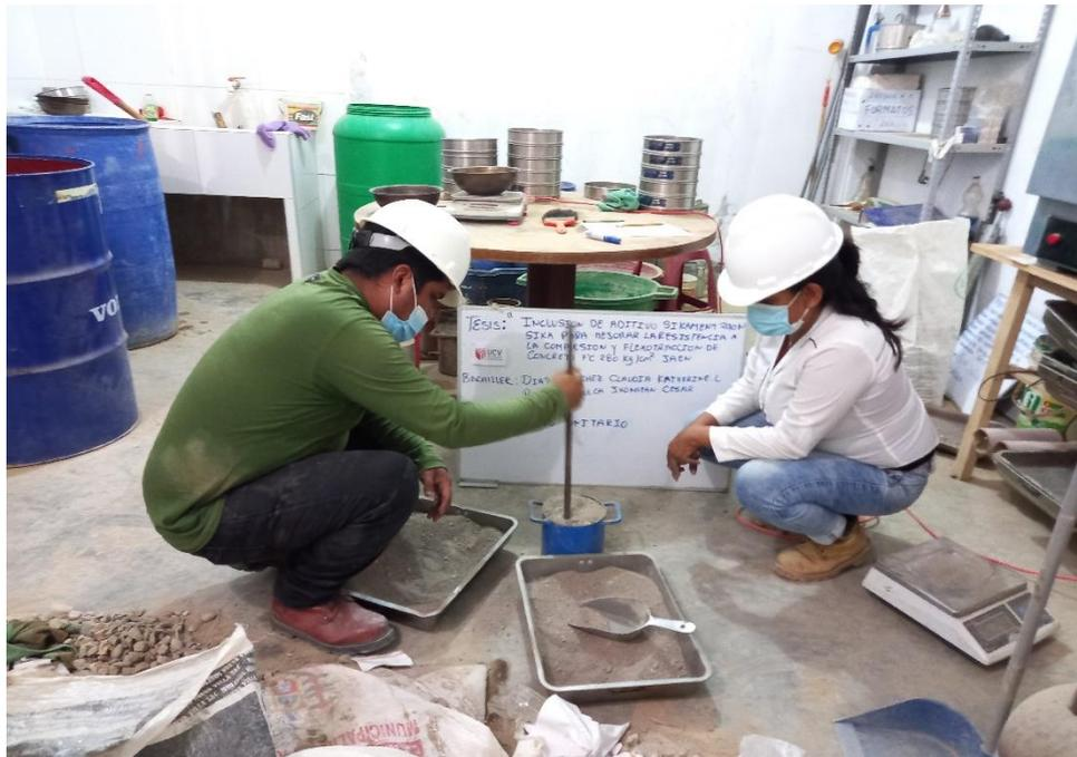
FOTO N.º 08: Elaborando el Ensayo de Peso Unitario
