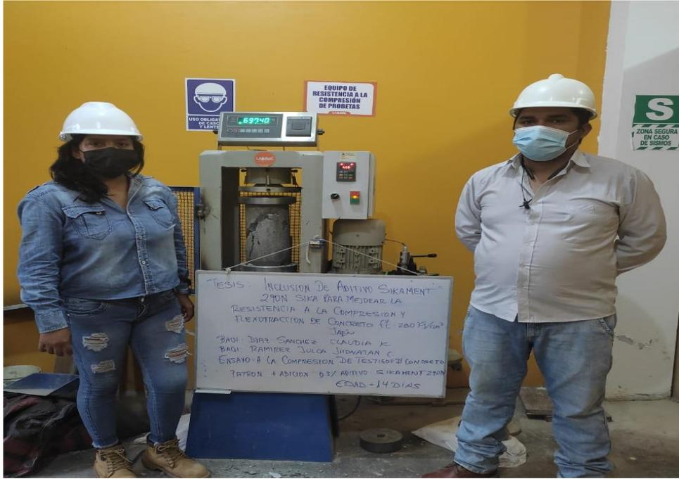
FOTO N.º 19: Ruptura de Probeta con la Inclusión del 3% del aditivo Sikament 290N a los 7 días.
