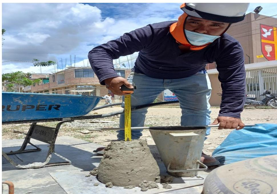
FOTO N.º 14: Después de retirar el molde, podemos medir el asentamiento que experimenta el Hormigón colocada en su interior
