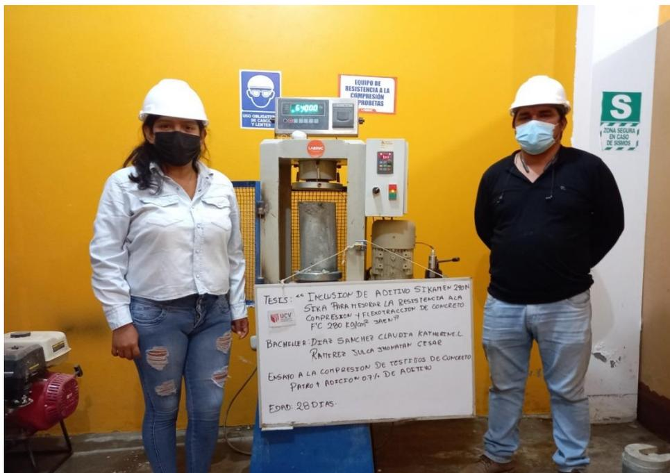
FOTO N.º 28: Ruptura de Probeta con la Inclusión del 7% del aditivo Sikament 290N a los 28 días.
