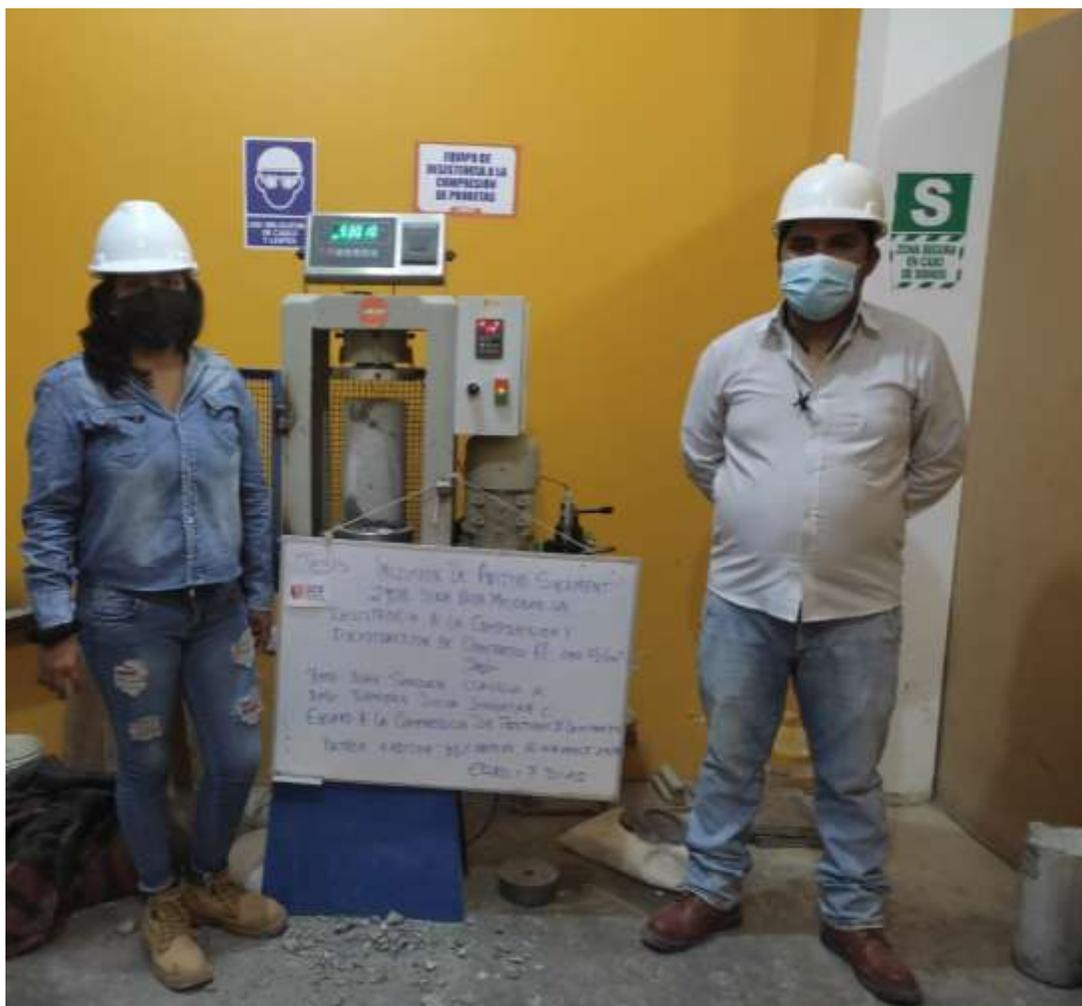
**FOTOGRAFIA 10:** Ensayo a compresión de testigos de concreto bajo la norma ASTM C39 de la muestra de concreto patrón adicionando el 0.5 % de Aditivo Sikament 290N, a los 7 días de la Tesis: "Inclusión De Aditivo Sikament 290N Para Mejorar La Resistencia A La Compresión Y Flexotracción Del Concreto F´C 280 Kg/Cm2, Jaén".
