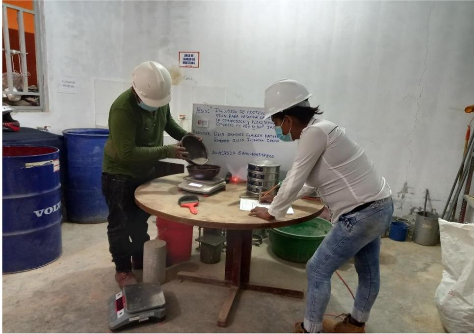
FOTO N.º 07: Realizando el Ensayo de Análisis Granulométrico
