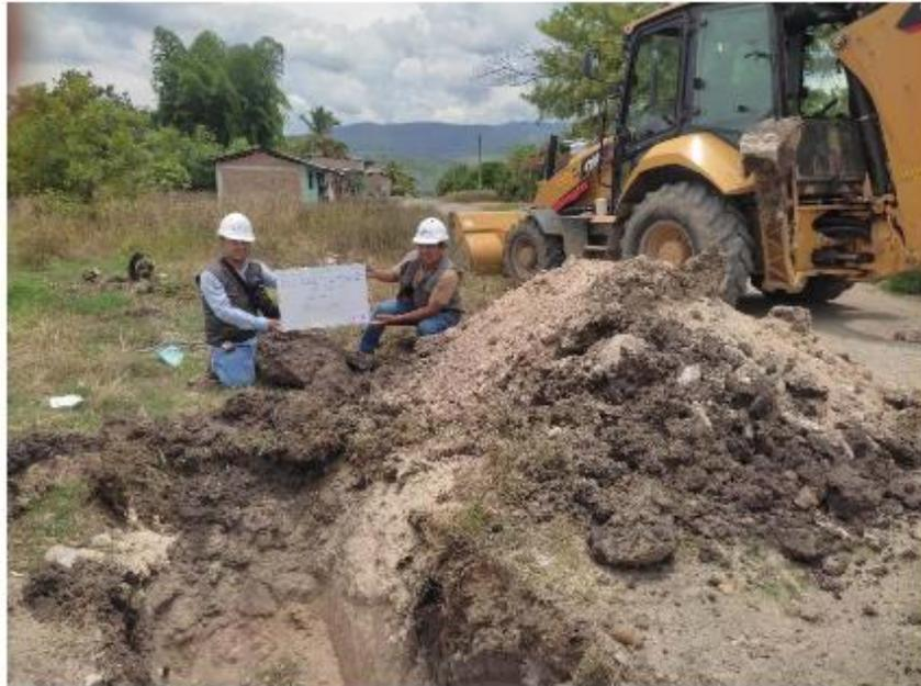
**FOTOGRAFIA 04:** Muestra la ubicación y estratigrafía de la calicata C – 04 del proyecto: "Diseño De Infraestructura Vial Urbana Para La Transitabilidad Vehicular Y Peatonal Del Centro Poblado San Agustín, Bellavista, Jaén, Cajamarca".
