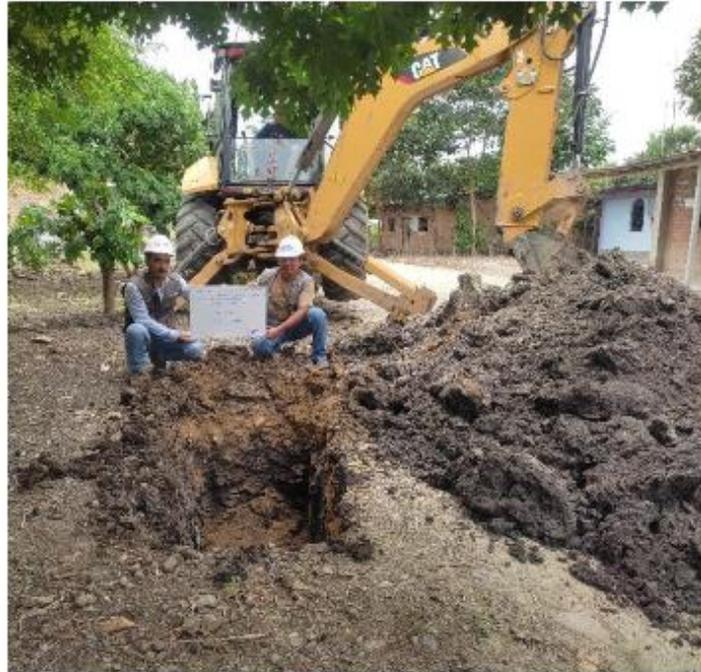
**FOTOGRAFIA 02:** Muestra la ubicación y estratigrafía de la calicata C – 02 del proyecto: "Diseño De Infraestructura Vial Urbana Para La Transitabilidad Vehicular Y Peatonal Del Centro Poblado San Agustín, Bellavista, Jaén, Cajamarca".
