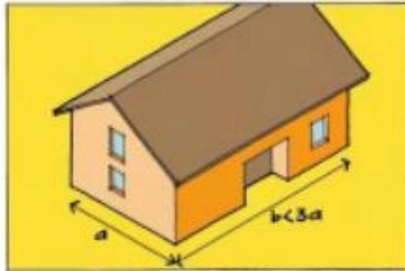
Figura 3 Vulnerabilidad baja - Irregularidad en Planta
