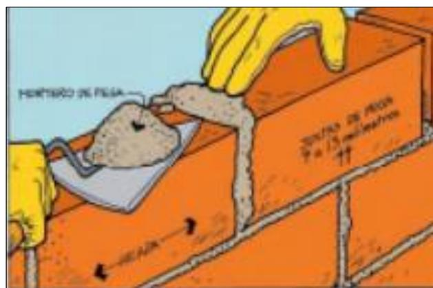
Figura 5 Vulnerabilidad baja – calidad de las juntas
