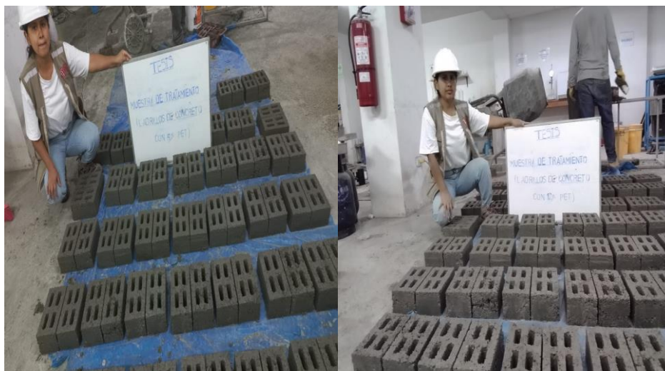
Figura 25: Secado de las unidades de albañilería con 9% y 12% de PET.
