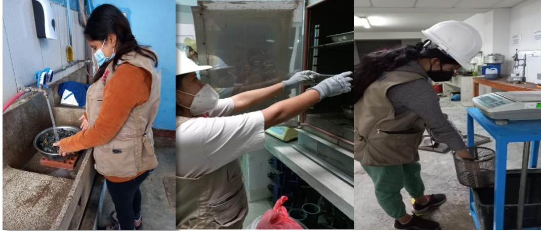
Figura 4: Gravedad específica del agregado grueso, lavado de la muestra, sumergido de muestra y el secado en horno
