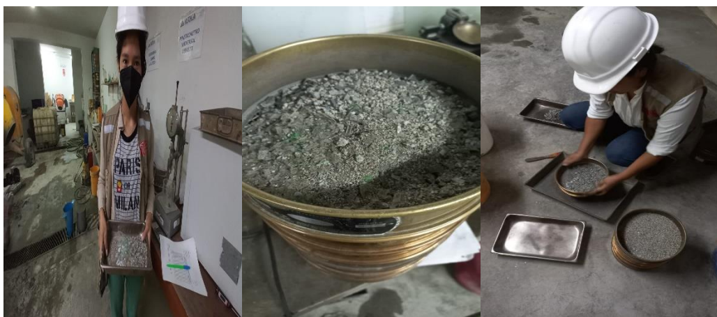
Figura 12: Granulometría del agregado global con 0%, 3%, 9% y 12% de PET
