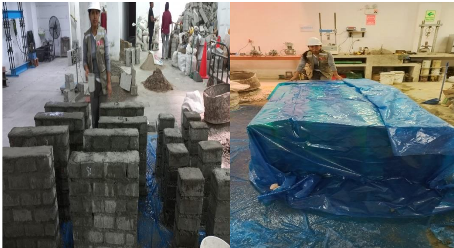
Figura 33: Curado de las pilas y muretes
