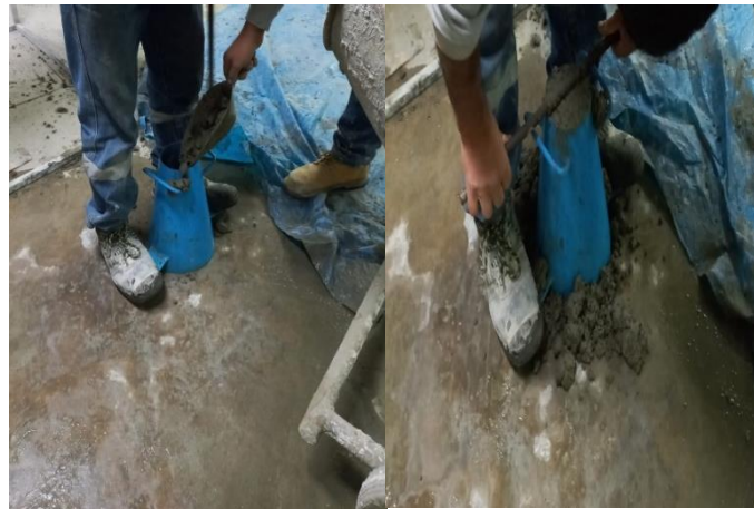
Figura 17: Ensayo al concreto, prueba de Slump
