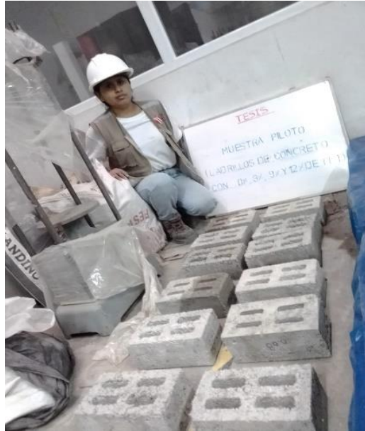
Figura 22: Secado de las unidades de albañilería prueba piloto 0%, 3%, 9% y 12% de PET
