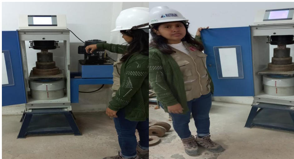
Figura 23: Ensayo de la resistencia a compresión del mortero Tipo P1 (1:3)
