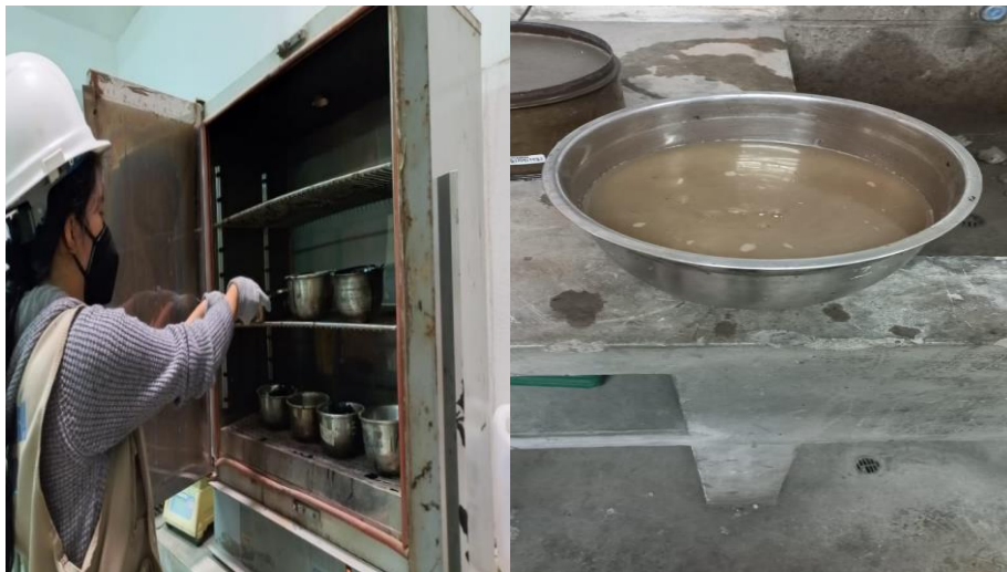
Figura 6: Gravedad específica del agregado fino, exposición al aire libre y secado al horno
