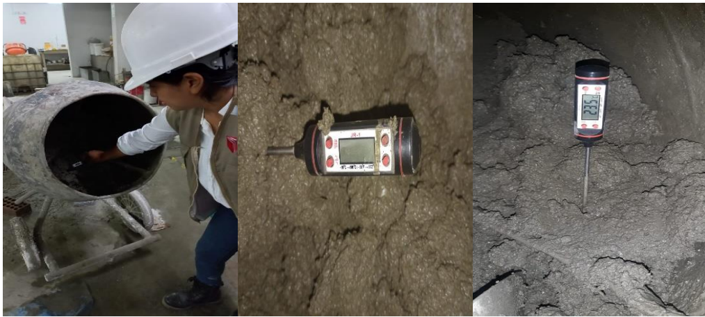
Figura 20: Calculando la temperatura del concreto
