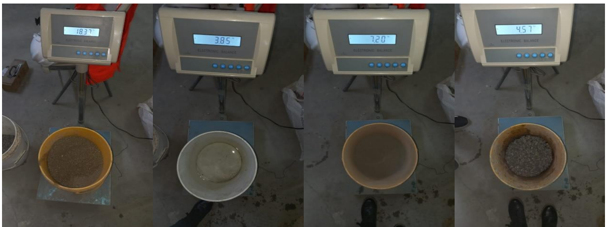
Figura 14: Proporciones de las unidades de albañilería prueba piloto con 0%, 3%, 9% y 12% de PET, pesaje de los materiales.
