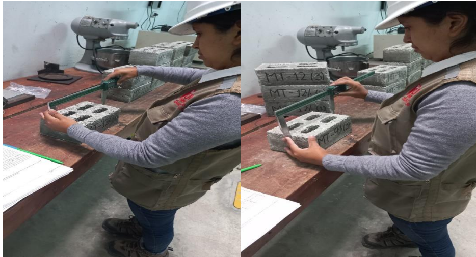
Figura 29: Ensayo de la variación dimensional de los 4 diseños
