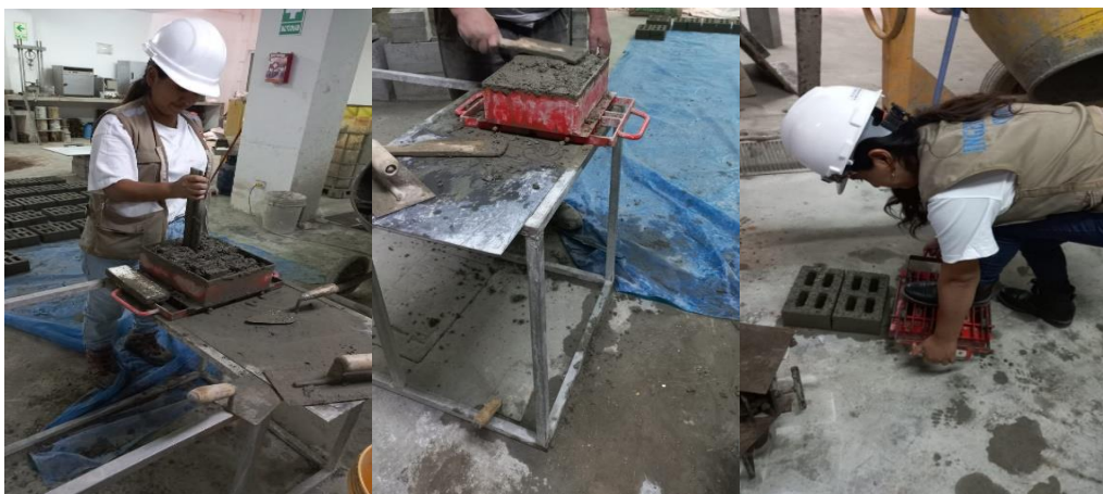
Figura 21: Desmoldaje de ladrillos.
