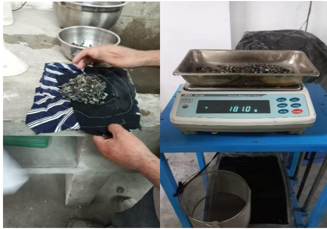
Figura 4: Gravedad específica del agregado grueso, lavado de la muestra, sumergido de muestra y el secado en horno
