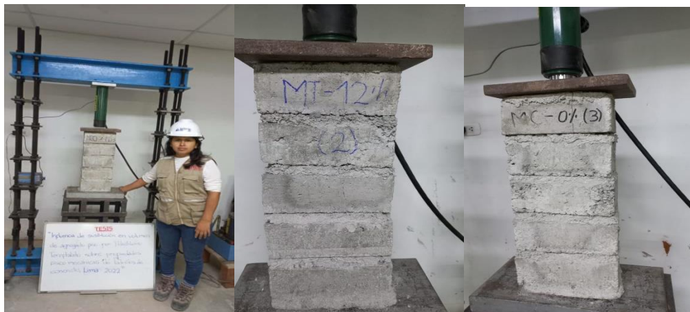
Figura 34: Ensayo de la compresión axial en pilas a los 28 días
