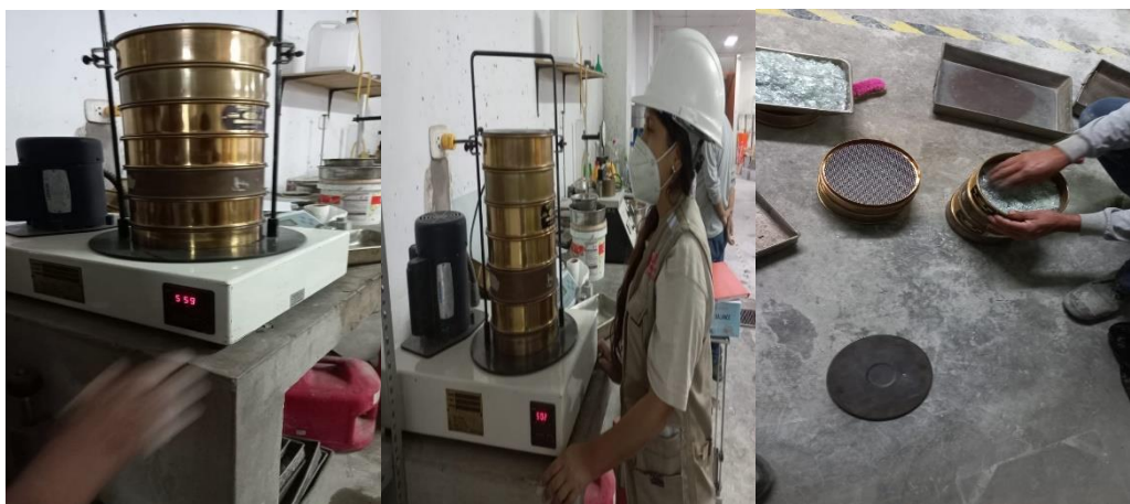
Figura 9: Granulometría de los agregados y PET, tamizado de muestras.
