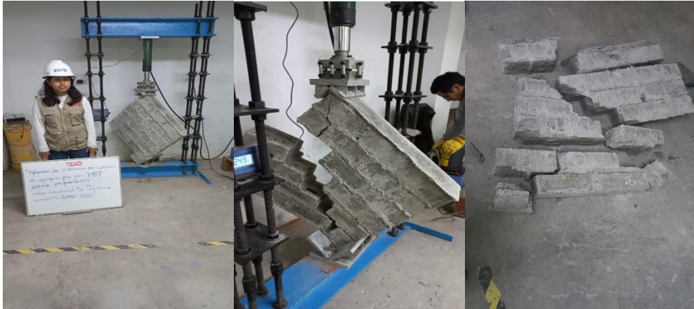
Figura 35: Ensayo de la resistencia a la compresión diagonal en muretes a los 28 días
