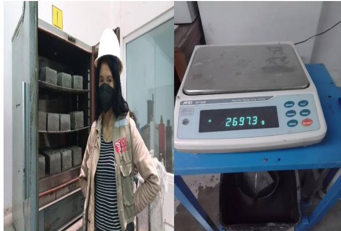
Figura 30: Ensayo de absorción y densidad de los 4 diseños
