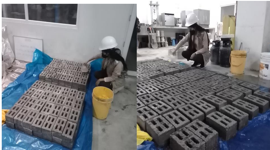
Figura 27: Segundo día de curado de las unidades de albañilería con 0%,3%,9% y 12% de PET
