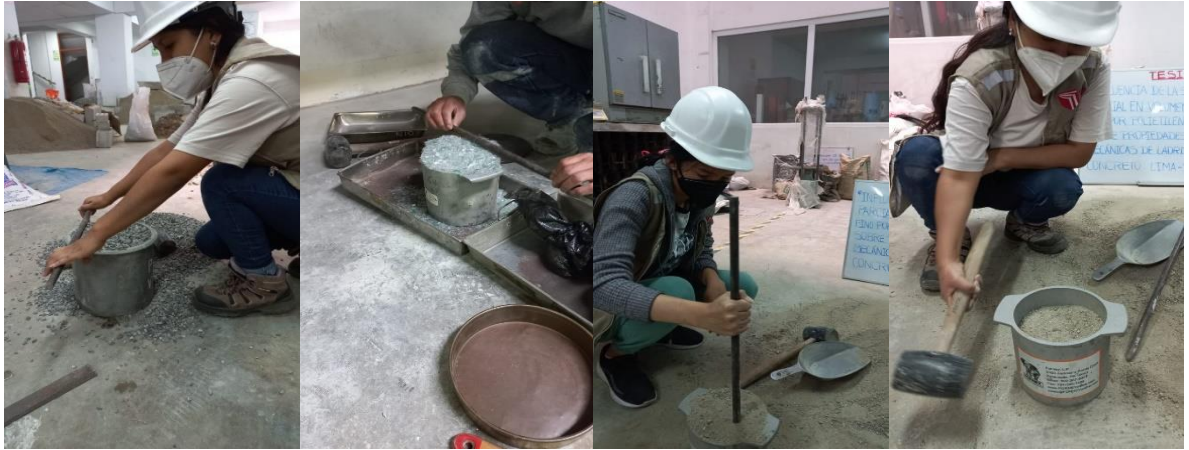
Figura 10: Peso unitario compactado del agregado grueso, fino y PET
