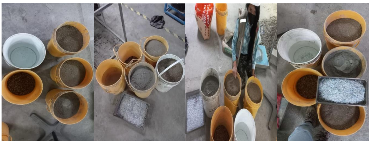
Figura 15: Proporciones de las unidades de albañilería con 0%, 3%, 9% y 12% de PET
