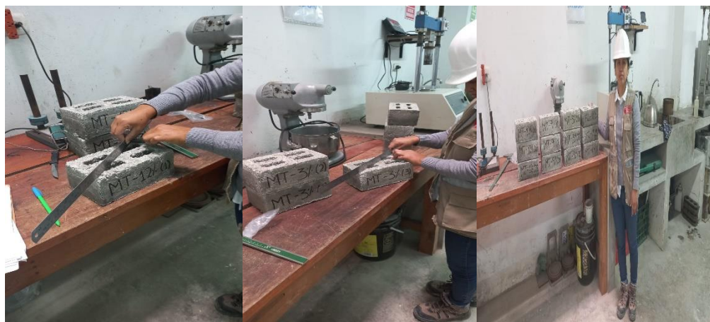
Figura 28: Ensayo del alabeo de los 4 diseños
