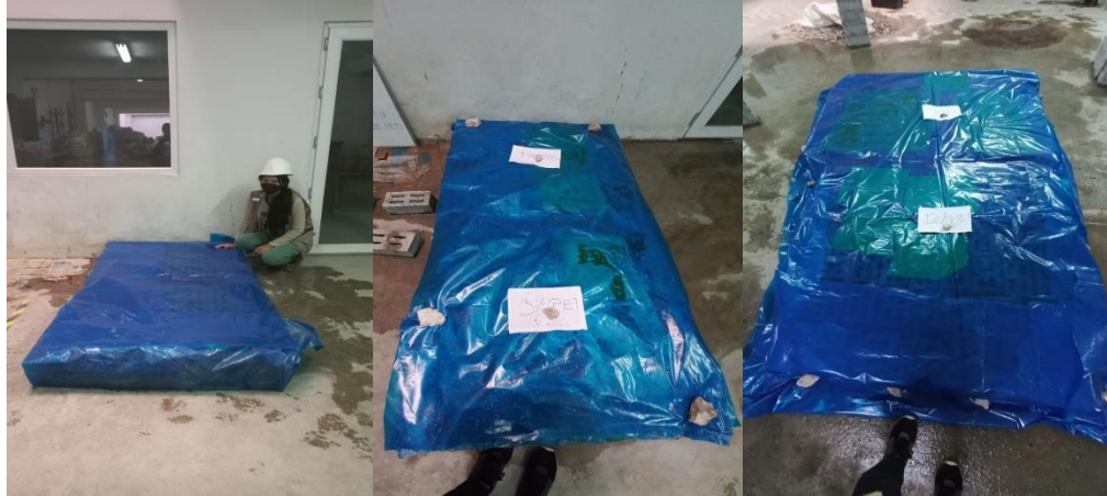
Figura 26: Primer día de curado de las unidades de albañilería de 0,3,9 y 12% con PET.
