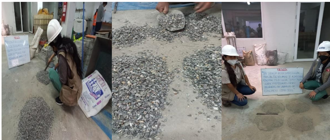
Figura 3: Cuarteo de muestras del agregado grueso y fino
