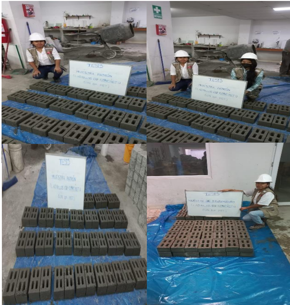
Figura 24: Secado de las unidades de albañilería con 0% y 3% de PET.
