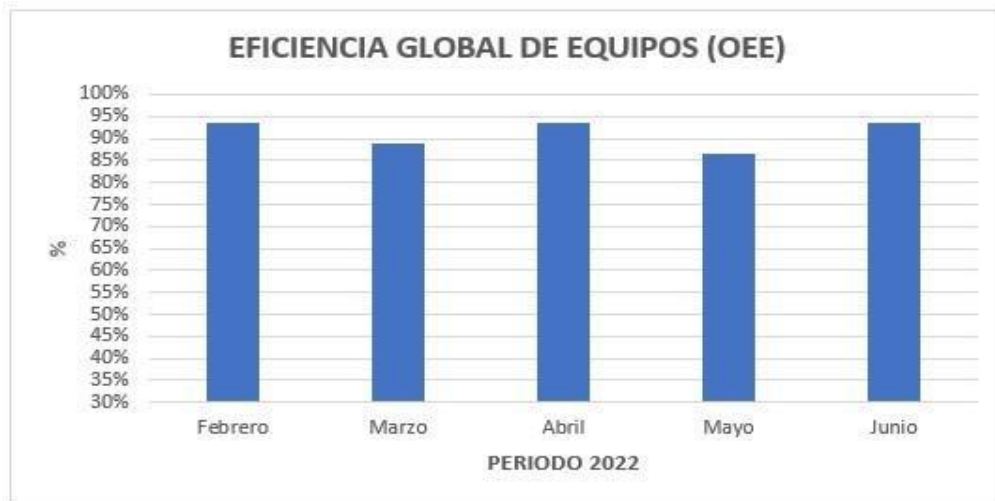
Figura 22. Eficiencia global de equipos – después.
