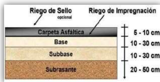
Figura 1: Corte de sección transversal.
