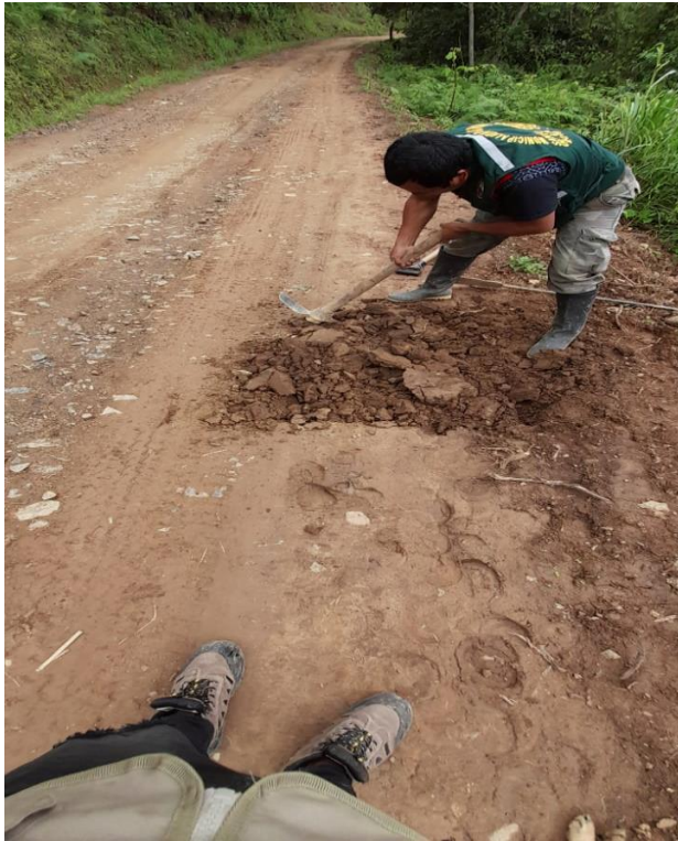
Figura 38: Comienzo de excavación de calicata n° 2
