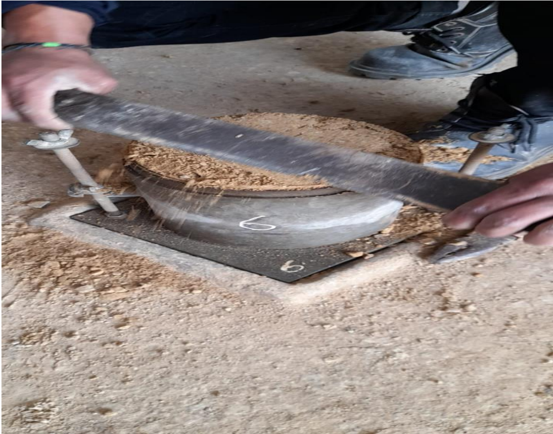
Figura 55: Enrazado de muestra
