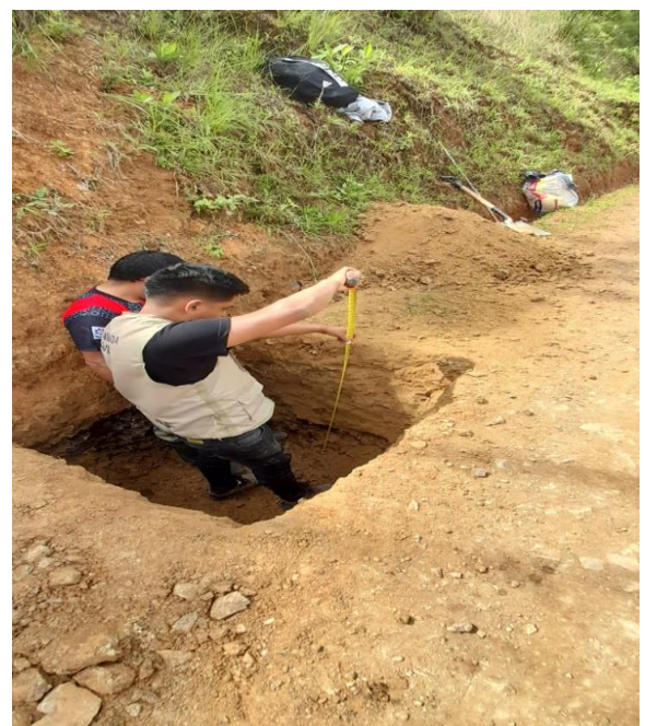
Figura 43: Profundidad de la calicata nº 1 de 1.50 m
