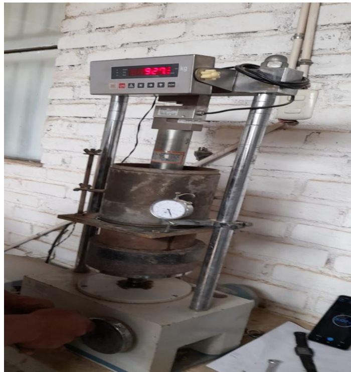
Figura 56: Prensa de carga de CBR
