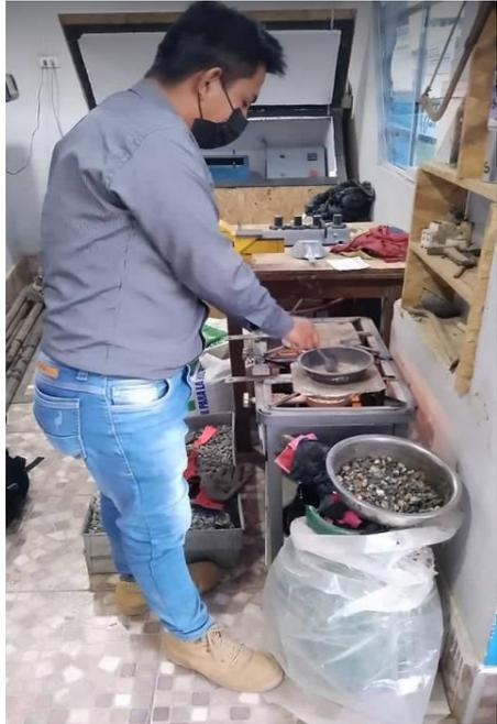
**ILUSTRACIÓN 40: ENSAYO DE CONTENIDO DE HUMEDAD**
