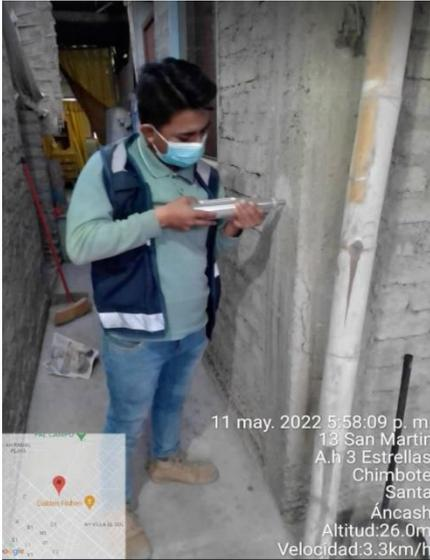
**ILUSTRACIÓN 42: ENSAYO DE ESCLEROMETRIA – VIVIENDA N°01**
