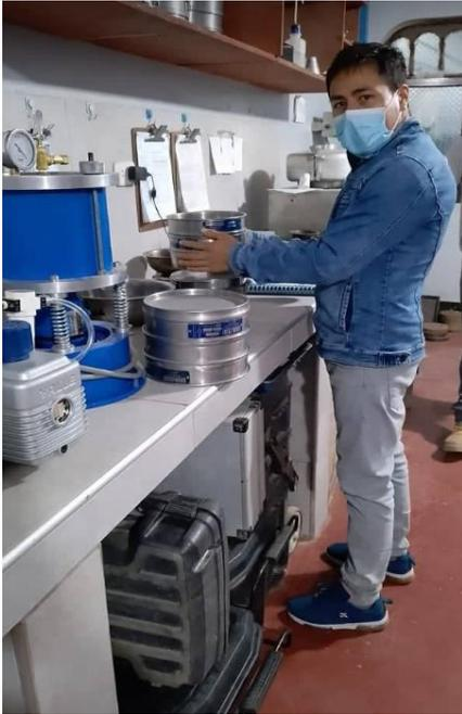
**ILUSTRACIÓN 39: ENSAYO DE GRANULOMETRIA**
