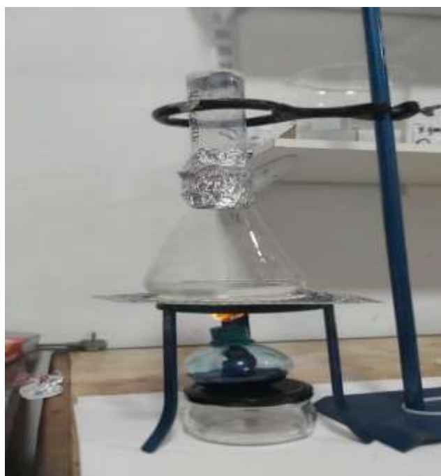
Figura 6: Calentando el glutaraldehido para que se infiltre en el grafeno
