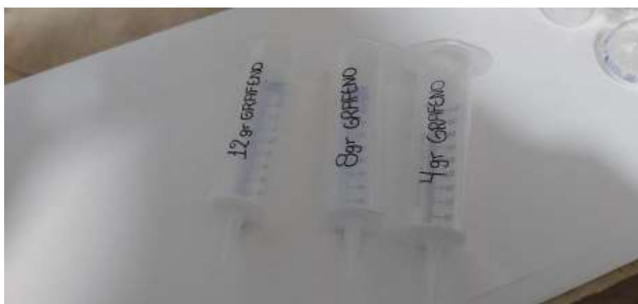
Figura 20: Jeringas de 100 mL que serán utilizadas como filtro etiquetadas con 3 diferentes cantidades de membrana Fuente: Imagen propia
