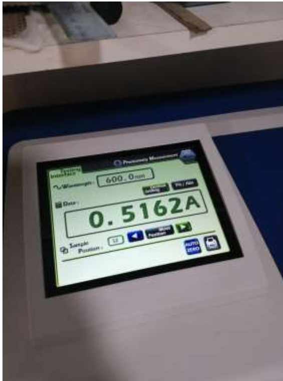
Figura 24: Obteniendo resultados del sulfato de cobre a través del espectrofotómetro aplicando la curva de calibración Fuente: Imágenes propias
