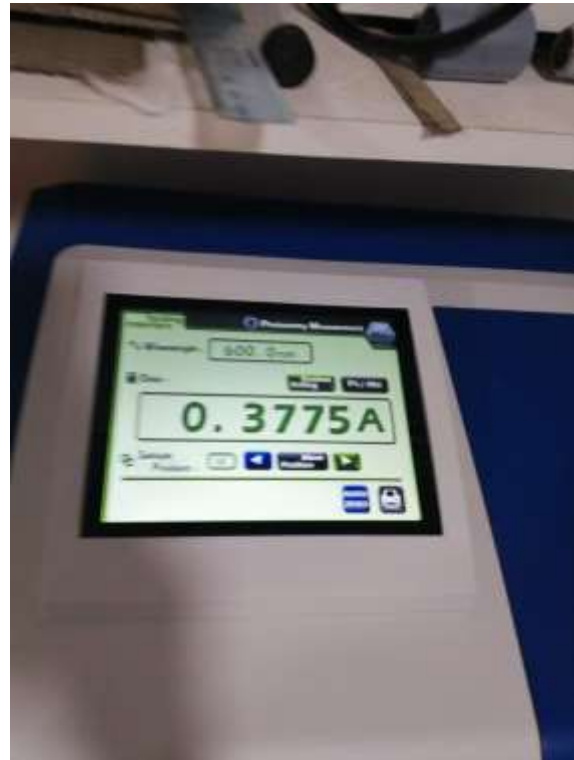
Figura 24: Obteniendo resultados del sulfato de cobre a través del espectrofotómetro aplicando la curva de calibración Fuente: Imágenes propias
