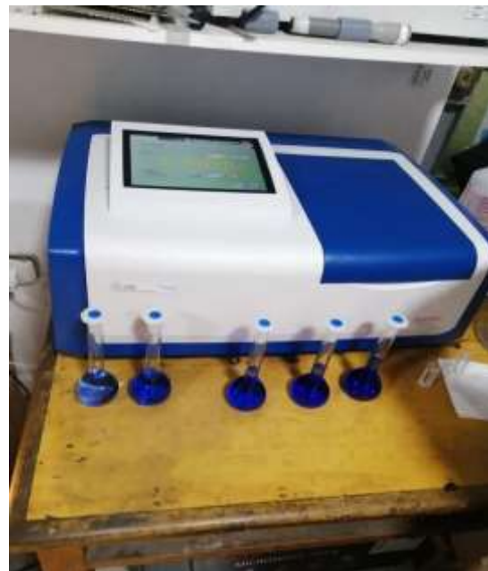
Figura 23: Elaborando la curva de calibración para el sulfato de cobre (Cu II) Fuente: Imágenes propias
