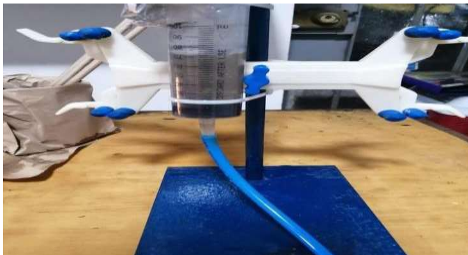
Figura 8: Iniciando el tratamiento de las aguas con el filtro de grafeno
