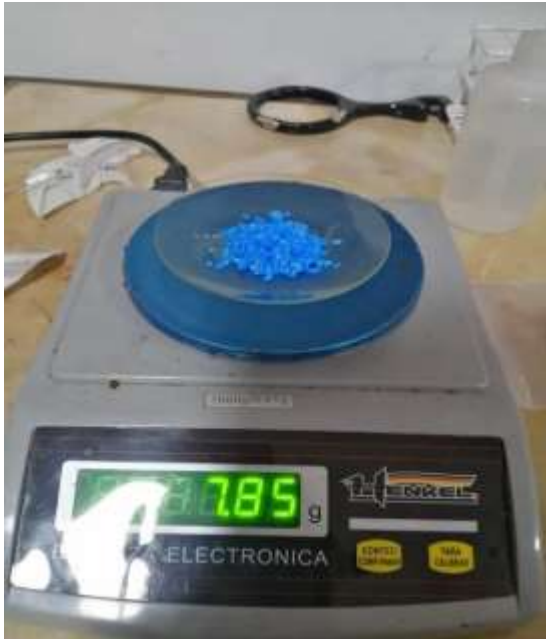
Figura 23: Elaborando la curva de calibración para el sulfato de cobre (Cu II) Fuente: Imágenes propias
