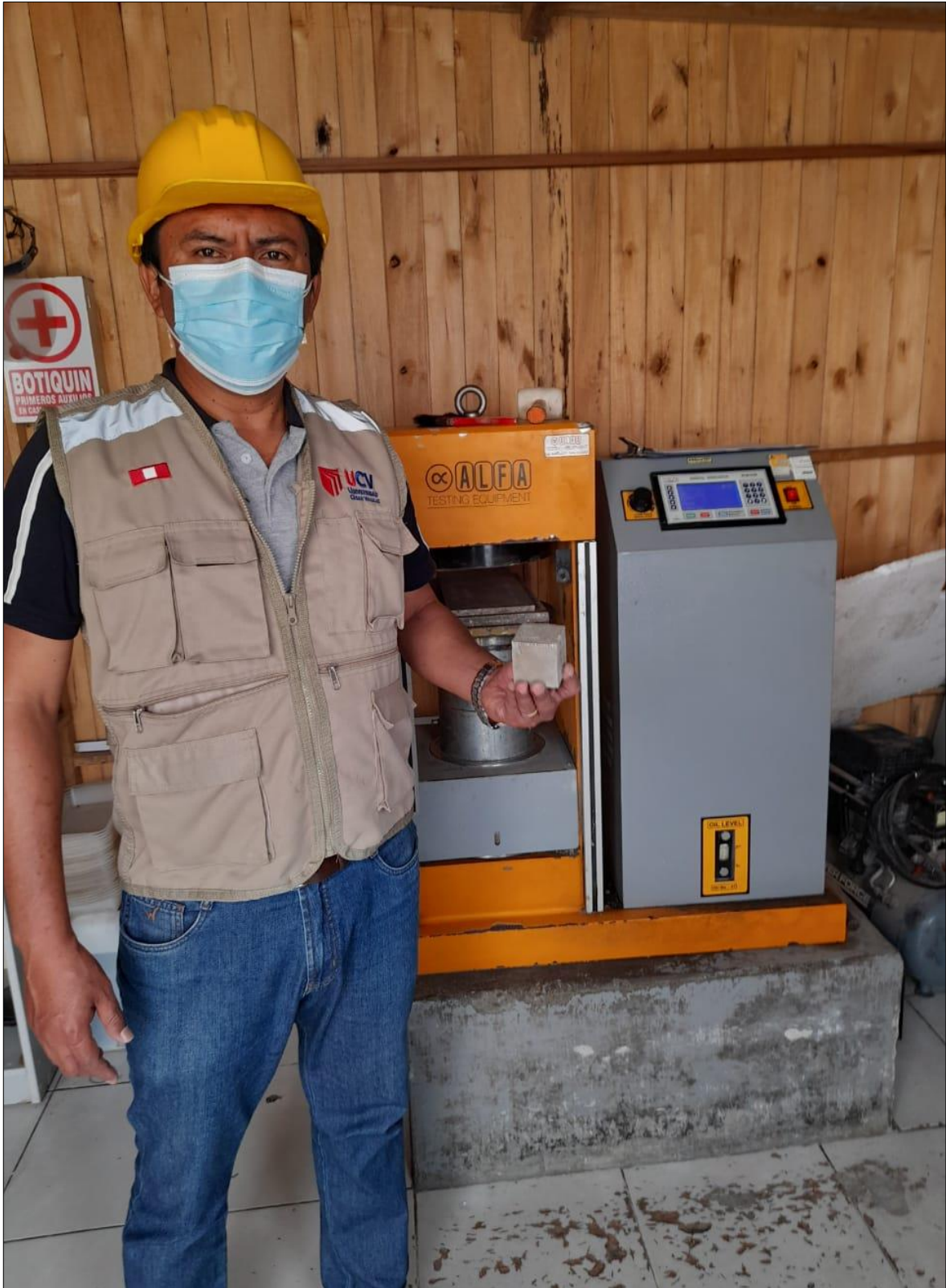
Cubo de mortero rapimix de 5 cm de lado
