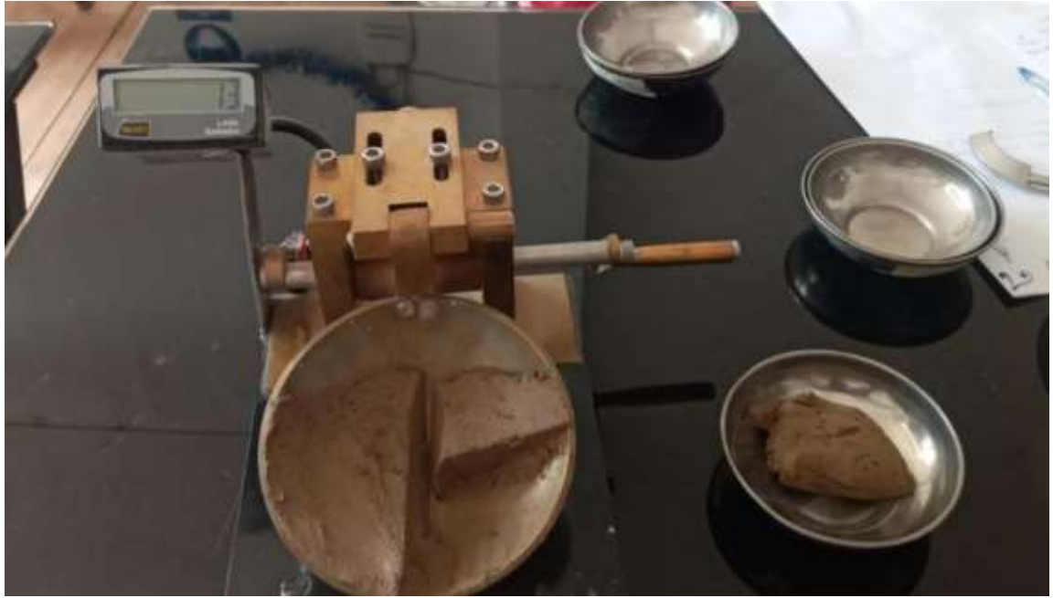
FOTOGRAFÍA N°15: Parte N°02 del Ensayo de Límites de Atterberg mediante Copa Casa Grande después de los 20 golpes, por parte de los Tesistas Cubas y Quiroz.
