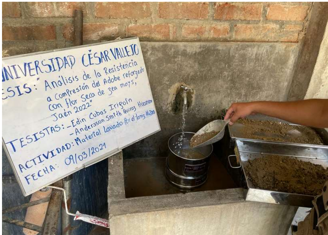
FOTOGRAFÍA N°11: Parte N°02 de Lavado de tierra por el Tamiz N°200 para su clasificación, por parte de los Tesisistas Cubas y Quiroz.
