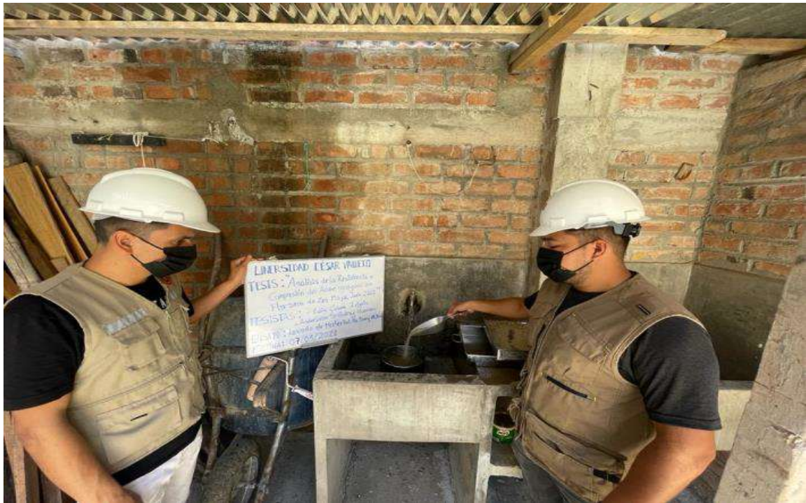
FOTOGRAFÍA N°10: Parte N°01 de Lavado de tierra por el Tamiz N°200 para su clasificación, por parte de los Tesistas Cubas y Quiroz.
