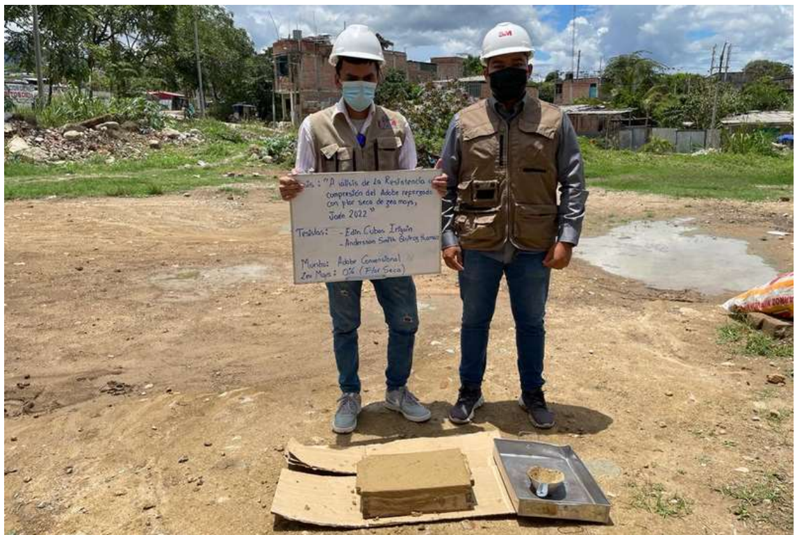
FOTOGRAFÍA N°18: Formación insitu de adobes con 0% de incorporación de flor seca Zea Mays por parte de los Tesistas Cubas y Quiroz.
