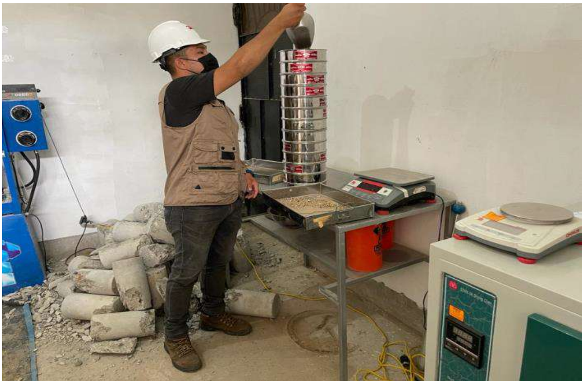
FOTOGRAFÍA N°08: Parte N°02 de Análisis Granulométrico, precedido por parte del Tesista Quiroz.
