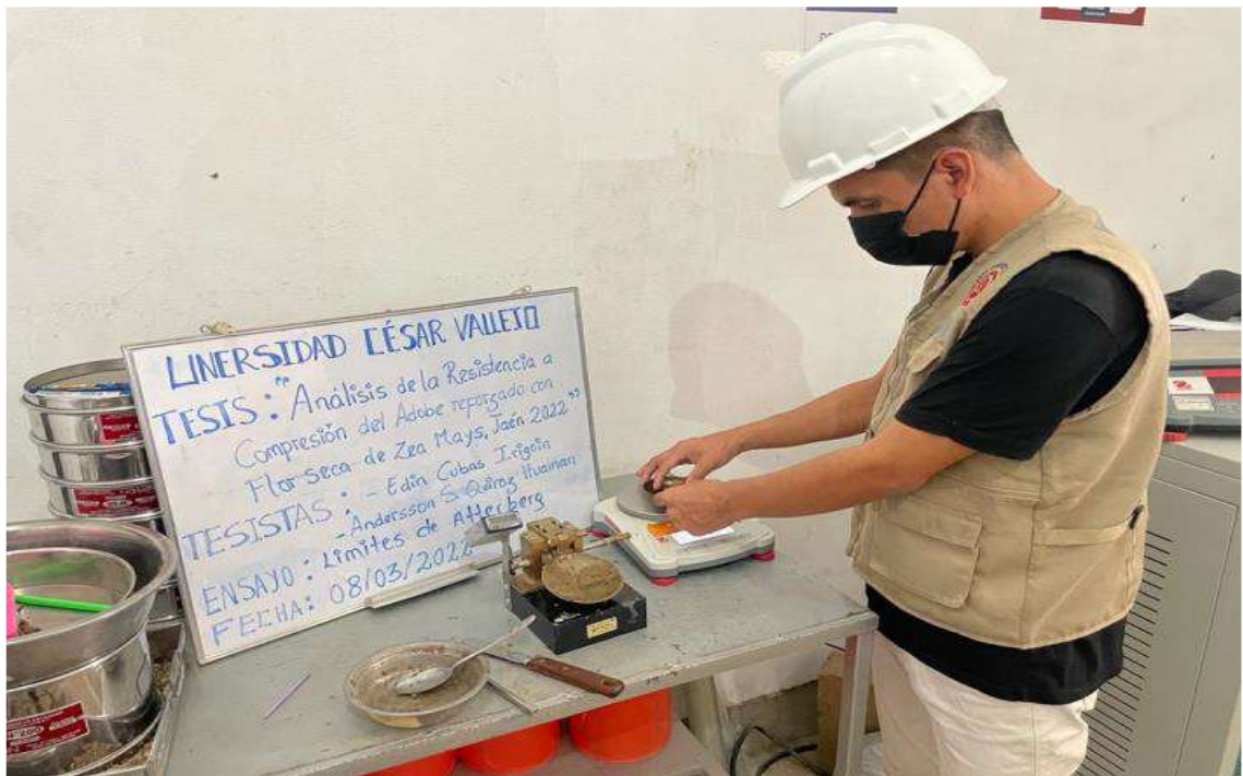
FOTOGRAFÍA N°14: Parte N°01 del Ensayo de Límites de Atterberg mediante Copa Casa Grande, por parte del Tesista Cubas.
