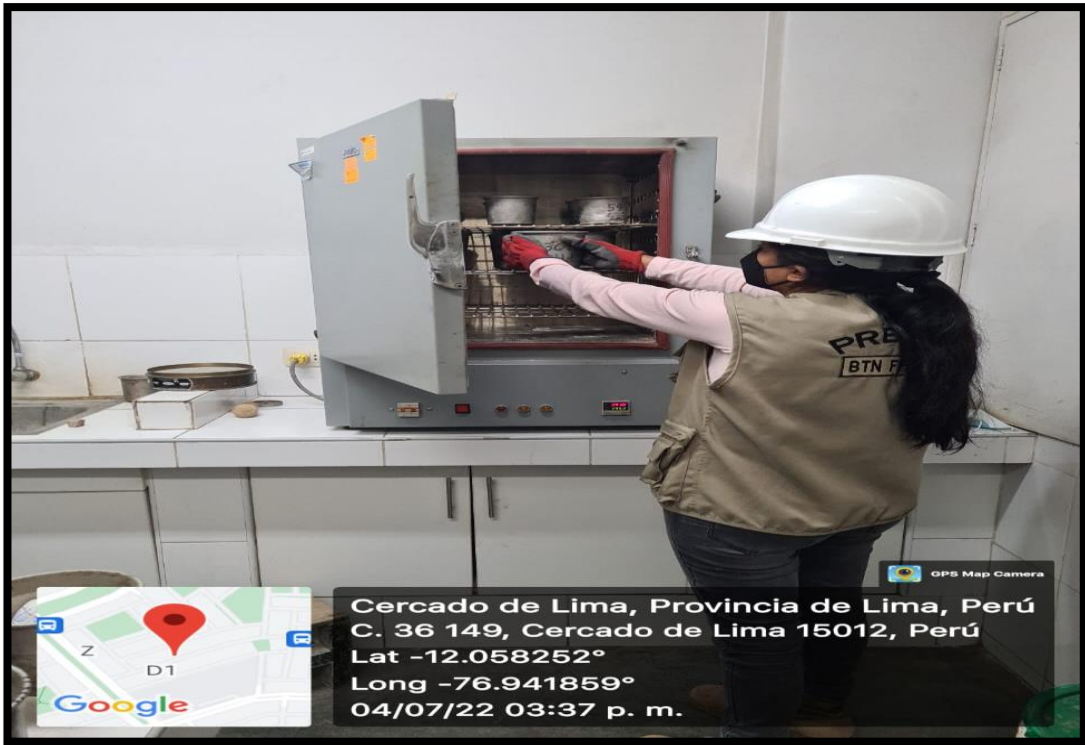
Colocación de las mezclas en el horno
