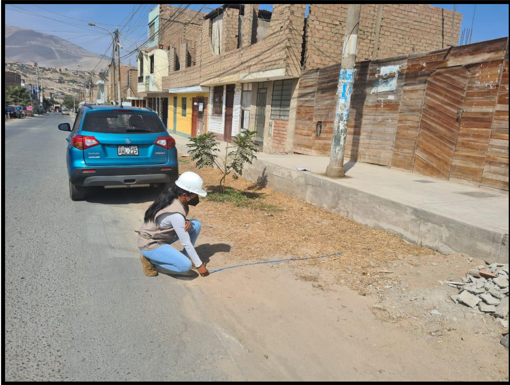
Medición de berma lateral izquierda
