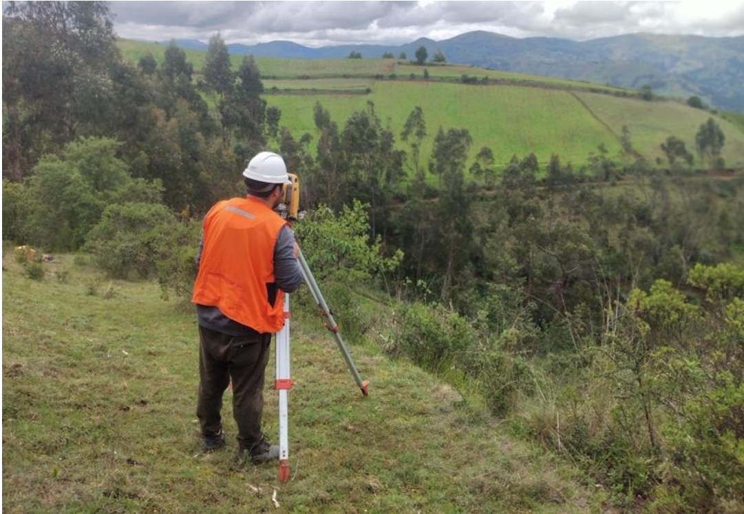
Figura 16: en la figura se muestra al tesista observando a los primeros para registrar los puntos topográficos
