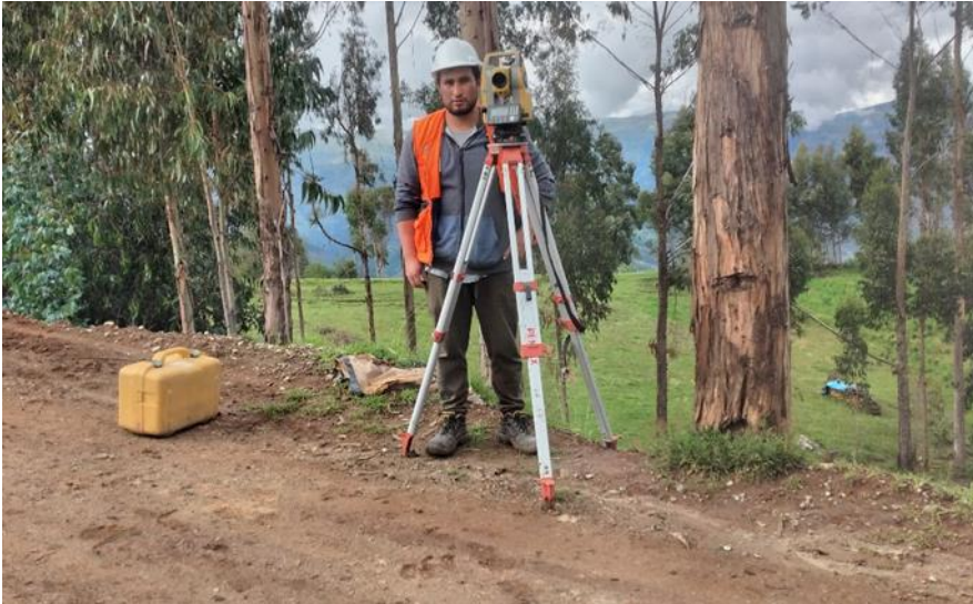
Figura 12: el tesista estacionando la estación total para dar inicio al levantamiento topográfico
