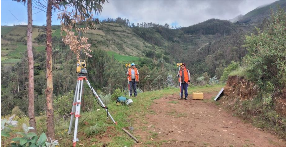
Figura 14: en la figura se muestra a los prismeros dando los puntos de carretera que existe su plataforma, en 300 metros
