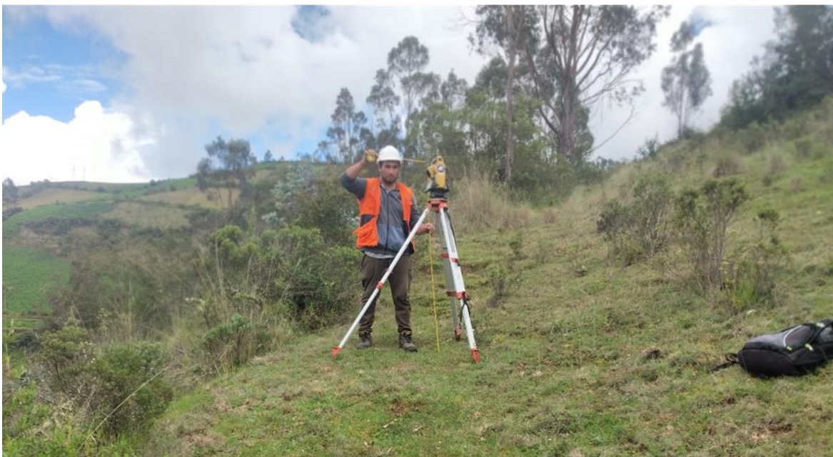
Figura 15: en la figura se muestra al tesista haciendo el cambio de estación para continuar con el levantamiento topográfico del tramo sin plataforma
