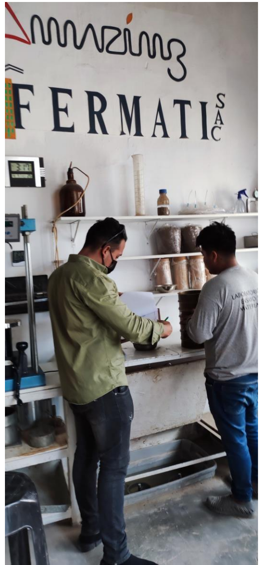
Ensayo cuchara Casagrande, para encontrar Plasticidad del suelo / coordinaciones con laboratorista sobre la data anotada
