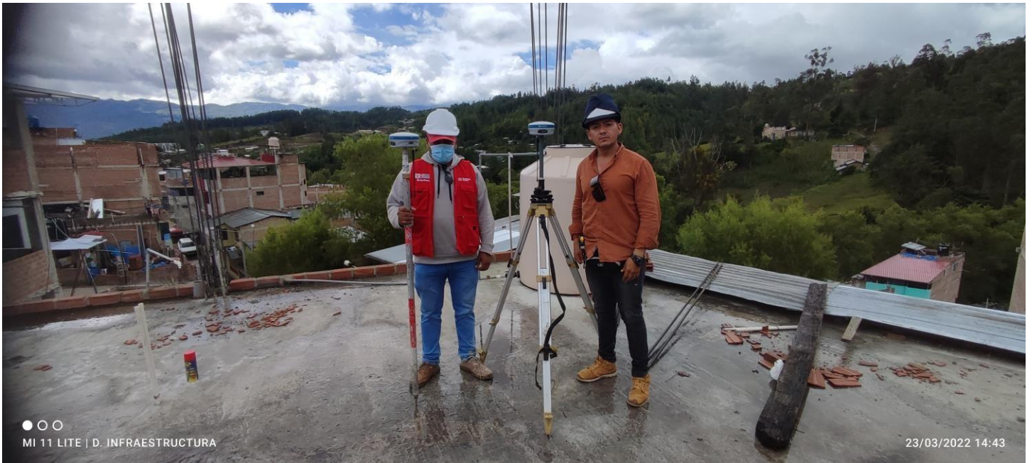
Estacionamiento de equipo topográfico Rover, edificio 4 niveles para facilidad de conexión satelital con GPS Diferencial
