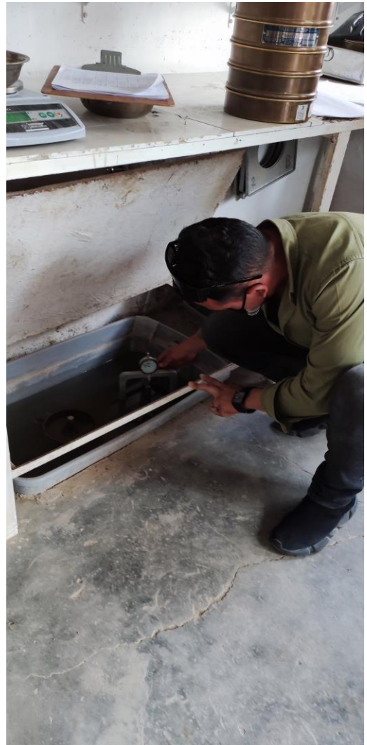
Anotaciones, y verificación de muestras sumergidas para ensayo de CBR
