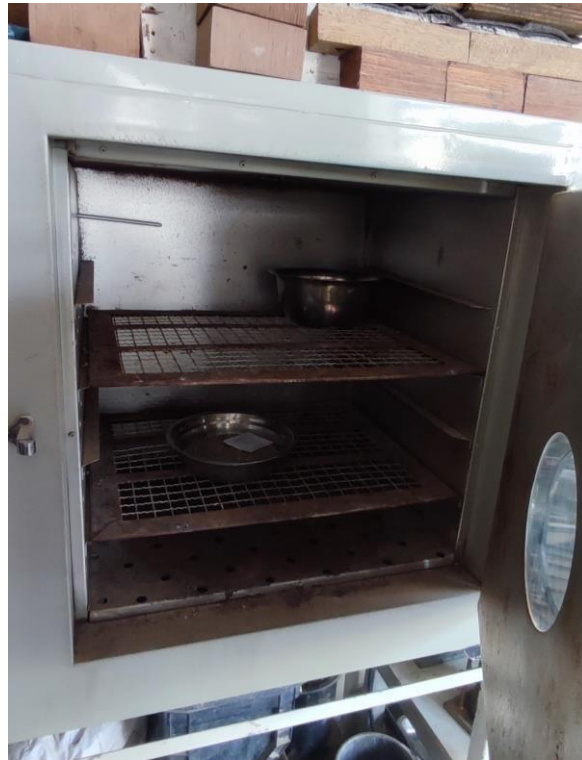
Horno con muestras secas, listas para pesaje y anotación de resultados
