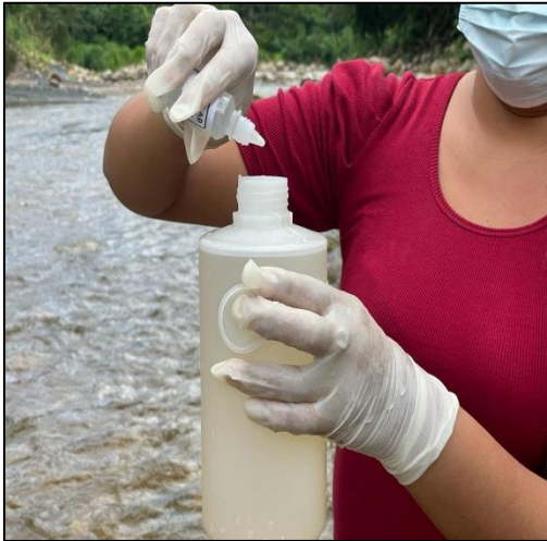
Toma de muestra del parámetro DQO agregando 10 gotas de H_2SO_4
