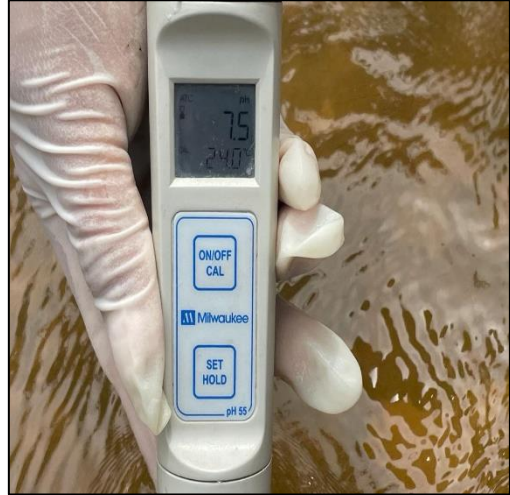
Toma de muestra de pH y temperatura
