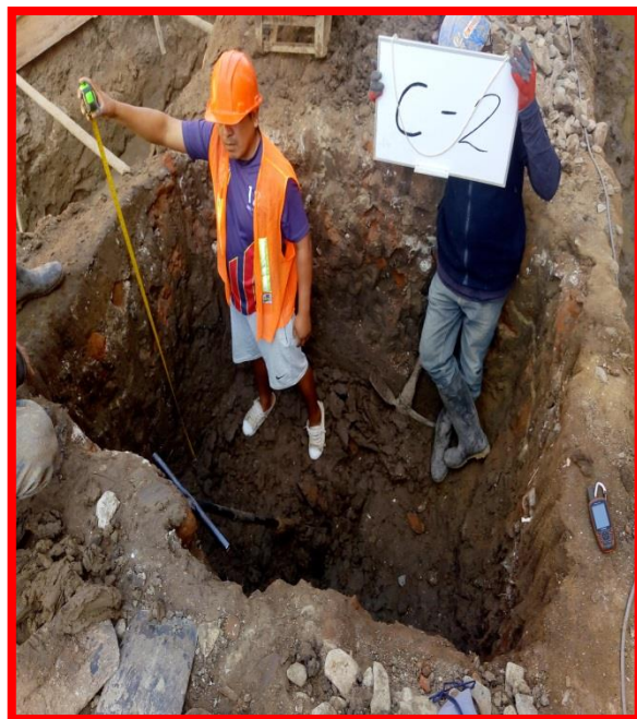
Foto 6. Detalle y registro del perfil del suelo en calicata C-2.
