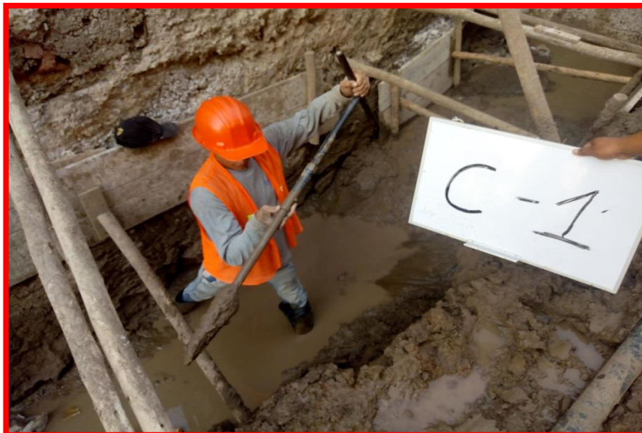
Foto 2. Muestreo complementario con posteadora en calicata C-1
