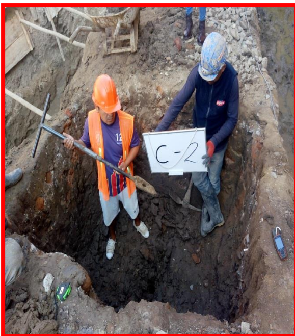
Foto 5. Muestreo complementario con posteadora en calicata C-2.
