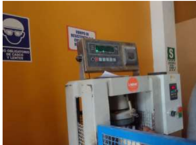
FOTOGRAFIA 04: Se Muestra La ejecución del ensayo de resistencia a la compresión De El Núcleo De Diamantina (D1), de la platea para la tesis: “Diseño estructural del Edificio Administrativo del Colegio de Biólogos con disipadores de energía para el control de asentamientos, Lambayeque 2022”
