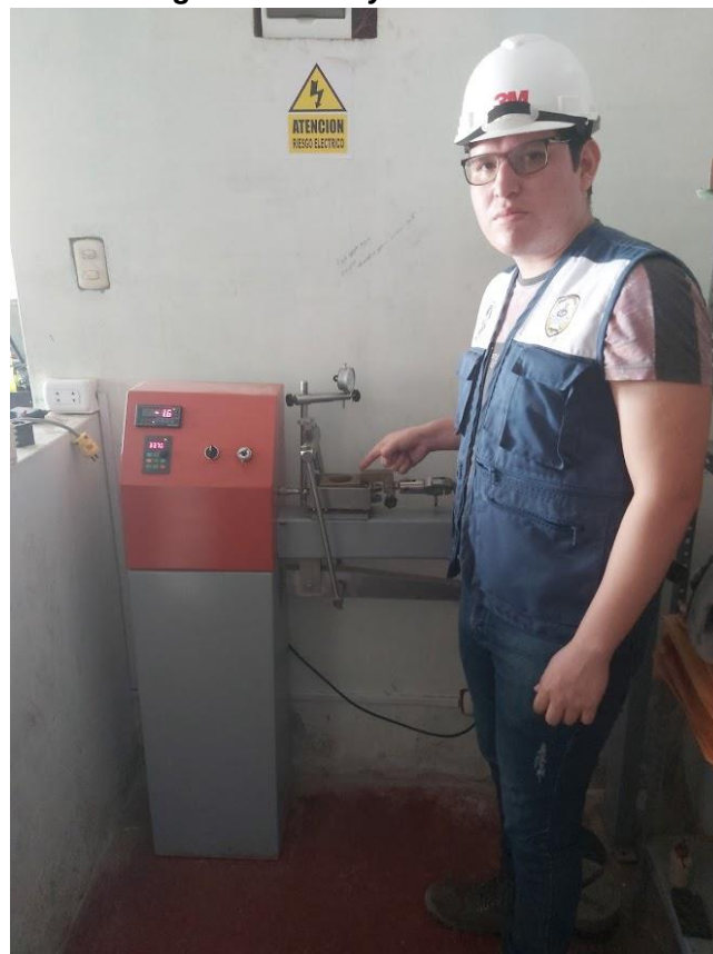
Fotografía 8: Ensayo de Corte Directo
