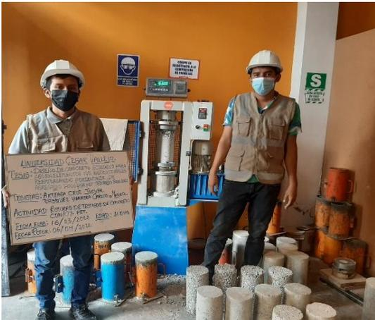
**Figura 44.** Ensayo de resistencia a la compresión del concreto con 15% de PET a los 3 días
