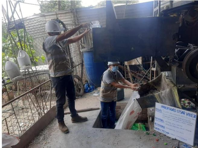
**Figura 31. Obtención del PET triturado**
