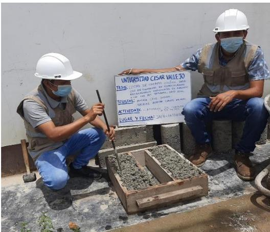
**Figura 36.** *Elaboración de testigos de concreto con 15% de PET*
