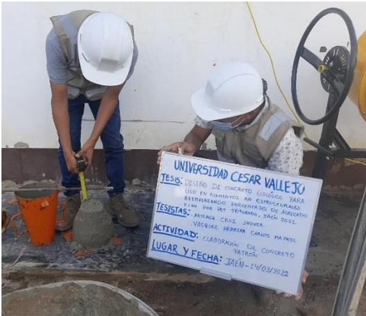
**Figura 38.** Ensayo de peso unitario con 10% de PET
