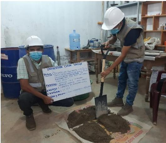
**Figura 26. Peso Unitario compactado del agregado fino**
