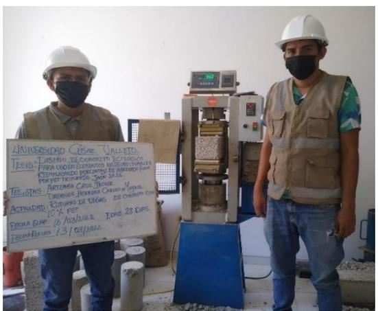
**Figura 48.** Ensayo de resistencia a la flexión del concreto con 15% de PET a los 28 días
