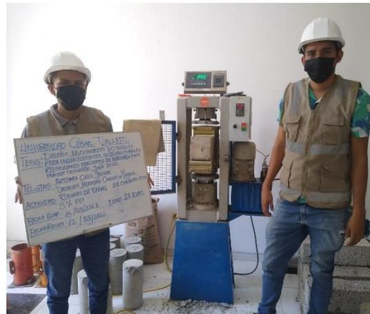
**Figura 47.** Ensayo de resistencia a la flexión del concreto con 10% de PET a los 28 días
