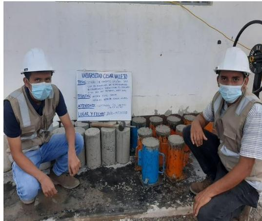
**Figura 35.** *Elaboración de testigos de concreto con 10% de PET*
