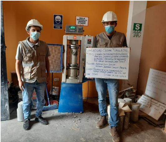
**Figura 42.** Ensayo de resistencia a la compresión del concreto con 5% de PET a los 21 días
