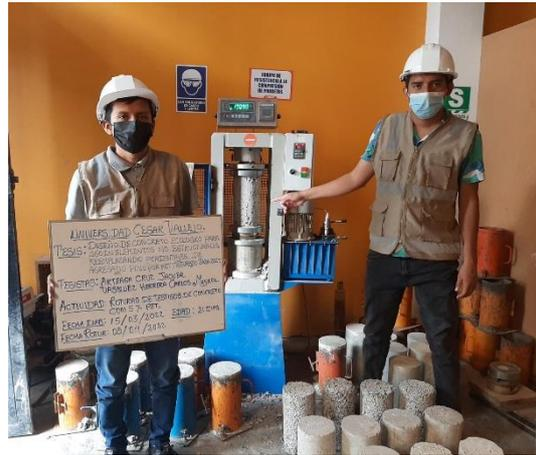
**Figura 43.** Ensayo de resistencia a la compresión del concreto con 10% de PET a los 21 días
