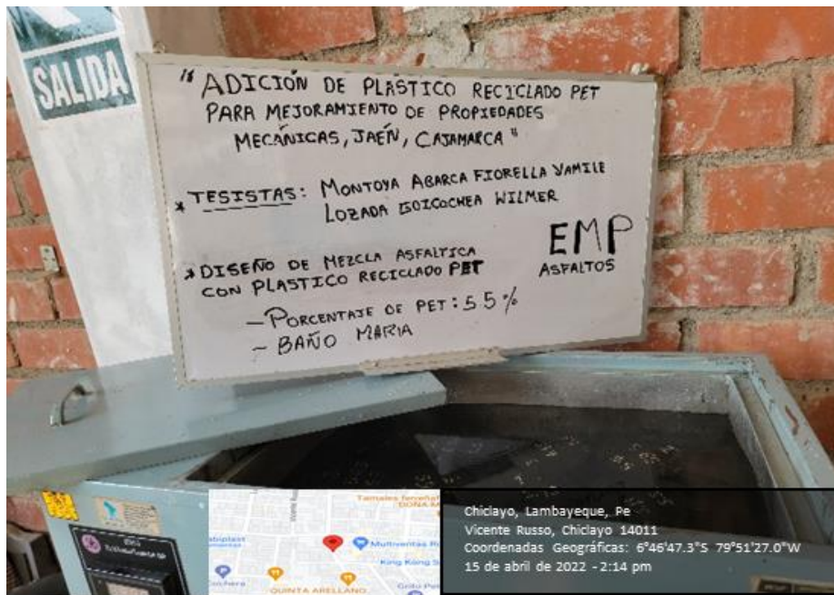
Foto N° 24: Baño maría de briquetas con el 5.5% de Pet.
