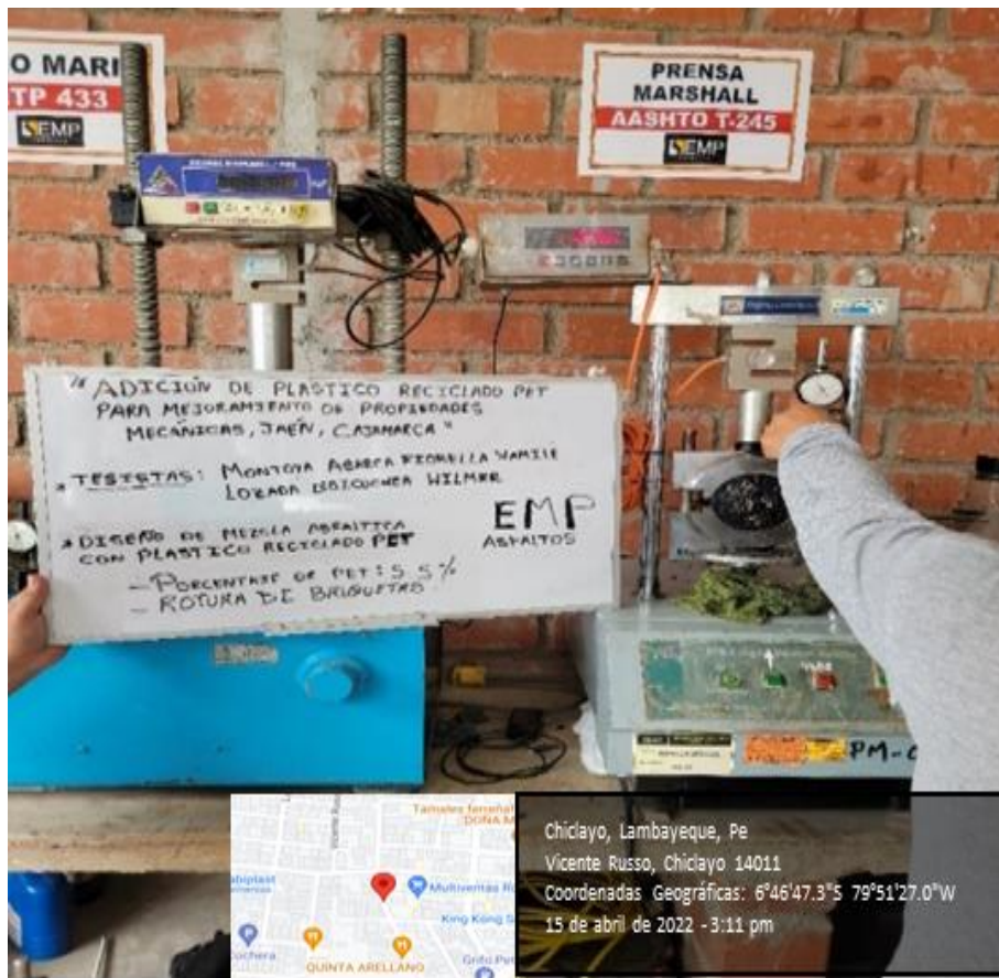
Foto N° 25: Ensayo de briquetas modificada con el 5.5% de Pet en la prensa Marshall.
