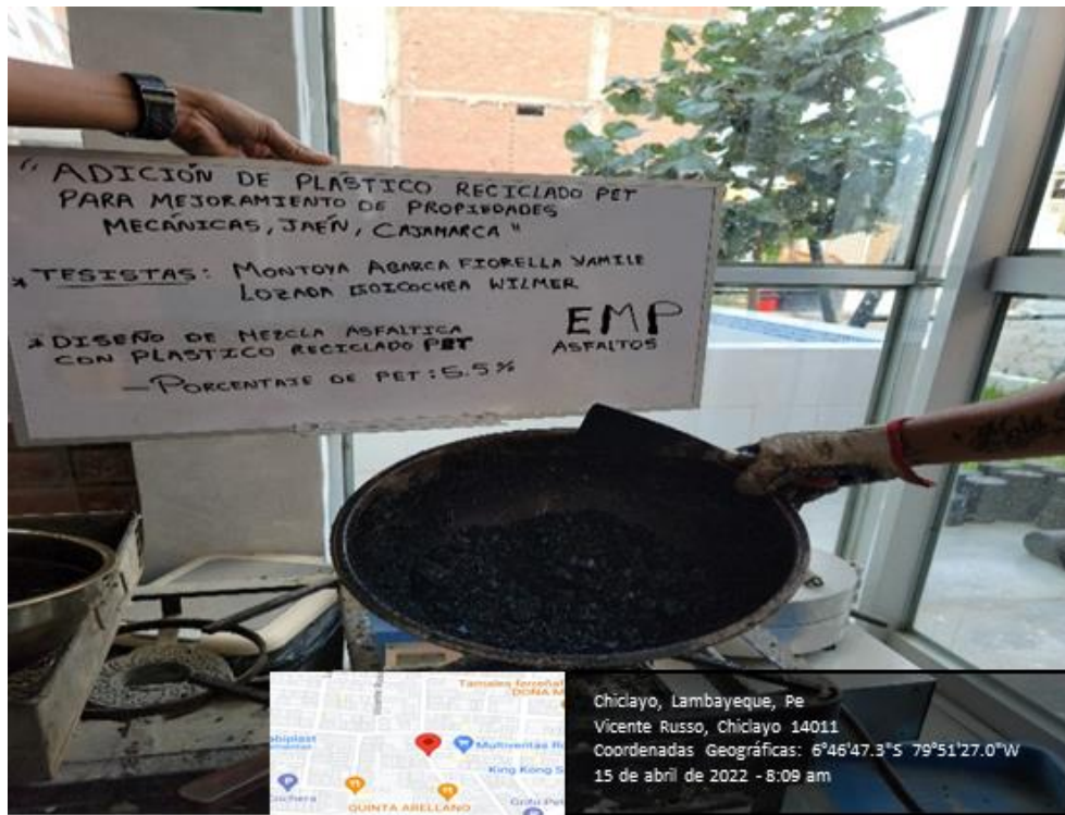
Foto N° 22: Combinación de agregados para mezcla asfáltica con el 5.5% de Pet.
