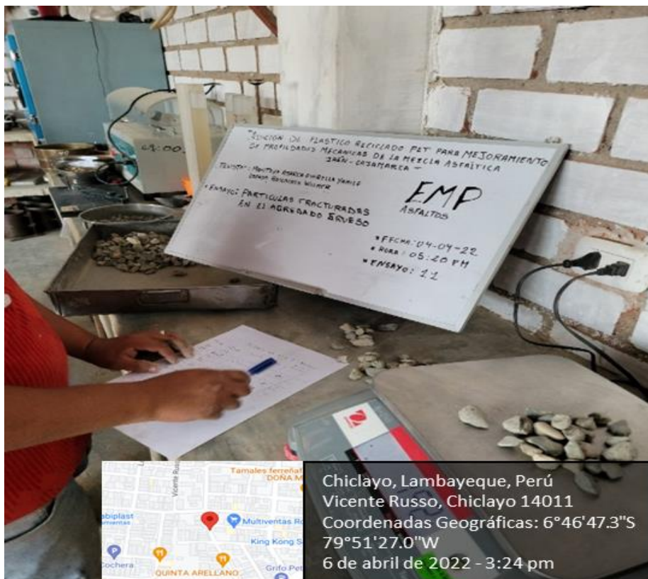
Foto N° 8: Partículas fracturadas en el agregado grueso.
