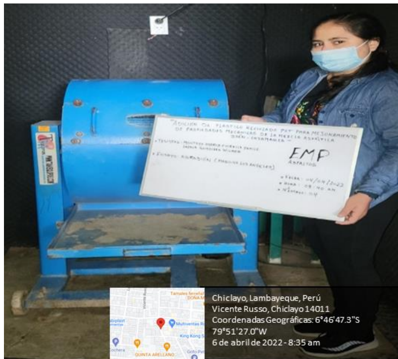
Foto N° 7: Ensayo de abrasión (Maquina de los ángeles).
