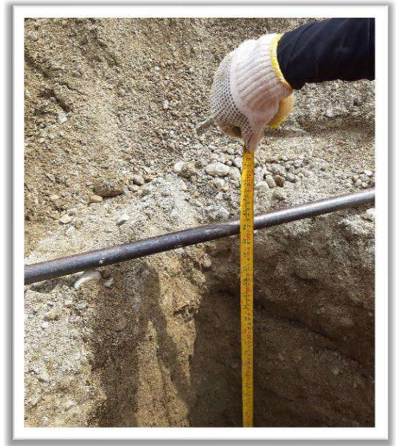
Figura N°15: CALICATA EN KM 7+000, Remarcado, Excavación y medición.
