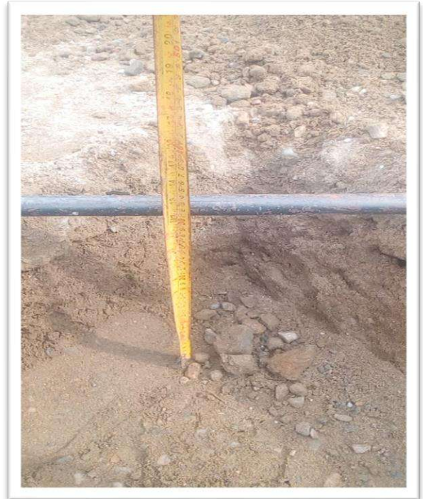
Figura N°13: CALICATA EN KM 6+000, Remarcado, Excavación a 0.30 cm del cascajo.
