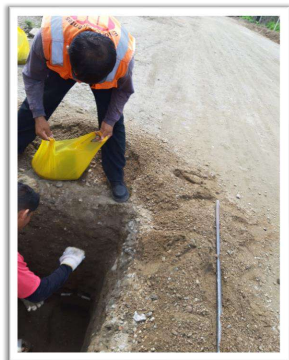
Figura N°08: CALICATA EN KM 3+500, Remarcado y Extracción del sustrato
