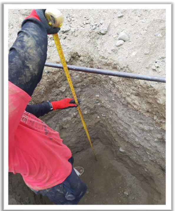
Figura N°10: CALICATA EN KM 4+500, Remarcado, Excavación y medición.
