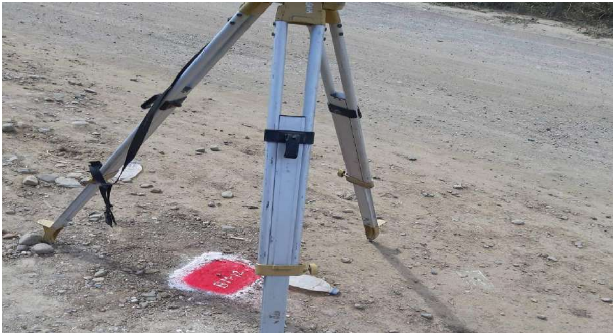
Figura N°12: BM-12, NORTE: 9346427.47, ESTE: 631380.234, ELEVACIÓN: 124.25.
