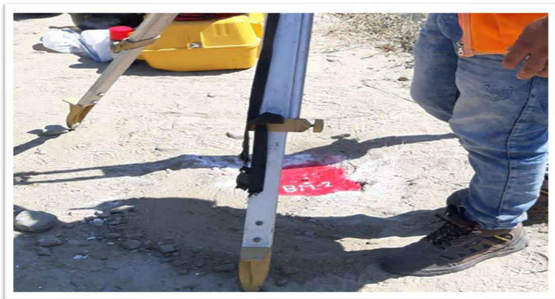
Figura N°02: BM-02, NORTE: 9344399.41, ESTE: 636478.154, ELEVACIÓN: 142.158.
