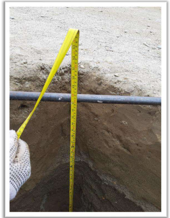
Figura N°05: CALICATA EN KM 2+000, Remarcado, Excavación y medición.
