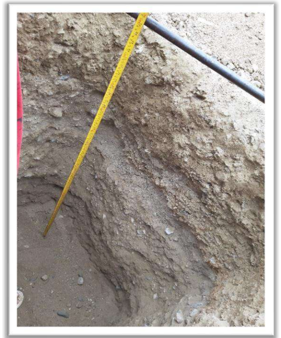
Figura N°16: CALICATA EN KM 7+500, Remarcado y medición de 1.50 m.
