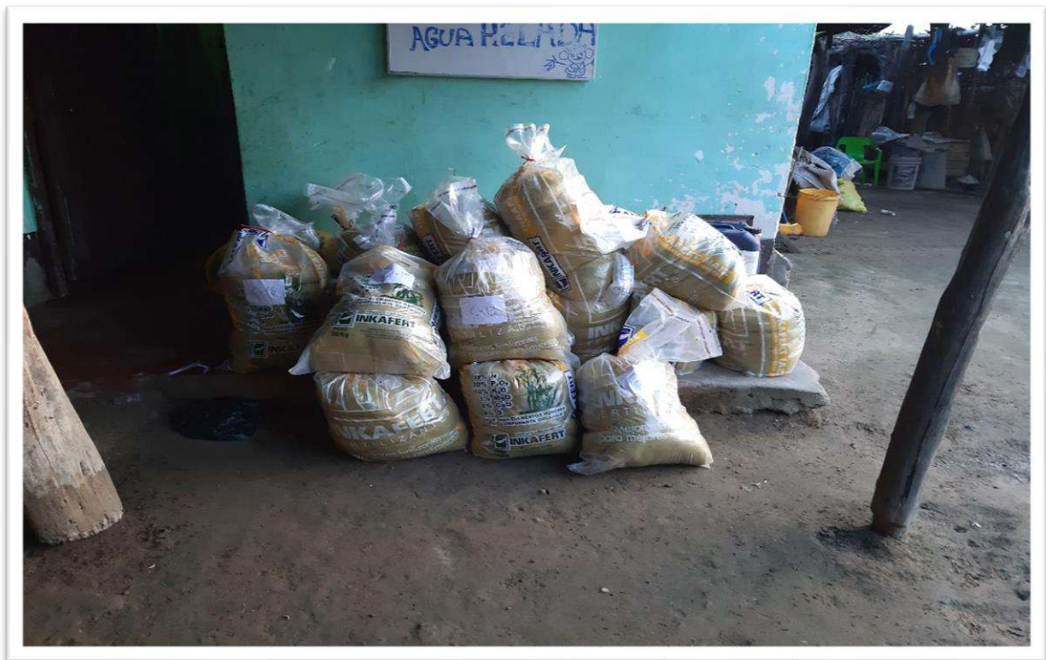
Figura N°18: recolección de las 17 calicatas enumeradas conteniendo 40 kg, c/u con sus estratos respectivos.
