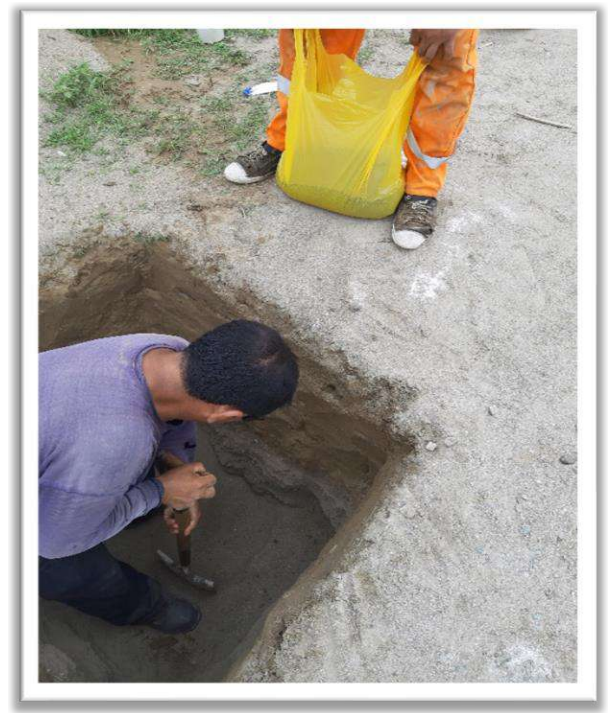
Figura N°04: CALICATA EN KM 1+500, Remarcado, Excavación.
