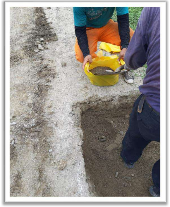
Figura N°07: CALICATA EN KM 3+000, Remarcado y Extracción del sustrato
