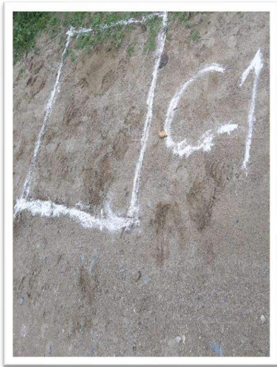
Figura N°01: CALICATA EN KM 0+00, Remarcado y Excavación.
