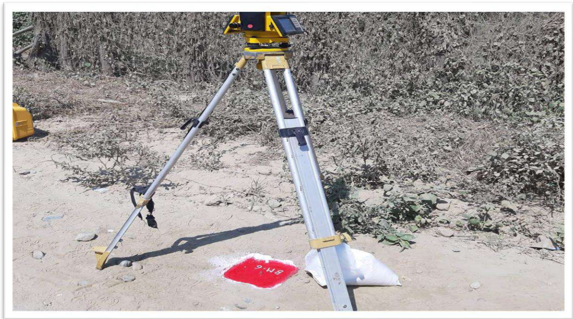
Figura N°06: BM-06, NORTE: 9344823.83, ESTE: 634206.211, ELEVACIÓN: 133.429. Fuente: Elaborado por el investigador.
