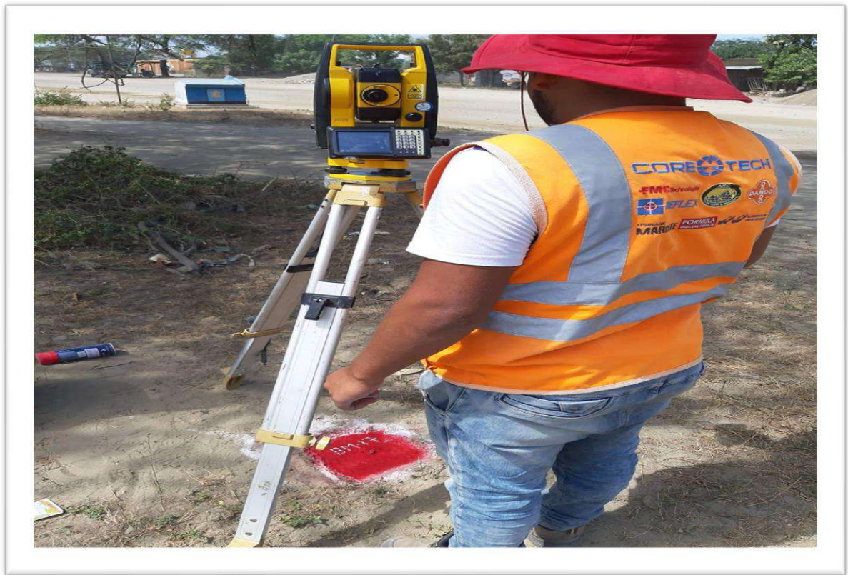
Figura N°17: BM-17, NORTE: 9347586.44, ESTE: 629127.537, ELEVACIÓN: 117.367. Fuente: Elaborado por el investigador.
