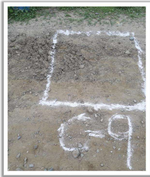
Figura N°09: CALICATA EN KM 4+000, Remarcado y Extracción del sustrato
