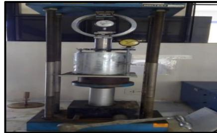
**FOTO N°32:** Observamos que ya se encuentra colocado el molde en la máquina de CBR
