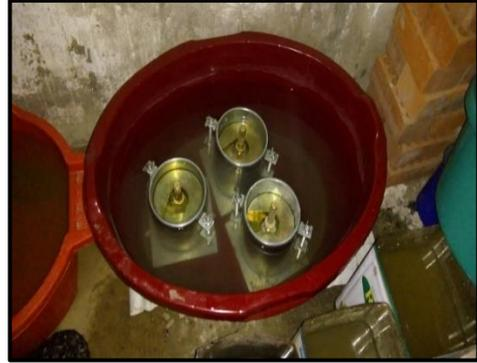
**FOTO N°30:** Colocación de los moldes CBR en agua durante 96 horas para su durado.
