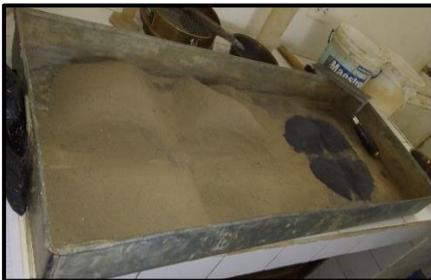
**FOTO N° 36:** Vista de la adición de un 3% de cenizas de hojas de maíz.
