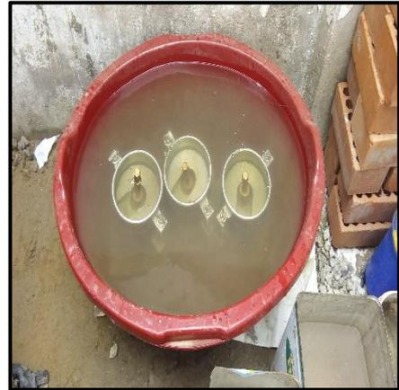
**FOTO N°47:** Se sumerge los moldes de cbr durante 94horas según MTC.
