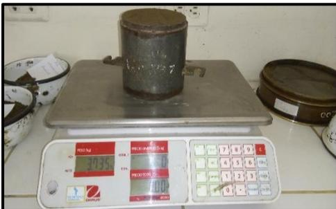
**FOTO N°23:** Peso de la muestra húmeda del suelo más molde.
