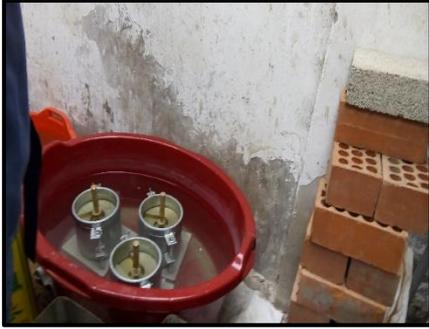
**FOTO N°40:** Se sumerge los moldes de cbr durante 94 horas según MTC.
