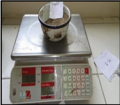
FOTO N°10: Pesando 690 gm de la muestra del suelo húmedo
