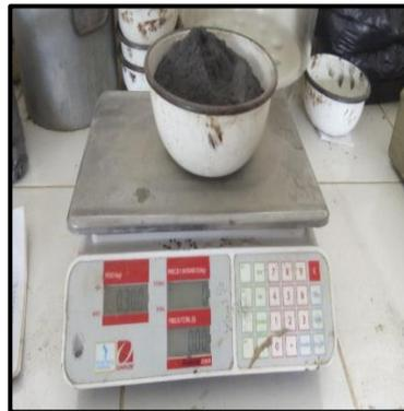
**FOTO N°43:** Peso de la adición en un 5% de cenizas de hojas de maíz.
