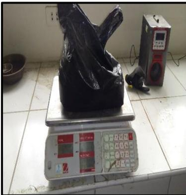
**FOTO N°42:** Pesado de 3 muestras de suelo de 6 kg cada una para el ensayo.
