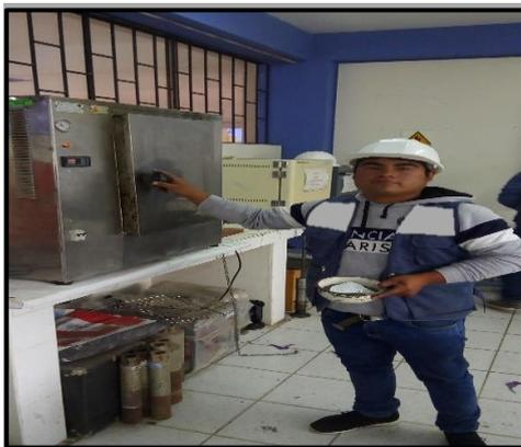
FOTO N° 14: secado del suelo en horno a 110°C
