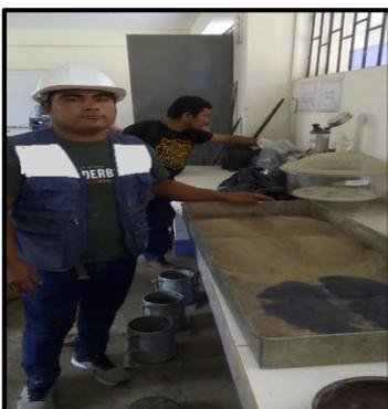
**FOTO N° 44:** cuarteo de materiales para Mezclado uniforme de los materiales para el CBR Experimental
