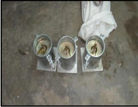
**FOTO N°29:** se coloca las pesas para cada molde de compactado 55golpes, 26golpes y 12golpes
