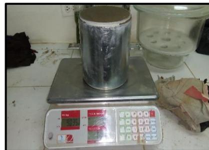
**FOTO N°39:** Peso del molde + la muestra húmeda compactada y enrasada.
