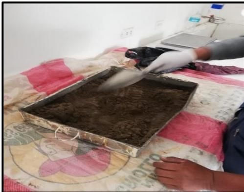
**FOTO N°21** Preparando la muestra de suelo y repartiéndolo en 5 partes iguales.
