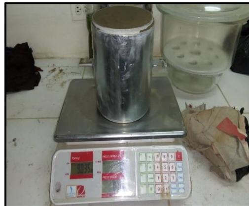
**FOTO N°28:** Pesando los moldes con la muestra de suelos húmedos ya compactados y enrasado.
