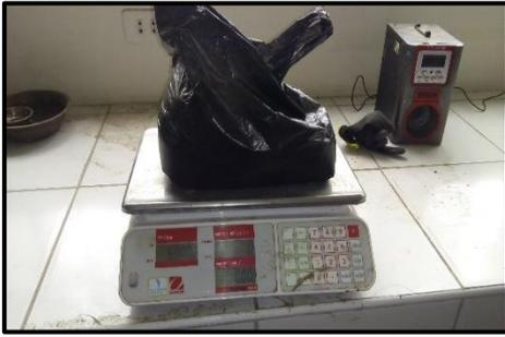
**FOTO N°34:** Pesado de 3 muestras de suelo de 6 kg cada una para el ensayo.
