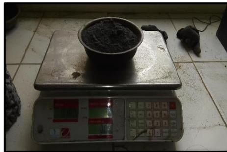
**FOTO N°35:** Peso de la adición en un 3% de cenizas de hojas de maíz.
