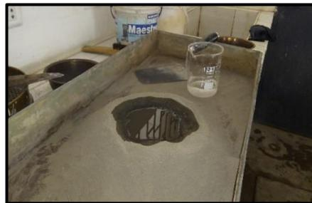
**FOTO N° 37:** Adición de agua en Mezclado uniforme de los materiales para el CBR Experimental
