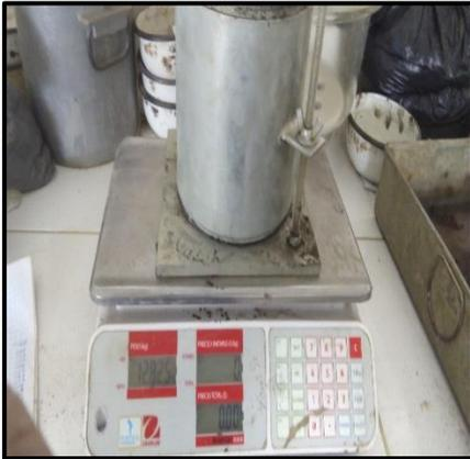
**FOTO N°46:** Peso del molde + la muestra húmeda compactada y enrasada.
