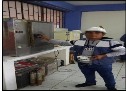
FOTO N°11: secando la muestra del suelo.
