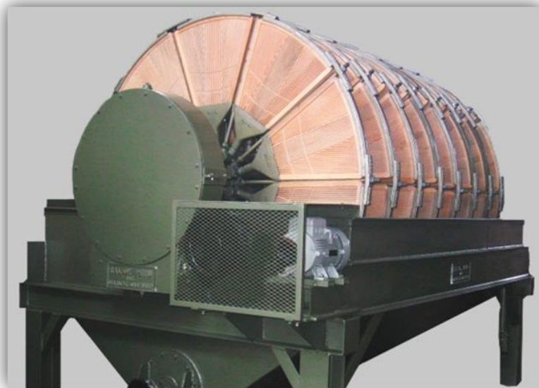
Figura 6- Filtro de vacío para minería, donde va el sector de madera incrustado en el disco
