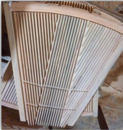
Figura 5- Sector de madera para filtros de disco de vacío tipo disco
