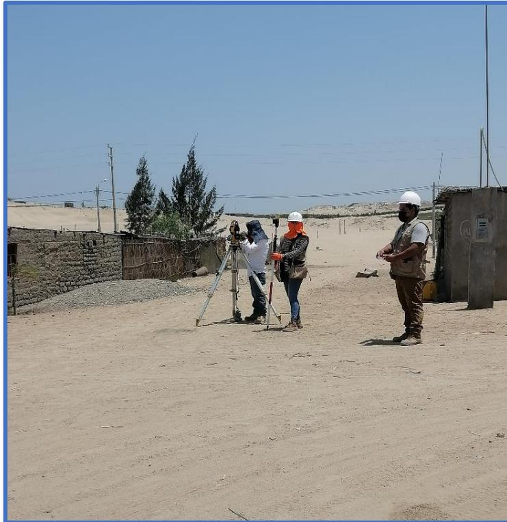
Iniciando el levantamiento topográfico con estación total
