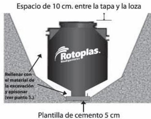
En el caso de suelos de expansión media y alta, se recomienda repellar las paredes de la excavación. En proporción de 1 Lata de Cemento por tres de arena con malla de gallinero anclada con tramos de varilla espaciados cada 50 cm. El espesor del repellado será de 3 cm.
