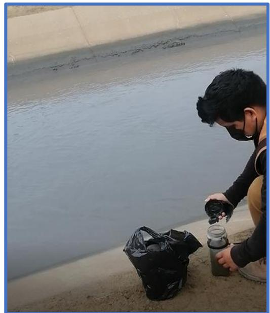
Toma de muestra de agua del canal, con ayuda de una cuerda para evitar accidentes
