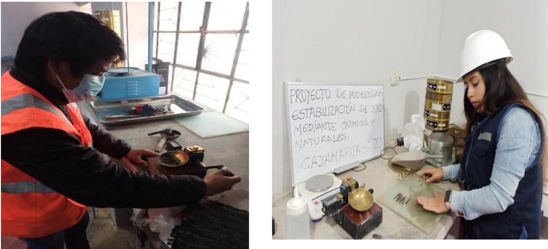
Ensayo de consistencia bajo las normativas MTC E-110 y MTC E-111, los cuales, permiten conocer el contenido de agua para los estados líquido, plástico e semisólido de una muestra de agregado.
