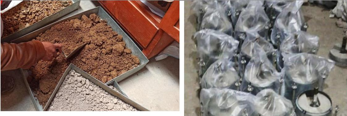
Dosificaciones de prueba del material granular afirmado con CEMENTO GU y ACEITE SULFONADO, para ser curados al ambiente durante 7 días y ser saturados luego durante 4 días
