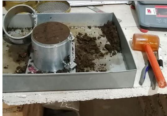
Dosificaciones de prueba del material granular afirmado con CEMENTO GU y CENIZA DE AGAVE AZUL, para ser curados al ambiente durante 5 días y ser saturados luego durante 4 días.
