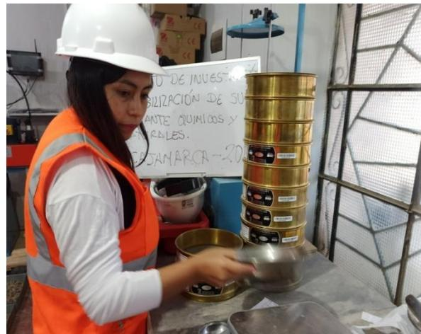
Ensayo granulométrico por tamizado bajo la normativa MTC E-204, el cual, permite conocer la distribución del tamaño de las partículas en una muestra de agregado.
