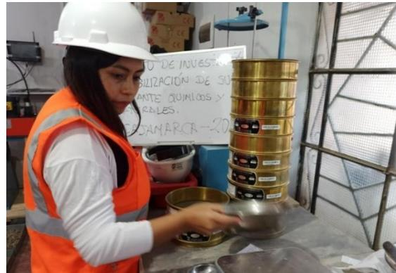
Ensayo granulométrico por tamizado bajo la normativa MTC E-204, el cual, permite conocer la distribución del tamaño de las partículas en una muestra de agregado.
