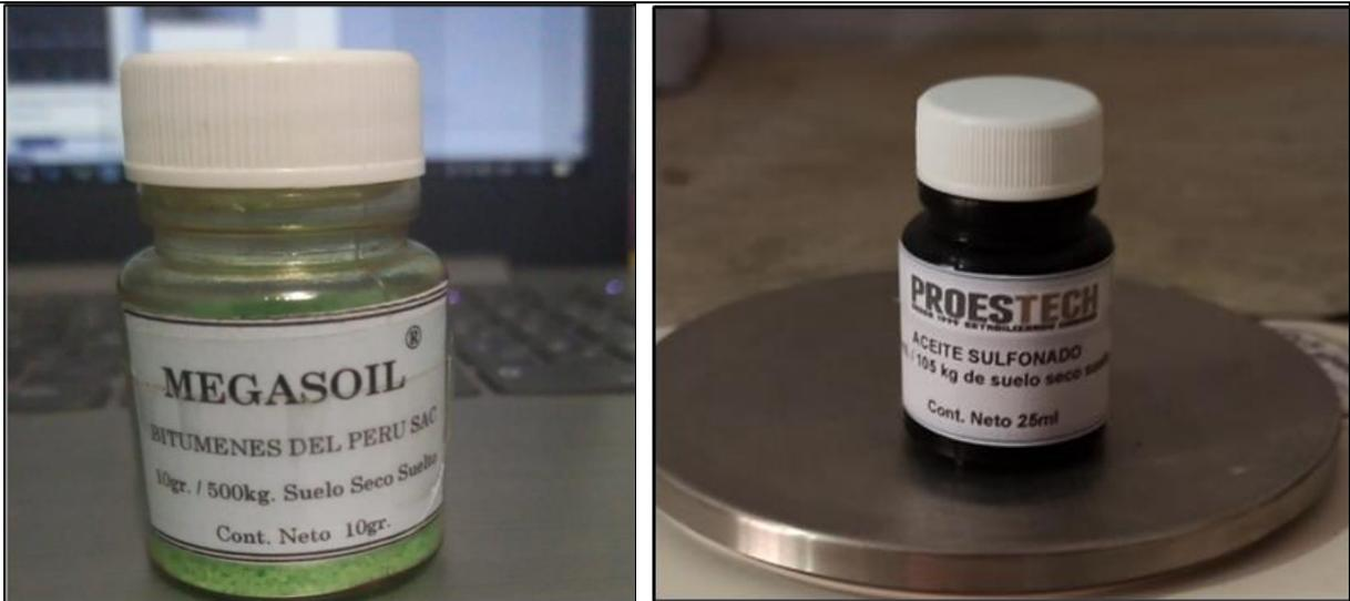
Vista de obtención del aditivo polimero en polvo seco soluble en agua (Megasoil) y Aceite Sulfonado (PROES).
