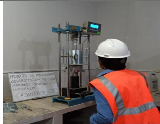
Ensayo de CBR bajo la normativa MTC E-132, se aprecia la separación, preparación, compactación, saturación y expansión de los especímenes moldeados para su posterior penetración en la prensa manual CBR.
