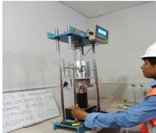
Ensayo de penetración, de especímenes saturados bajo la normativa MTCE-132, lo cual, permitió obtener mediante las lecturas registradas la capacidad de soporte CBR del material combinado.
