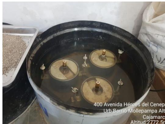
Dosificaciones de prueba del material granular afirmado con CEMENTO GU y MUSILAGO DE PENCA DE TUNA, para ser curados al ambiente durante 5 días y ser saturados luego durante 4 días.
