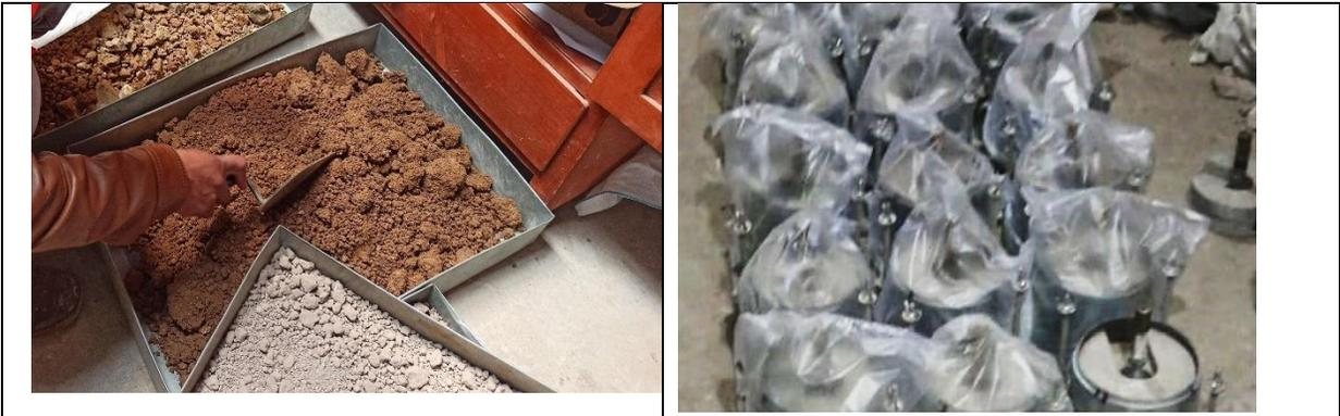
Dosificaciones de prueba del material granular afirmado con CEMENTO GU y ACEITE SULFONADO, para ser curados al ambiente durante 7 días y ser saturados luego durante 4 días.
