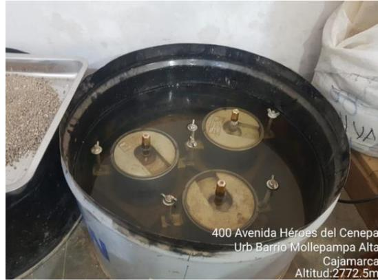
Dosificaciones de prueba del material granular afirmado con CEMENTO GU y MUCÍLAGO DE PENCA DE TUNA, para ser curados al ambiente durante 5 días y ser saturados luego durante 4 días.
