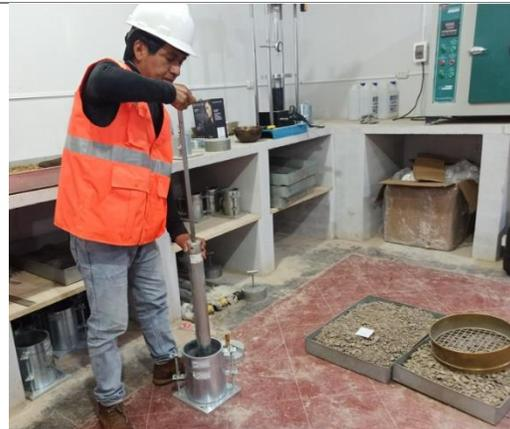
Dosificaciones de prueba del material granular afirmado con CEMENTO GU y ACEITE SULFONADO, para ser curados al ambiente durante 5 días y ser saturados luego durante 4 días.
