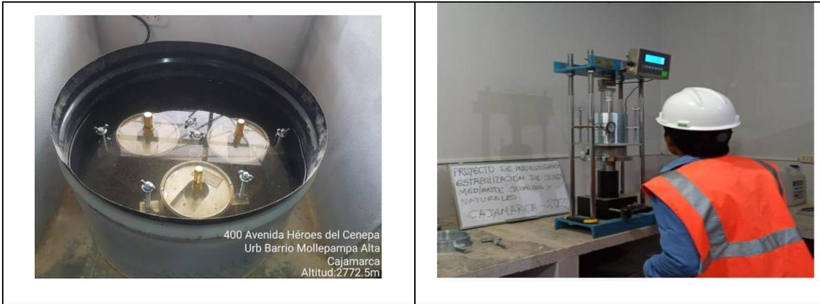
Ensayo de CBR bajo la normativa MTC E-132, se aprecia la separación, preparación, compactación, saturación y expansión de los especímenes moldeados para su posterior penetración en la prensa manual CBR.
