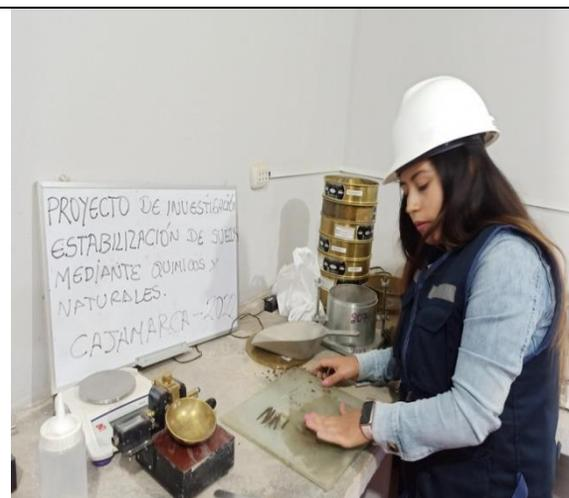
Ensayo de consistencia bajo las normativas MTC E-110 y MTC E-111, los cuales, permiten conocer el contenido de agua para los estados líquido, plástico e semisólido de una muestra de agregado.
