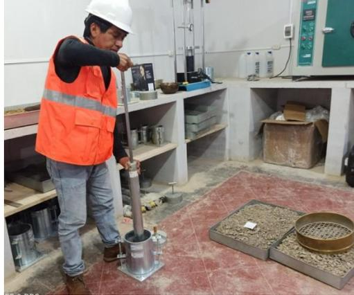
Dosificaciones de prueba del material granular afirmado con CEMENTO GU y MEGASOIL, para ser curados al ambiente durante 7 días y ser saturados luego durante 4 días.
