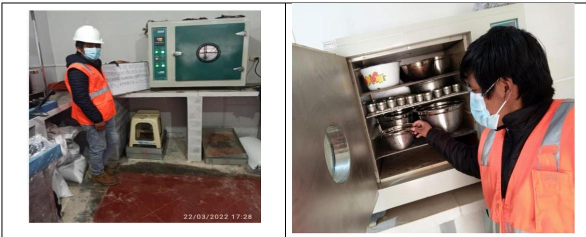
Ensayo de humedad natural bajo la normativa MTC E-108, el cual, permite conocer el contenido de humedad de una muestra.
