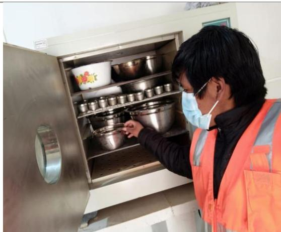
Ensayo de humedad natural bajo la normativa MTC E-108, el cual, permite conocer el contenido de humedad de una muestra.
