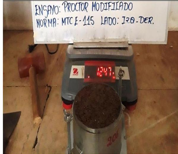
Secado de muestra de 500g para obtener la cantidad de agua a usar en los ensayos, se trabajará en 3 porcentajes. Hasta conseguir el óptimo contenido de humedad.
