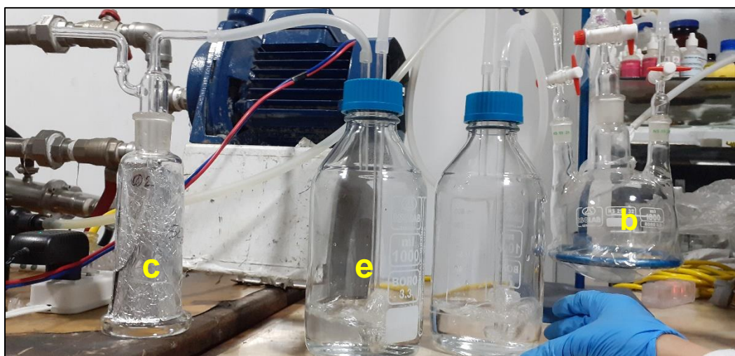
Figura N° 7: Paso del SO 2 hacia la botella de pyrex y la botella de lavado para ser captado
