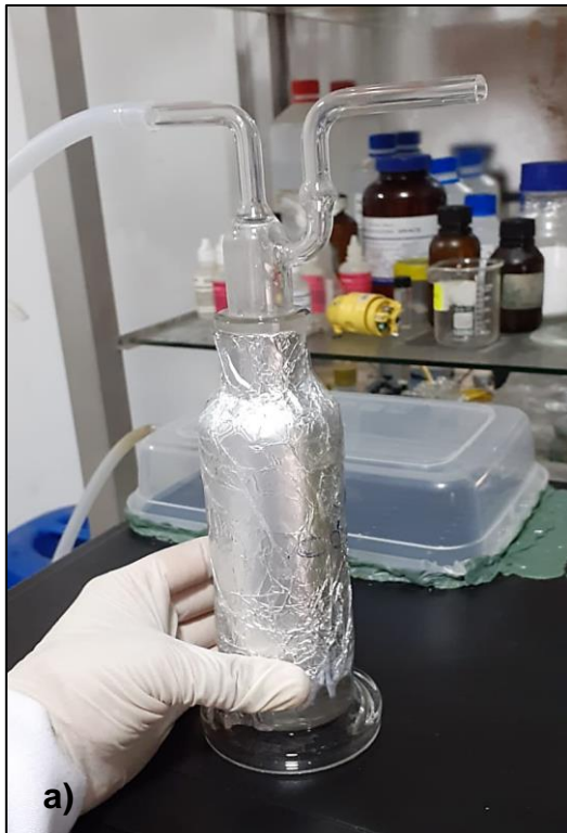
Figura N° 3: a). Solución captadora del gas de SO 2 b) Vaciado de la solución captadora
