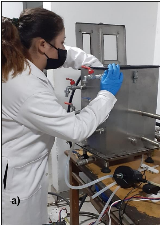
Figura N° 8:a) – b) Medición de la Temperatura de las nanoburbujas
