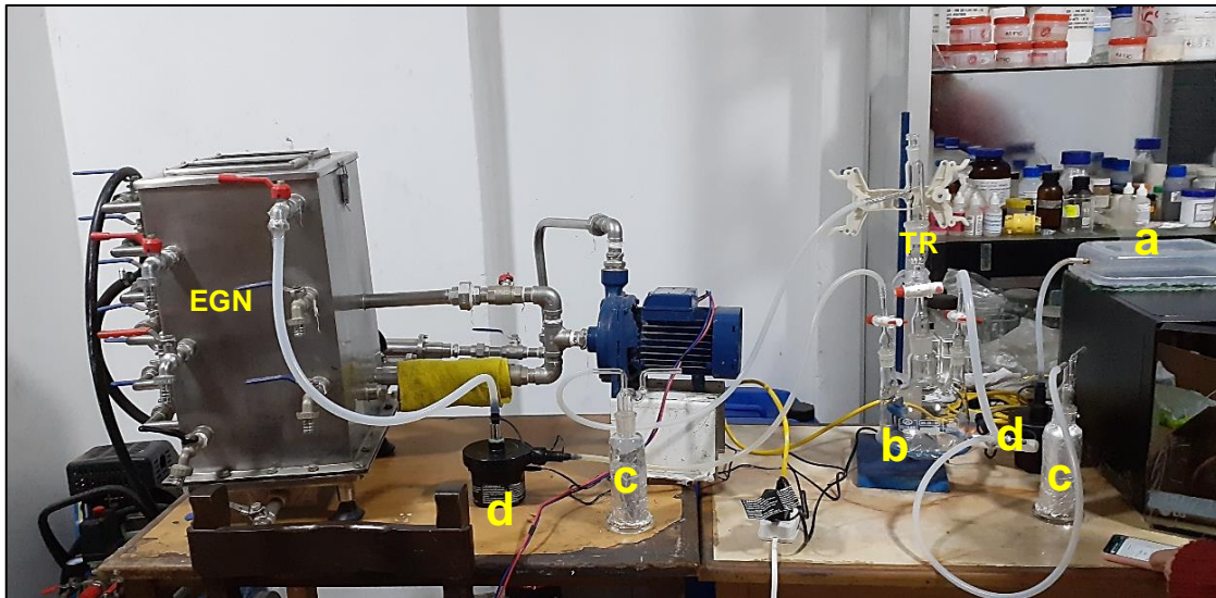
Figura N° 4: Sistema de Tratamiento de Nanoburbujas
