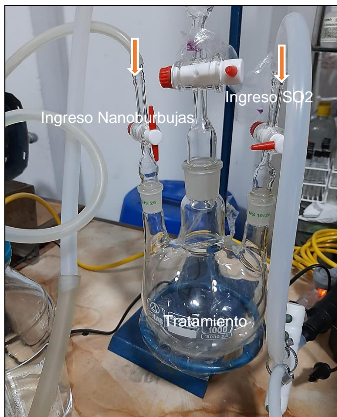
Figura N° 5: Ingreso de nanoburbujas aéreas y el SO 2 al frasco de 3 bocas
