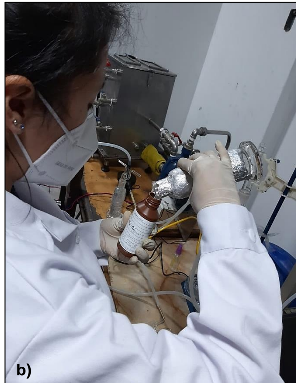
Figura N° 3: a). Solución captadora del gas de SO 2 b) Vaciado de la solución captadora
