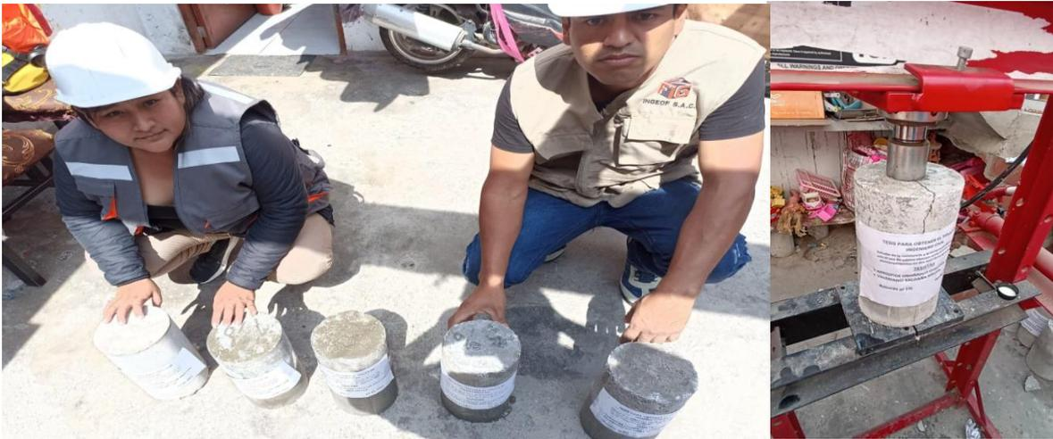
Figura 2: Prueba de Resistencia a los 14 días
