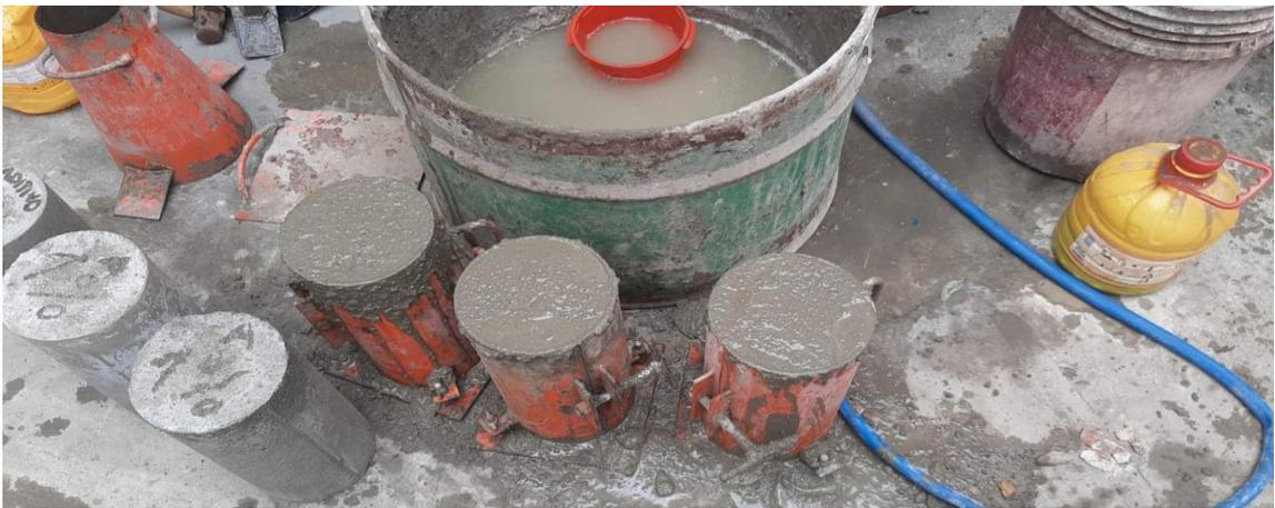
Figura 5: Elaboración de probetas
