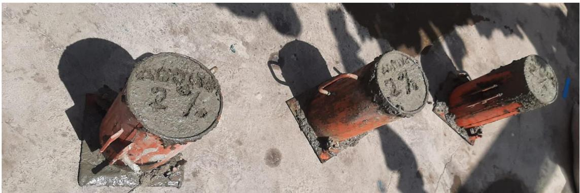
Figura 6: Probetas con el aditivo
