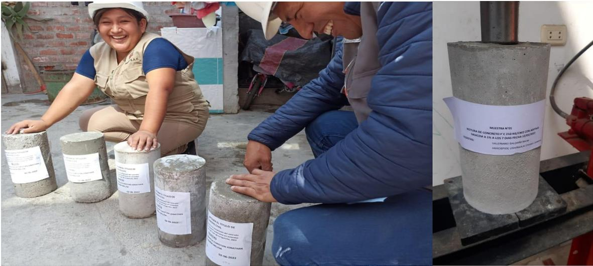
Figura 8: Prueba de Resistencia a los 7 días
