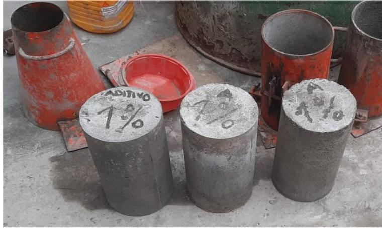
Figura 7: Probetas para probar la resistencia
