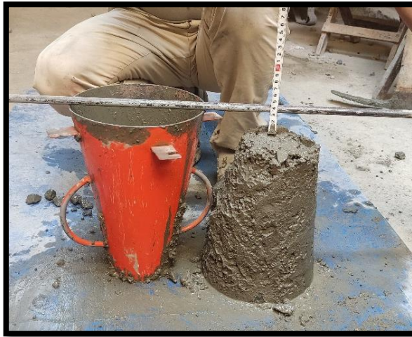
SLUMP PARA LA COMBINACIÓN CA+AF75N25R+AGN= 3.4CM
