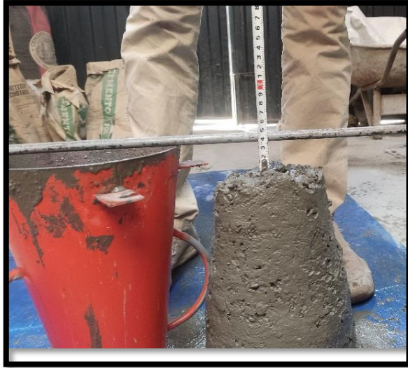
SLUMP PARA LA COMBINACIÓN CA+AF100N+AGN= 3.6CM
