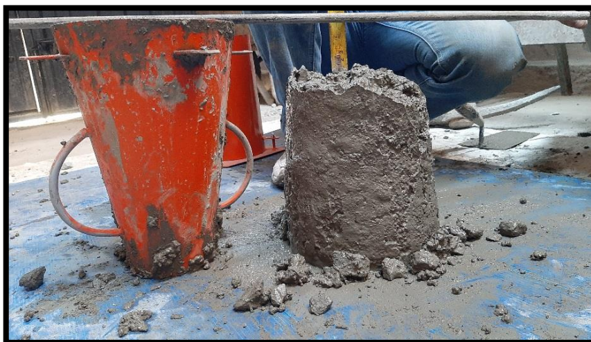
SLUMP PARA LA COMBINACIÓN CS+AF75N25R+AGN= 5.5CM
