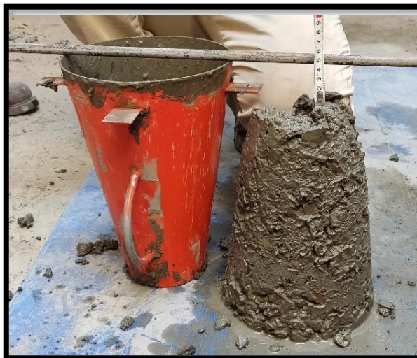
SLUMP PARA LA COMBINACIÓN CA+AF50N50R+AGN= 4.6CM
