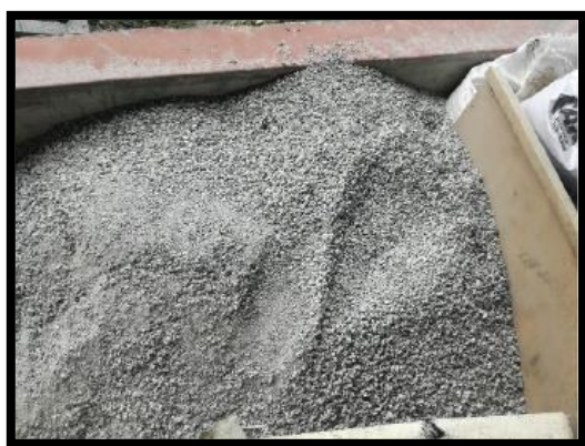
Figura 2. Agregado fino reciclado
