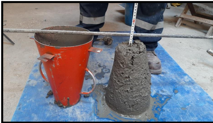
SLUMP PARA LA COMBINACIÓN CS+AF100N+AGN= 3.5CM
