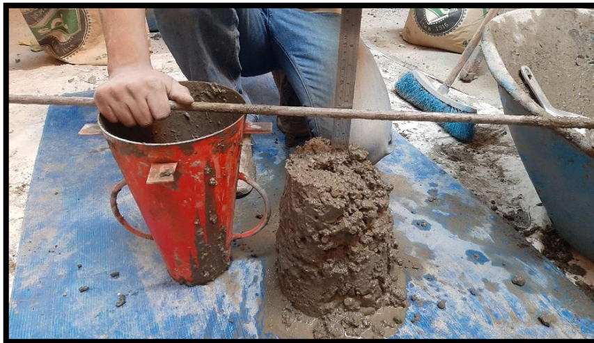
SLUMP PARA LA COMBINACIÓN CS+AF100N+AGN= 3.5CM
