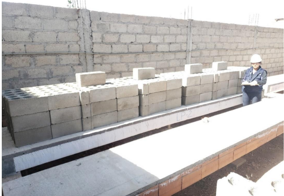
Figura 20. Aplicación de la carga por servicio a las losas aligeradas con viguetas pretensadas y bloques de EPS.
