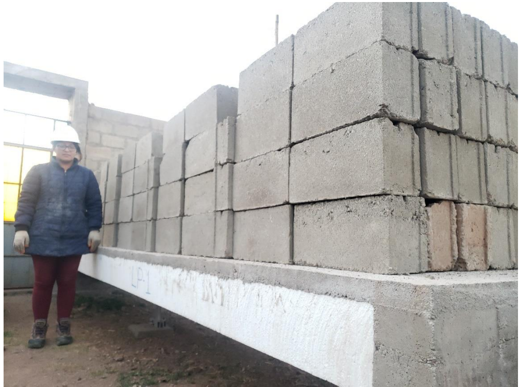
Figura 25. Aplicación de la reserva de carga por servicio a las losas aligeradas con viguetas pretensadas y bloques de EPS.
