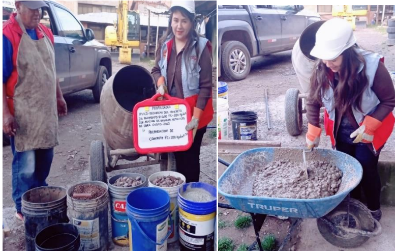
Figura 24. Preparación del concreto para elaborar muestras y realizar ensayos Fuente: Bonet Maldonado, 2022
