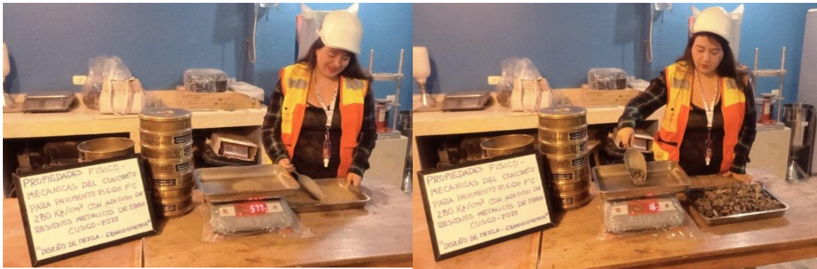
Figura 19. Tamizaje y peso de los agregados. Fuente: Bonet Maldonado, 2022
