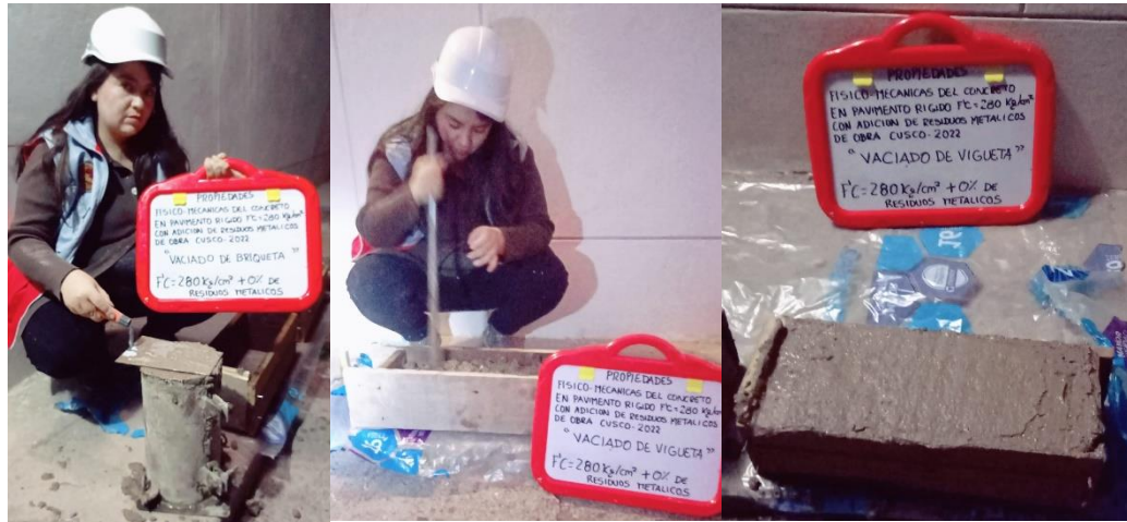
Figura 29. Elaboración de briquetas y viguetas para el ensayo de resistencia a la compresión y a la flexión utilizando el diseño sin adición de RMO. Fuente: Bonet Maldonado, 2022
