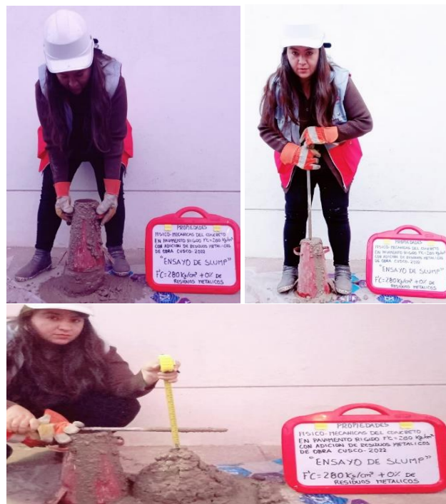
Figura 25. Ensayo de slump sin adición de RMO Fuente: Bonet Maldonado, 2022
