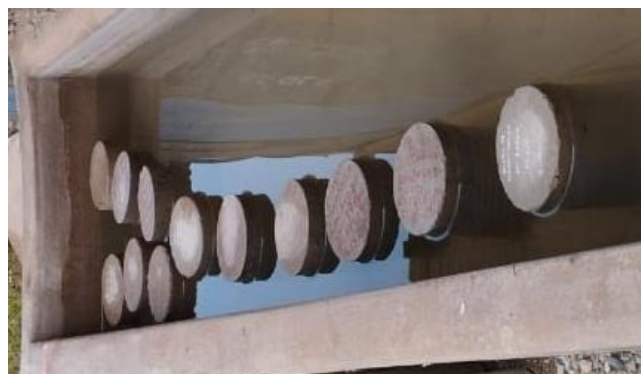
Figura 36. Curado de briquetas Fuente: Bonet Maldonado, 2022
