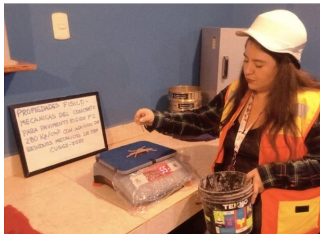
Figura 23. Estandarización de los RMO (clavos, alambres) pesar, medir, limpiar y cortar los para favorecer la correcta dosificación. Fuente: Bonet Maldonado, 2022
