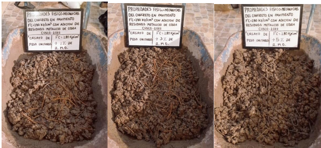
Figura 35. Ensayo del peso unitario con adición de residuos metálicos de obra Fuente: Bonet Maldonado, 2022
