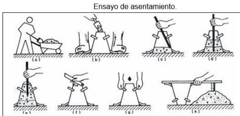
Figura 7. Asentamiento Fuente: Niño Hernández. Tecnología del concreto
