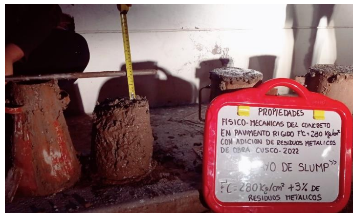
Figura 27. Ensayo de slump con adición de residuos metálicos de obra al 3%. Fuente: Bonet Maldonado, 2022
