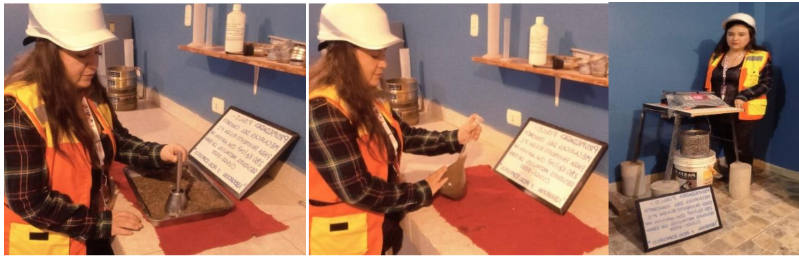
Figura 20. Cálculo de la densidad absoluta como relativa, PE y absorción de los agregados según las normas MTC E-205 y 206. Fuente: Bonet Maldonado, 2022
