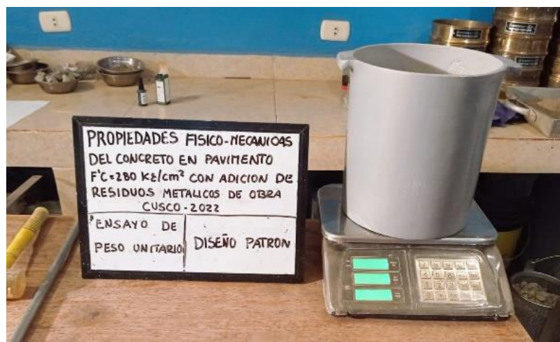
Figura 33. Calculo del peso del recipiente vacío (en kg). Fuente: Bonet Maldonado, 2022
