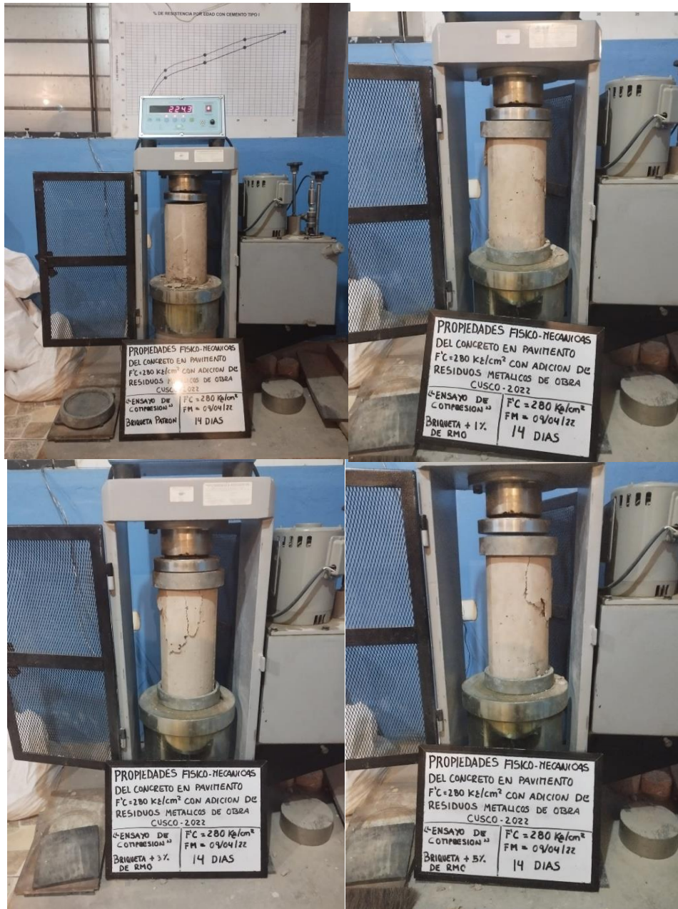
Figura 38. Rotura de briquetas Fuente: Bonet Maldonado, 2022
