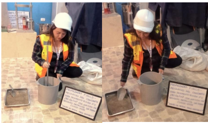
Figura 21. Determinación de la cantidad de vacíos y PU de agregados fino y grueso según norma del MTC E 203. Fuente: Bonet Maldonado, 2022
