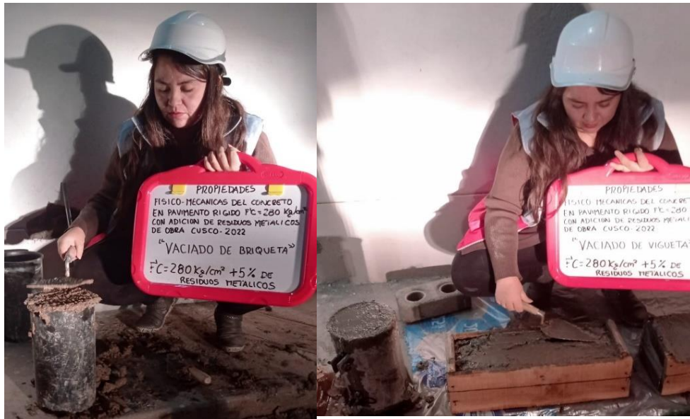
Figura 32. Elaboración de briquetas y viguetas con adición de RMO al 5%. Fuente: Bonet Maldonado, 2022
