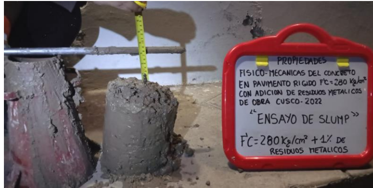
Figura 26. Ensayo de slump con adición de residuos metálicos de obra al 1%. Fuente: Bonet Maldonado, 2022
