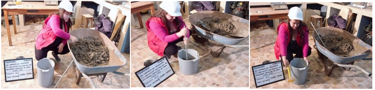
Figura 34. Compactación con el uso de una varilla y martillo de goma Fuente: Bonet Maldonado, 2022
