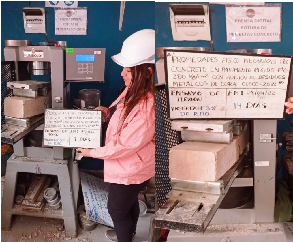
Figura 39. Ensayos de acuerdo a las normas ASTM C39 - C78 rotura de viguetas. Fuente: Bonet Maldonado, 2022
