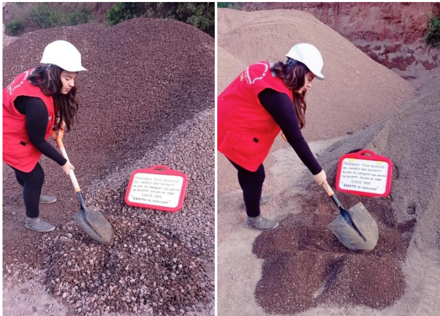
Figura 17. Método del cuarteo para llevar a laboratorio una muestra representativa del agregado Fuente: Bonet Maldonado, 2022
