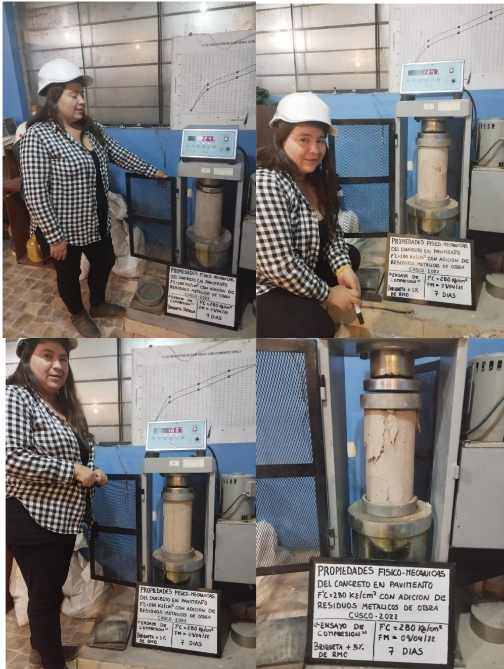
Figura 37. Ensayos se realizan de acuerdo a las normas ASTM C39 - C78 Fuente: Bonet Maldonado, 2022
