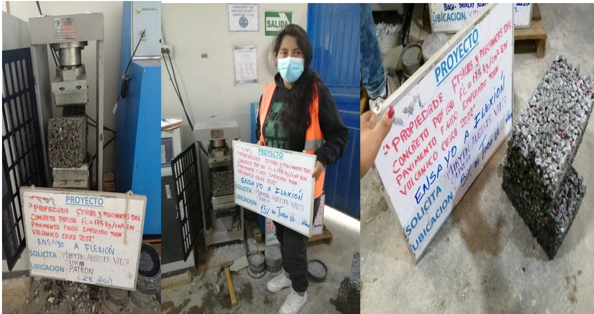
Figura 25. Ensayo de resistencia a Flexión
