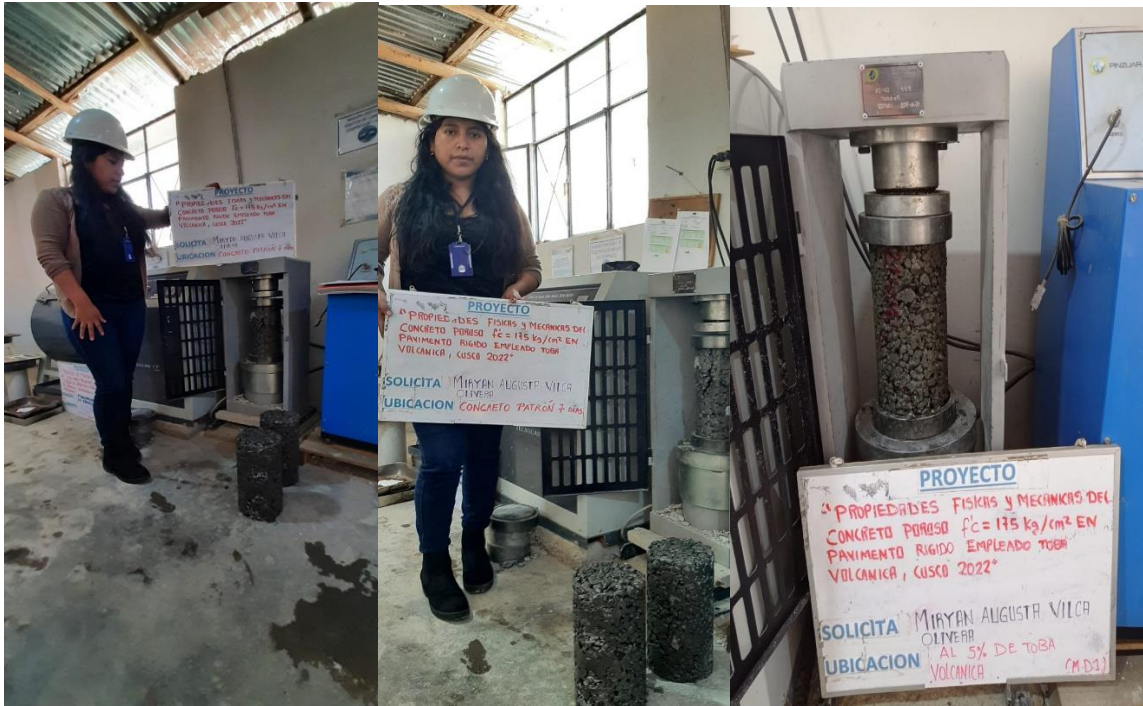
Figura 20. Resistencia a compresión
