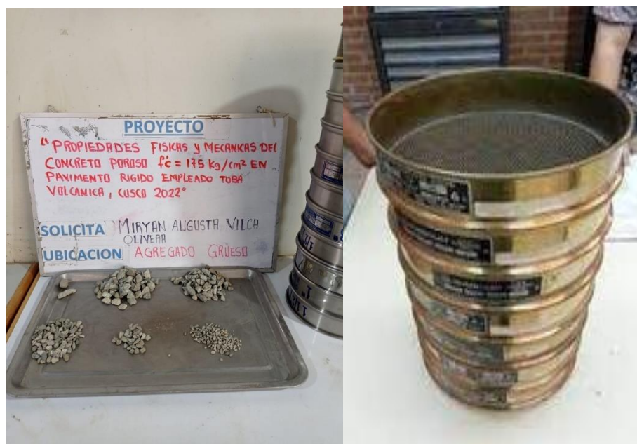
Figura 5. Ensayo de granulometría para los agregados
