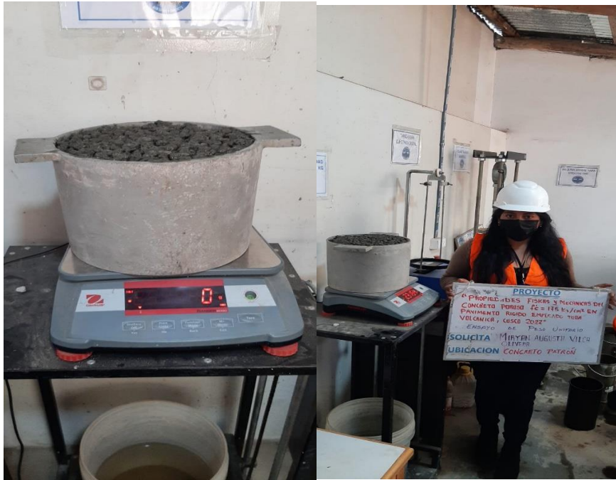
Figura 15. Determinación del peso unitario del concreto fresco
