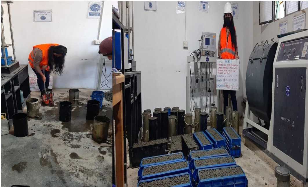
Figura 12. Elaboración de especímenes cilíndricos y prismáticos.
