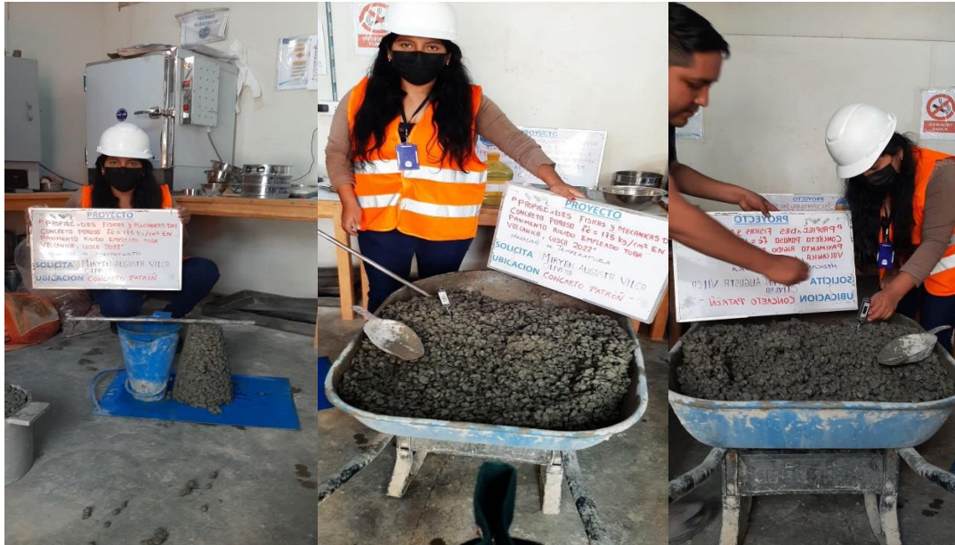
Figura 14. Medición de temperatura y asentamiento
