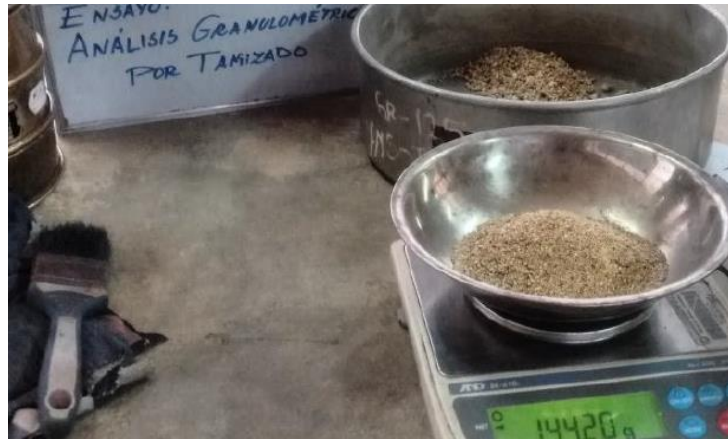
Figura 22. Pesado y registro de las proporciones por tamiz.
