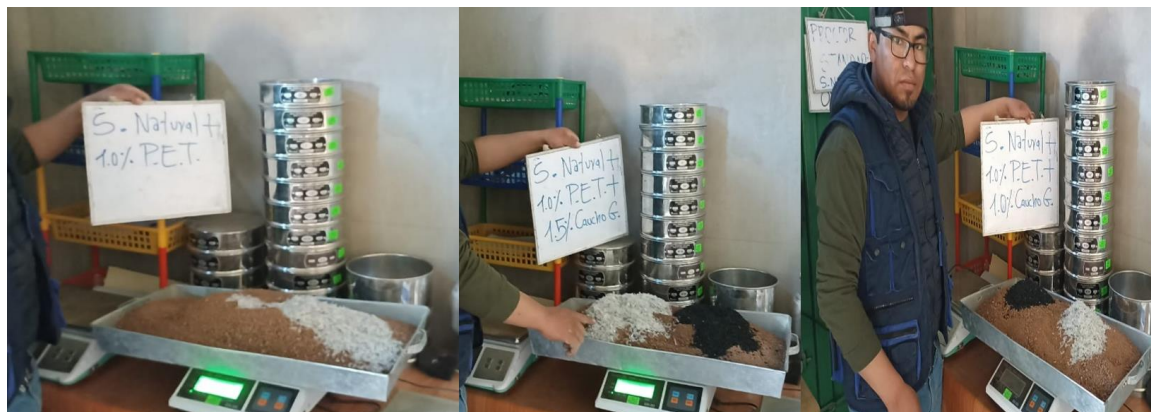
Figura 36. Dosificación de PET y Caucho Granulado. De la misma forma para los demás especímenes.
