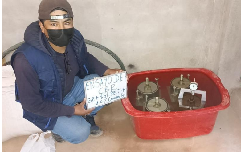
Figura 46. Lectura de deformación de muestras compactadas.
