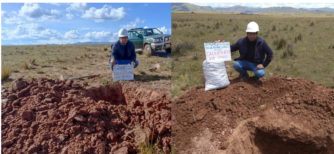
Figura 12. Muestreo y Extracción de Material de la Calicata N°03.
