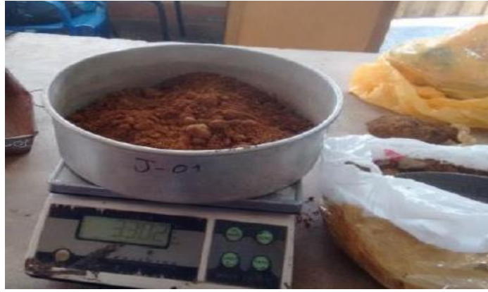
Figura 19. Muestra de suelo húmedo y pesado.
