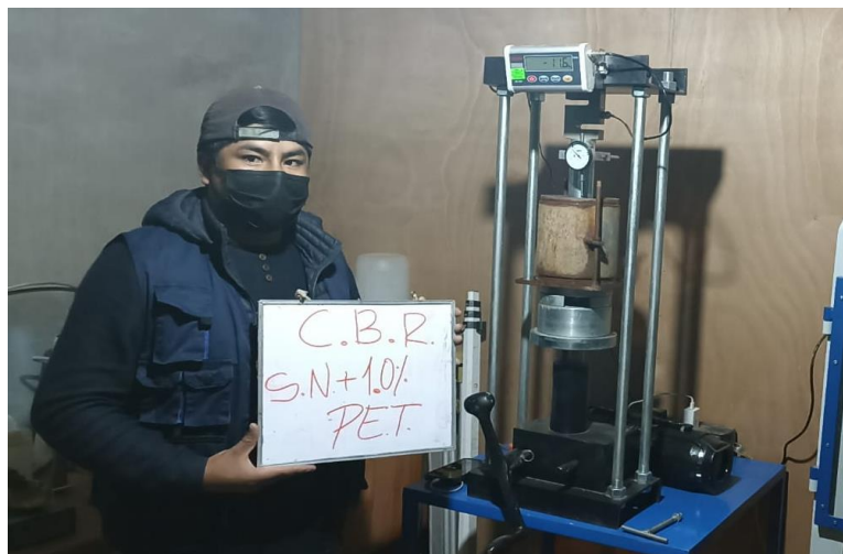
Figura 48. Muestra y molde CBR en prensa manual del espécimen S.N. + 1% P.E.T.
