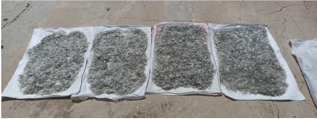
Figura 15. Proceso de secado de Tereftalato de Polietileno.
