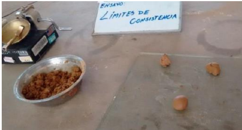
Figura 24. Proporciones de muestra para el límite plástico.
