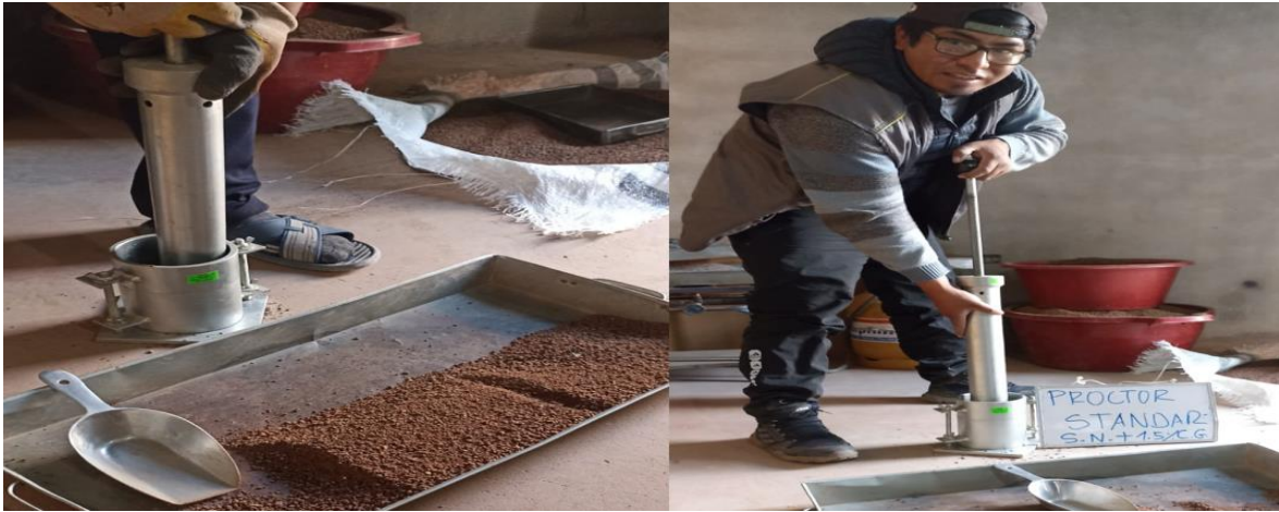
Figura 38. Separación de Muestra en 3 capas para compactación.
