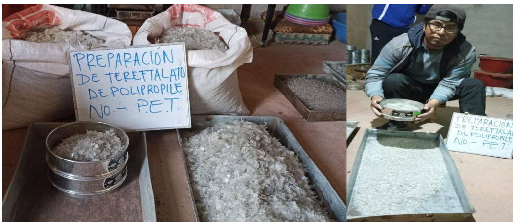
Figura 16. Tamizado de Tereftalato de Polietileno pasantes de la Malla N°4 y retenidas de la Malla N°10. Obteniendo un tamaño de 4.75mm.
