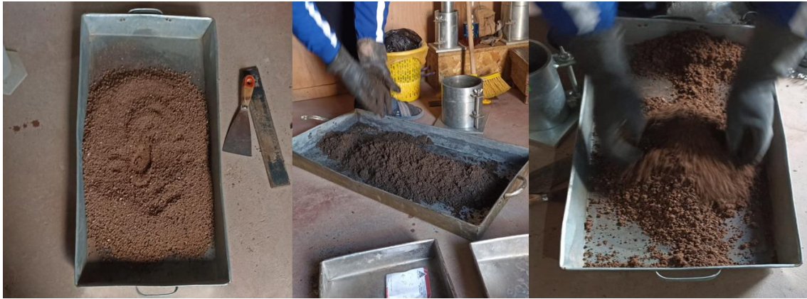
Figura 37. Homogenización de mezcla de Suelo, Caucho Granulado y Agua. De la misma forma para los demás especímenes.
