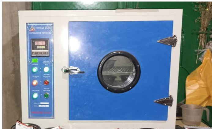
Figura 20. Secado de Muestras húmedas en horno eléctrico.
