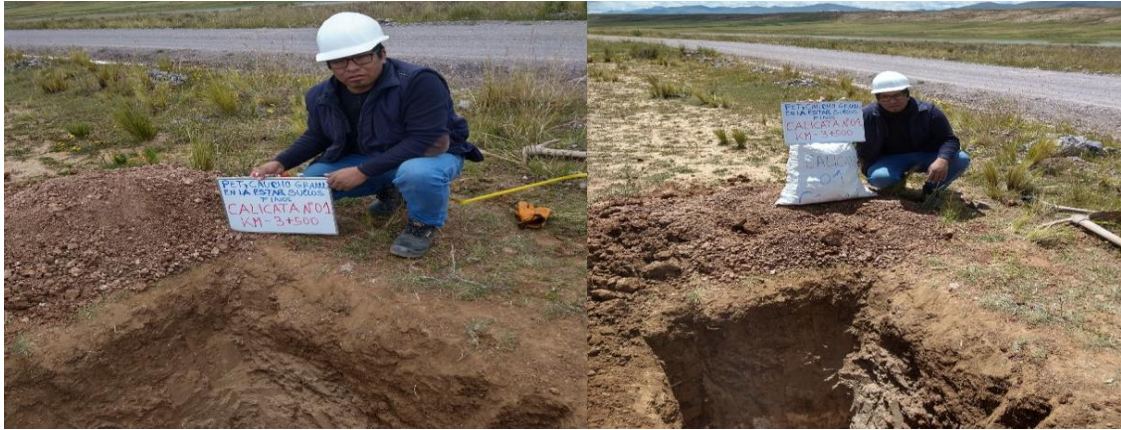
Figura 10. Muestreo y Extracción de Material de la Calicata N°01.
