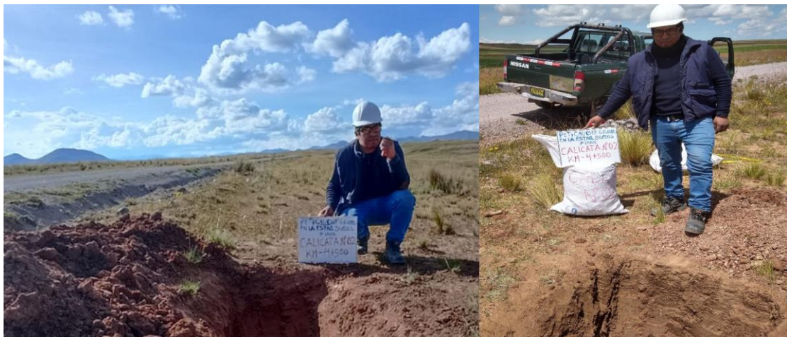
Figura 11. Muestreo y Extracción de Material de la Calicata N°02.
