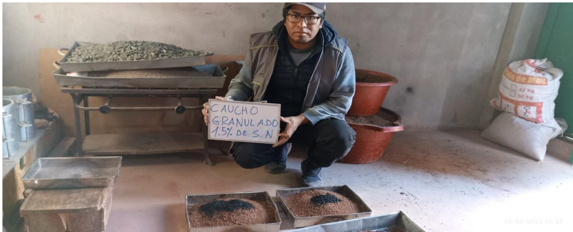
Figura 35. Dosificación de Caucho. 1.5% del peso seco de la muestra. De la misma forma para los demás especímenes.
