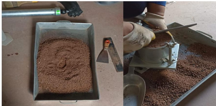
Figura 28. Figura Separación de Muestra en 3 capas para compactación.
