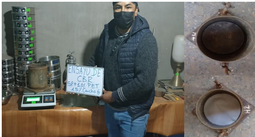
Figura 41. Medición del diámetro, altura y peso de los moldes de CBR.
