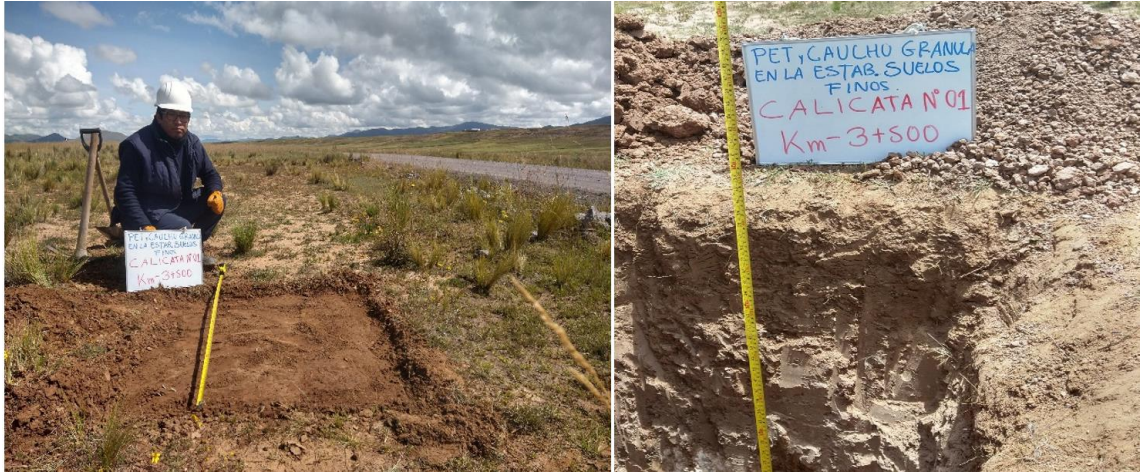
Figura 7. Reconocimiento y Excavación de Calicata N°01.
