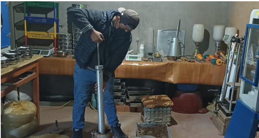
Figura 30. Compactación de Muestra a 12, 25 y 56 golpes.
