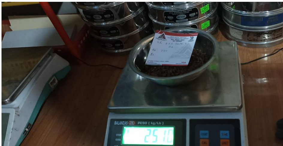
Figura 39. Extracción de muestra para su pesado y secado en horno eléctrico.
