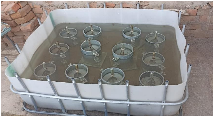
Figura 45. Saturación de Muestras compactadas.
