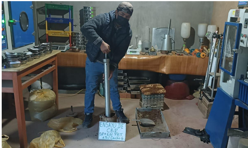
Figura 44. Compactación de muestra con pistón de 44.5 N.
