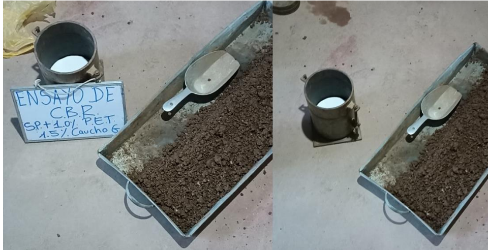
Figura 43. Muestra preparada para su compactación a 12, 25 y 56 golpes.
