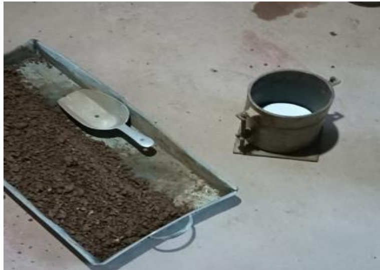
Figura 29. Preparación de muestra para su compactación.
