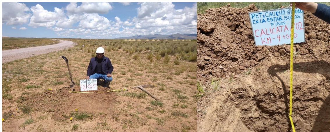
Figura 8. Reconocimiento y Excavación de Calicata N°02.
