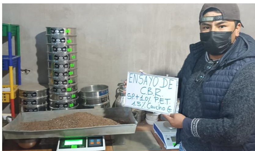
Figura 42. Muestra preparada para el ensayo de CBR.
