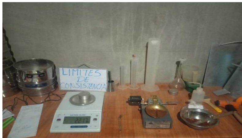
Figura 23. Límites de Consistencia de Cantera Calicata N°01,02 Y 03.
