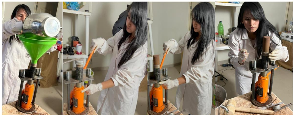
Figura 13: Proceso de compactación
