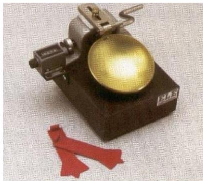
Figura 3: Copa Casagrande para ensayo de limite liquido
