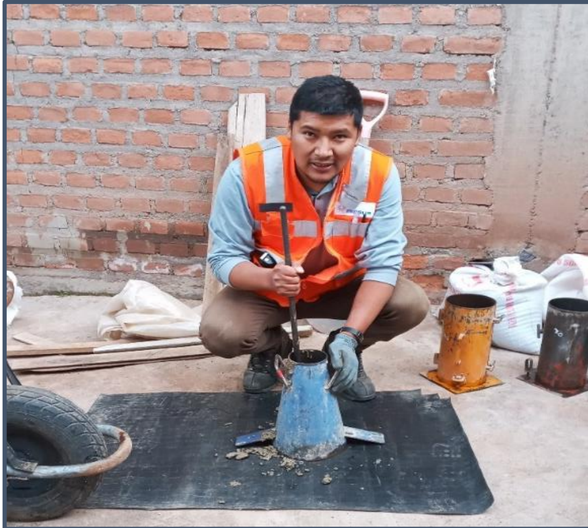
Imagen N° 38 Ensayo de asentamiento/ varillado.
