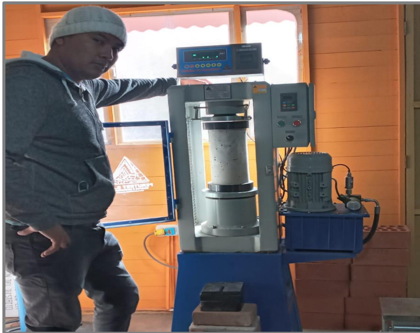
Imagen N° 45 Muestras sometidas a ensayo de compresión Uniaxial.
