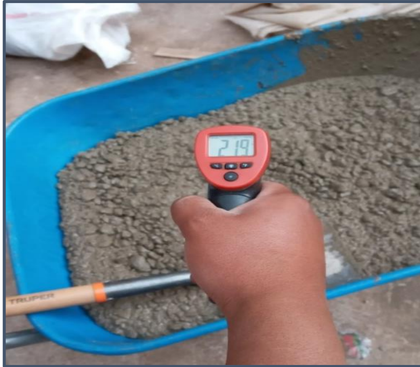
Imagen N° 36 Lectura de temperatura del concreto fresco.
