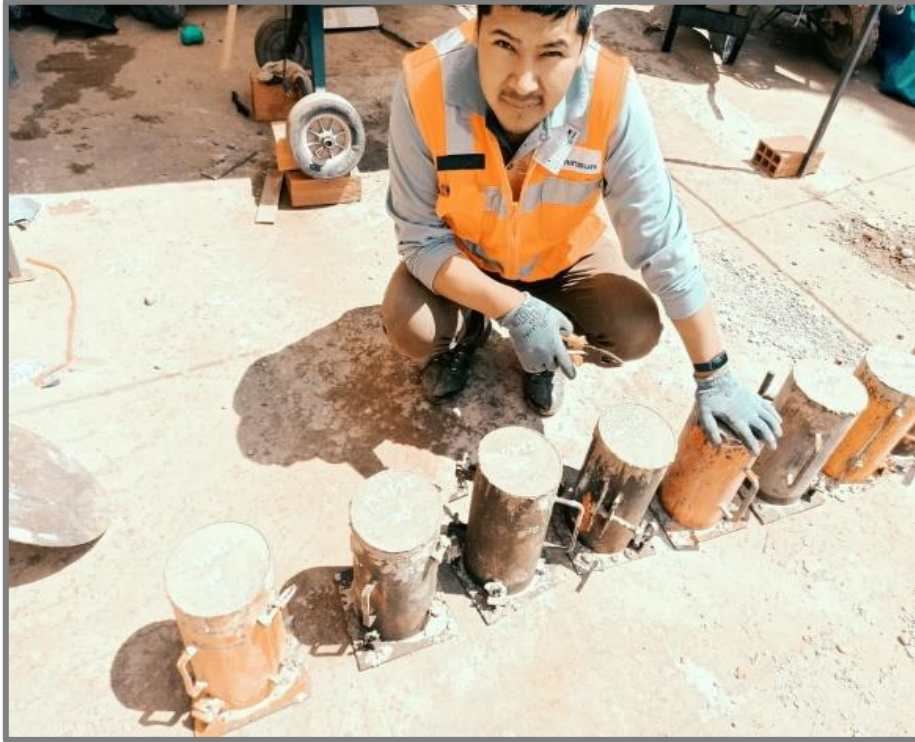
Imagen N° 44 Muestras antes de desmoldarse
