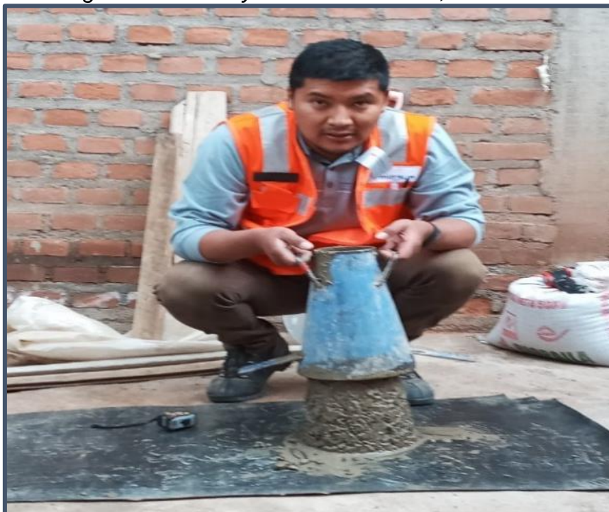
Imagen N° 39 Ensayo de asentamiento, desmóldelo.
