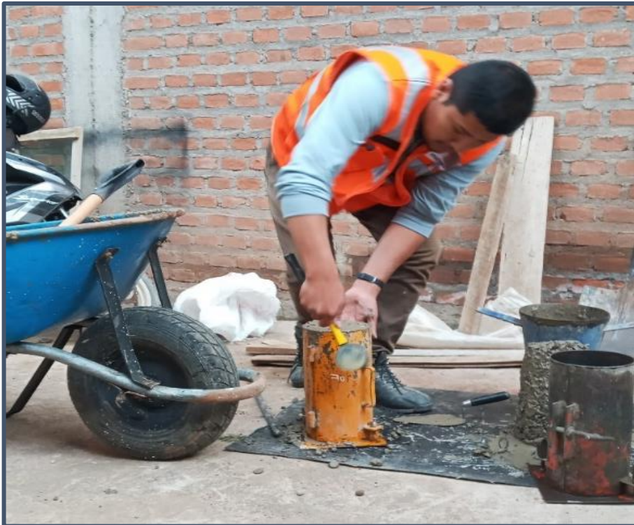
Imagen N° 43 Proceso de elaboración de muestras de Concreto
