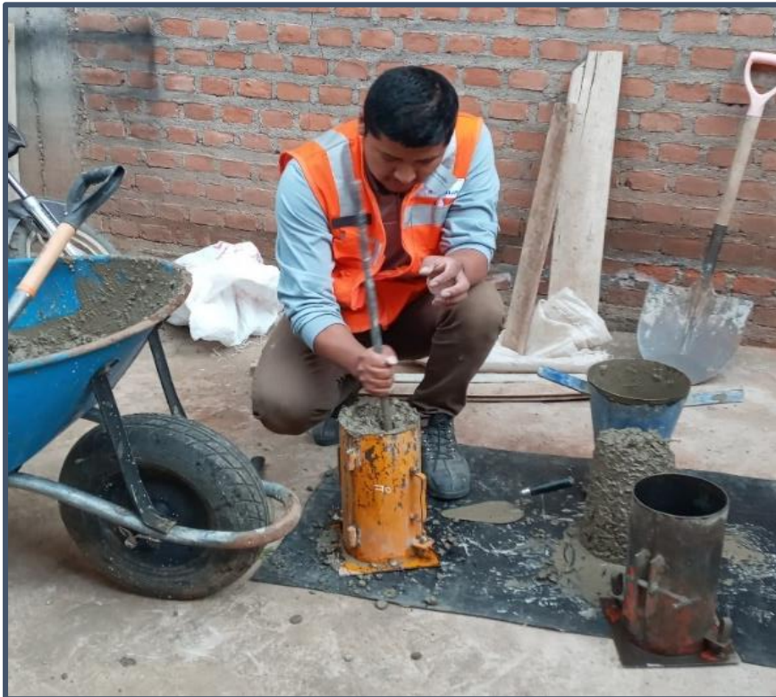
Imagen N° 41 Proceso de elaboración de muestras de concreto.
