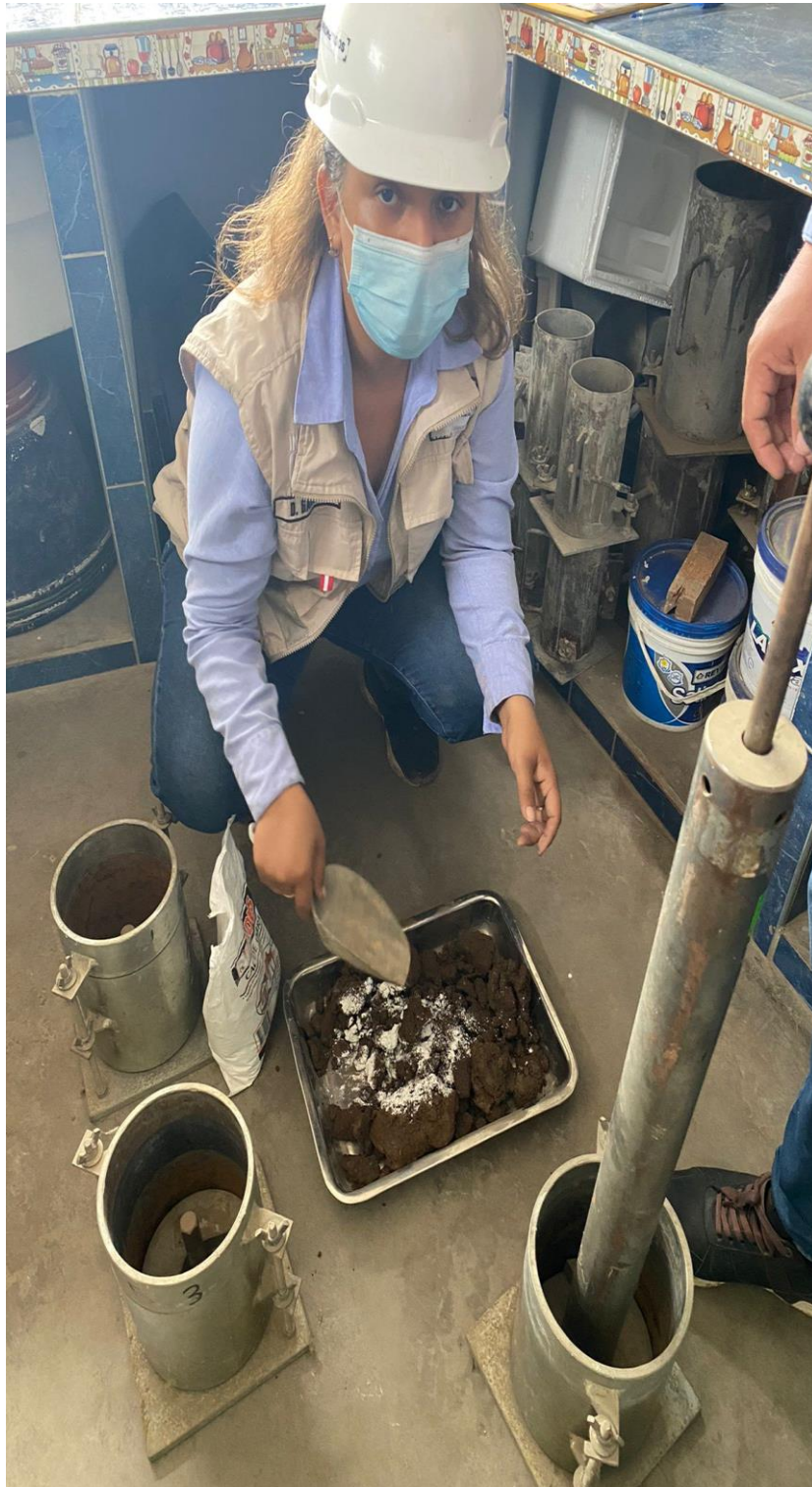
Poniendo la cal para la mezcla respetiva
