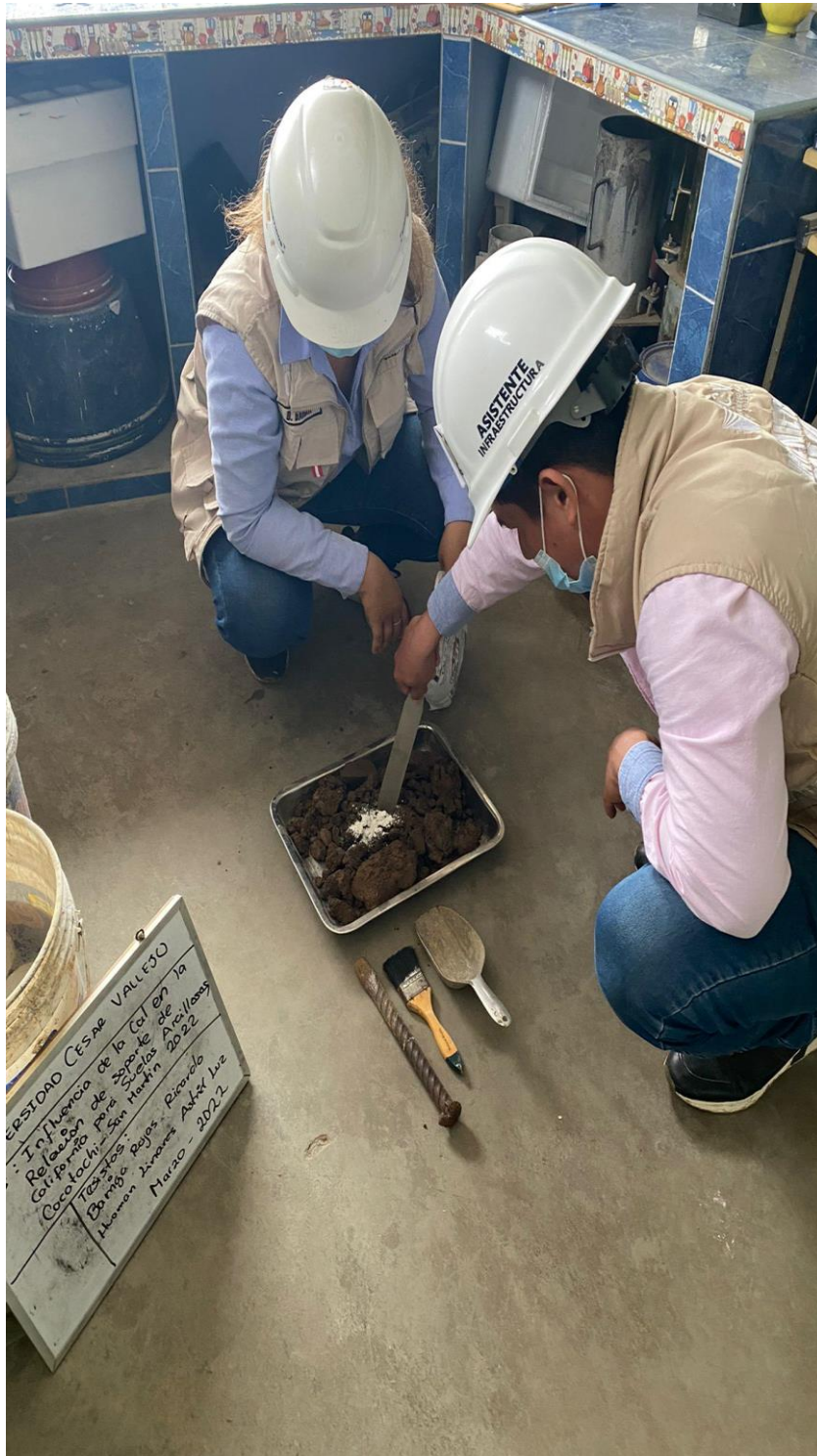
EMPEZANDO EL MESCLADO DE LA CAL CON LA MUESTRA
