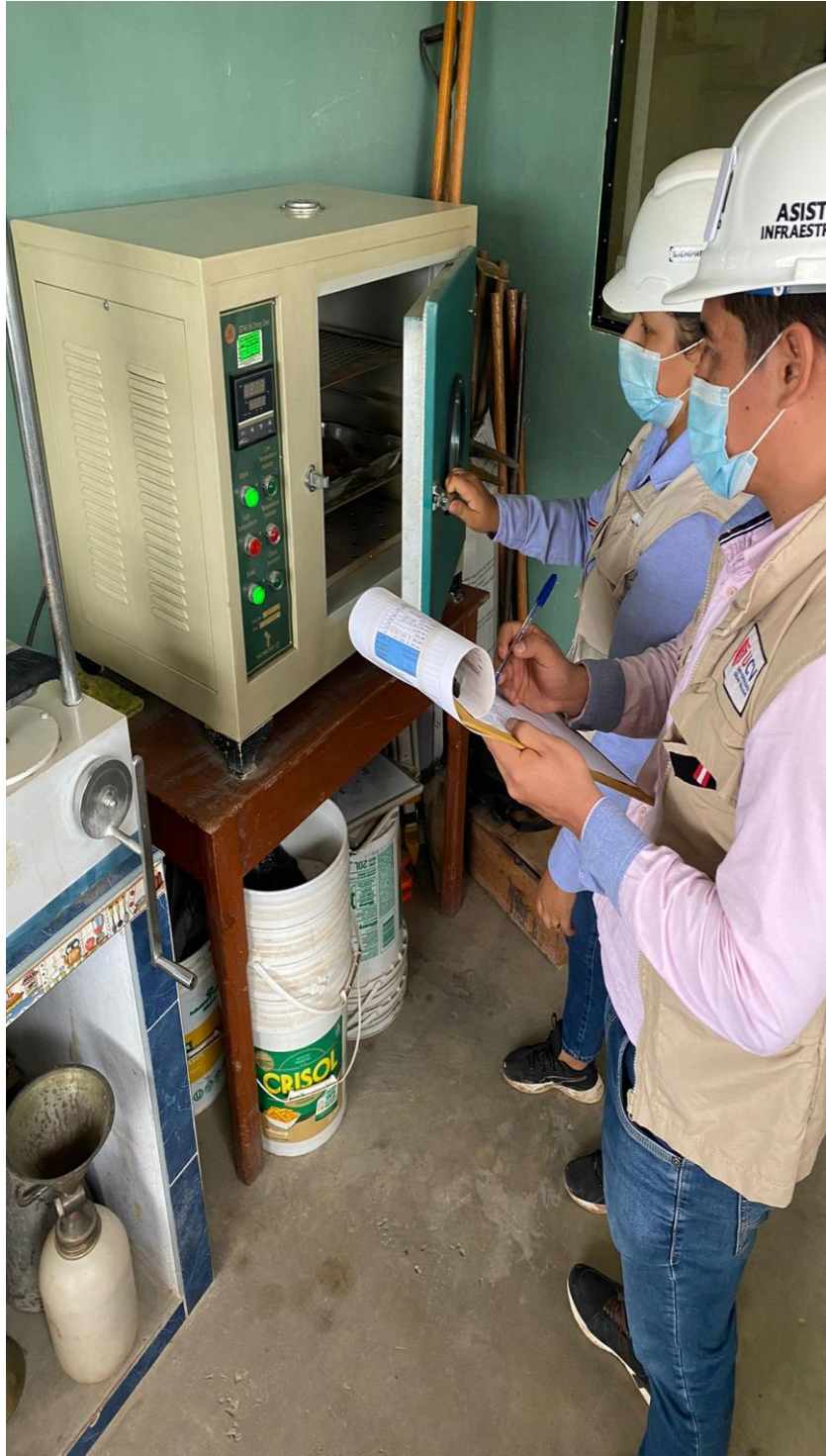
COLOCANDO LA ARENA DENTRO DEL HORNO
