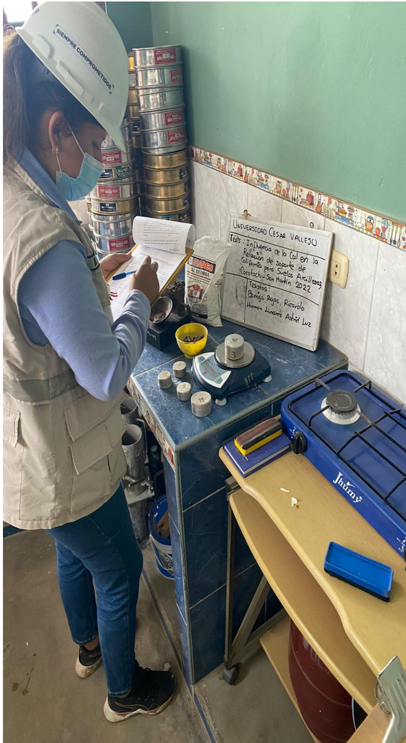
PESANDO LA MUESTRA HUMEDAD
