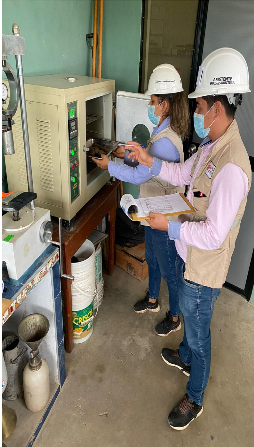
COLOCANDO LA ARENA DENTRO DEL HORNO PARA EL SECADO DE LA MUESTRA
