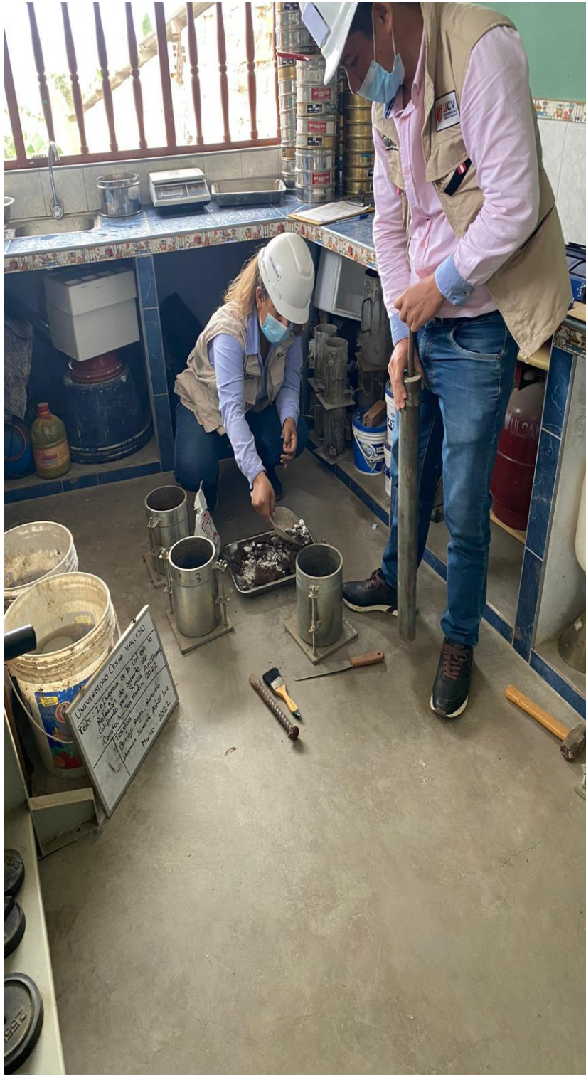
Mezcla de la cal con la muestra poniéndole para ser apisonada
