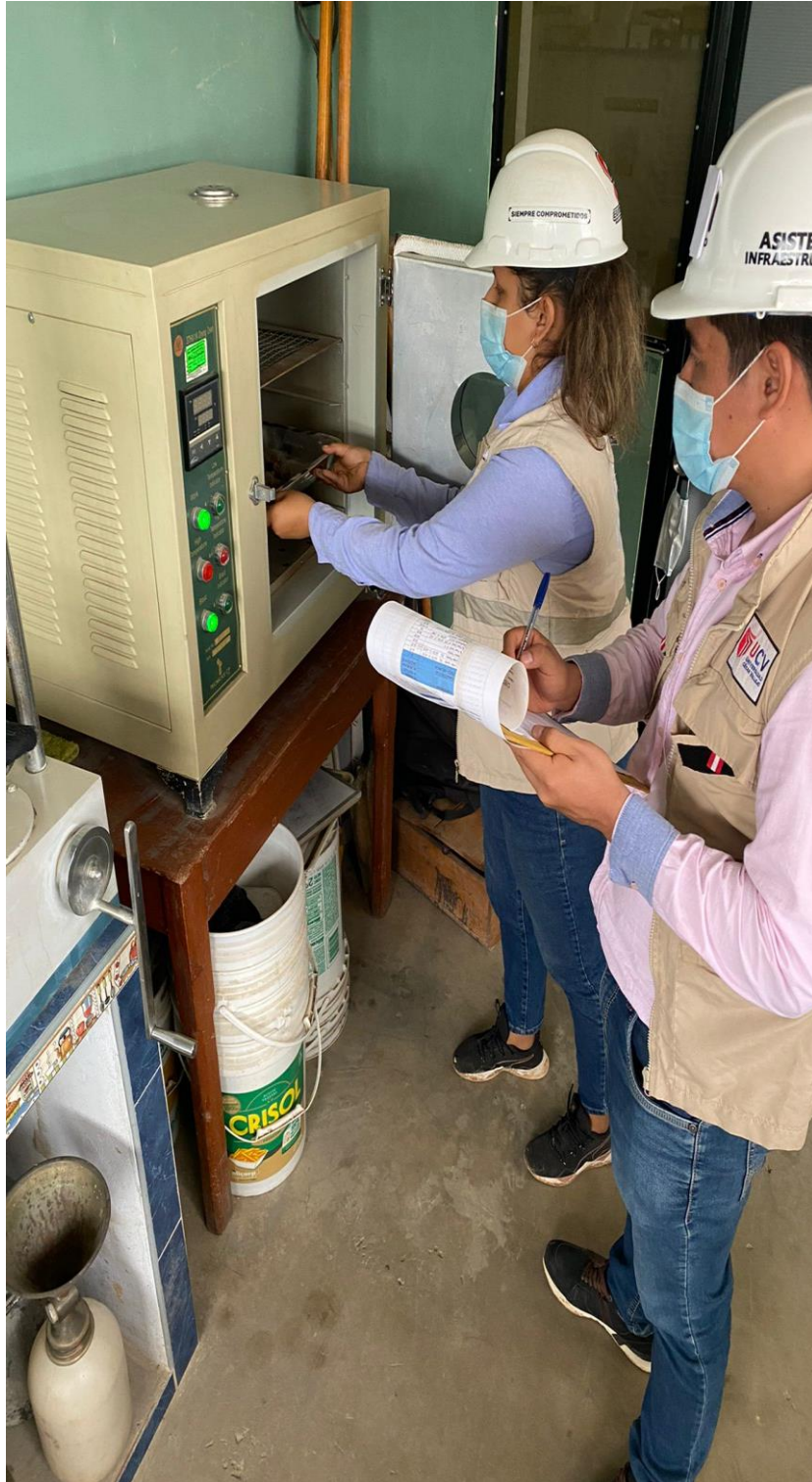
COLOCANDO LA ARENA DENTRO DEL HORNO PARA EL SECADO DE LA MUESTRA
