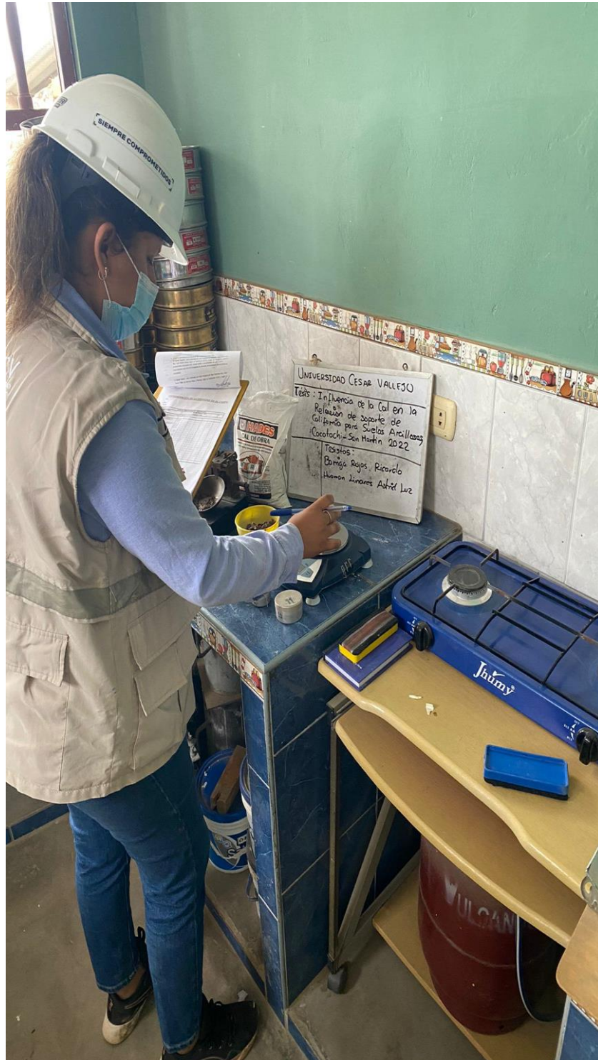
PESANDO LA MUESTRA HUMEDAD
