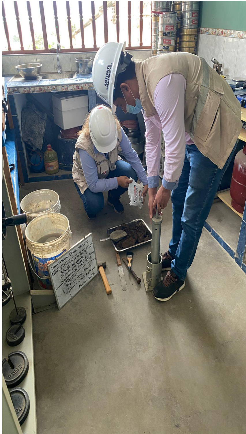
COLOCANDO LA CAL PARA COMBINAR CON LA MUESTRA
