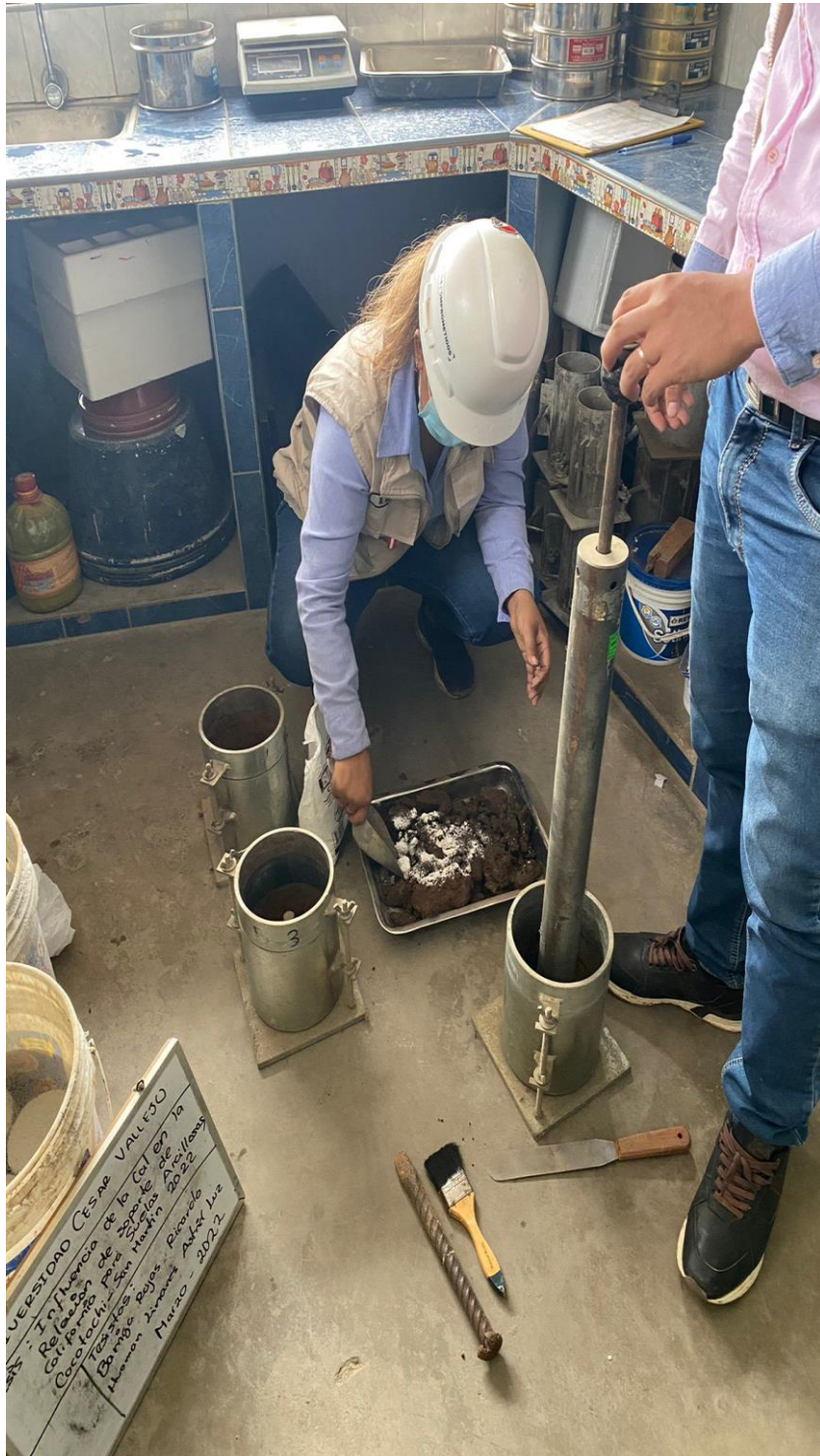
PROCESO DE MESCLADO DE CAL CON LA MUESTRA
