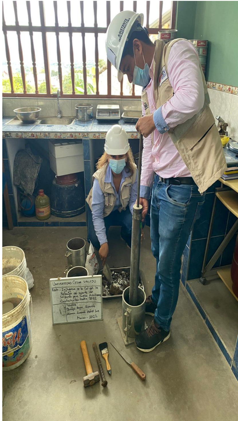
MUESTRA COMBINADA CON CAL Y LISTA PARA SER APISONADA
