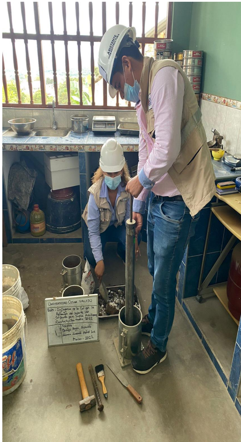
MUESTRA COMBINADA CON LA CAL
