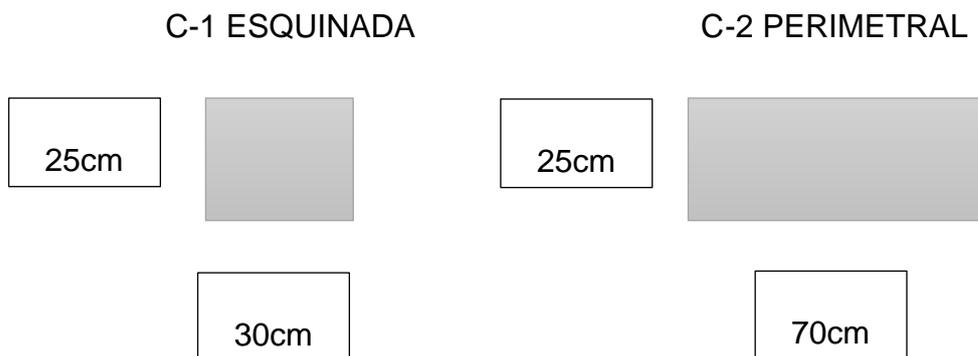
FIGURA N° 3. Detalle de Columna
