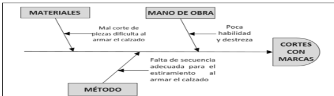
Figura 8: Ishikawa defecto de calidad cortes con marcas en la zona de armado Fuente: Reunión con personas involucradas y dueño
