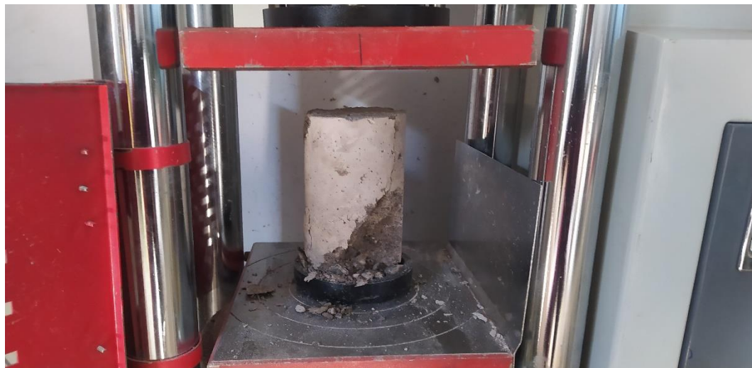
Fotografía N° 20: Rotura de probetas de concreto.
