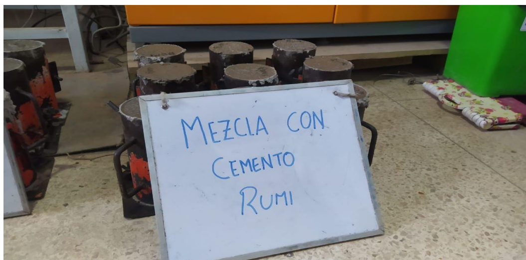
Fotografía N° 12: Probetas de concretos preparados para la resistencia a la compresión durante los 7 días con Cemento Rumi.
