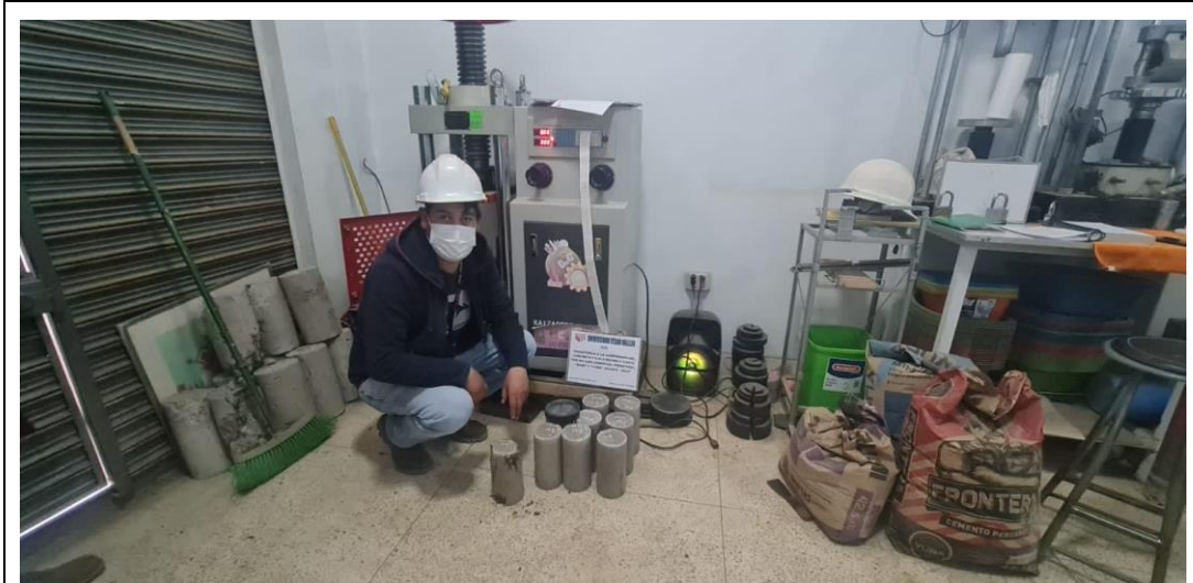
Fotografía N° 15: En la imagen se muestra las probetas antes de la rotura.
