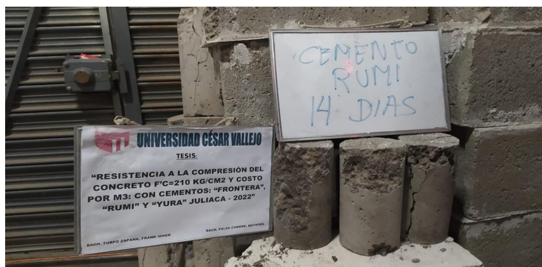
Fotografía N° 18: En la imagen se muestra la rotura de probeta de los 14 días con Cemento Rumi.
