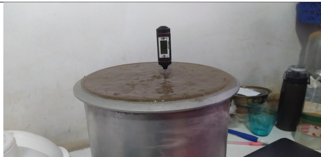
Fotografía N° 10: Control de temperatura, preparado con Cemento Yura.
