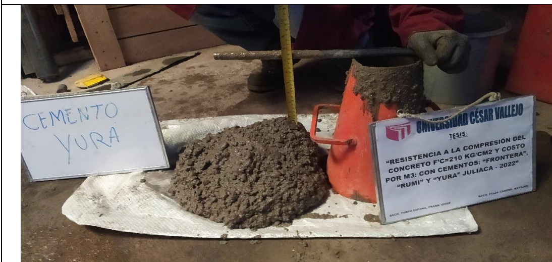
Fotografía N° 7: Asentamiento del concreto con Cemento Yura.
