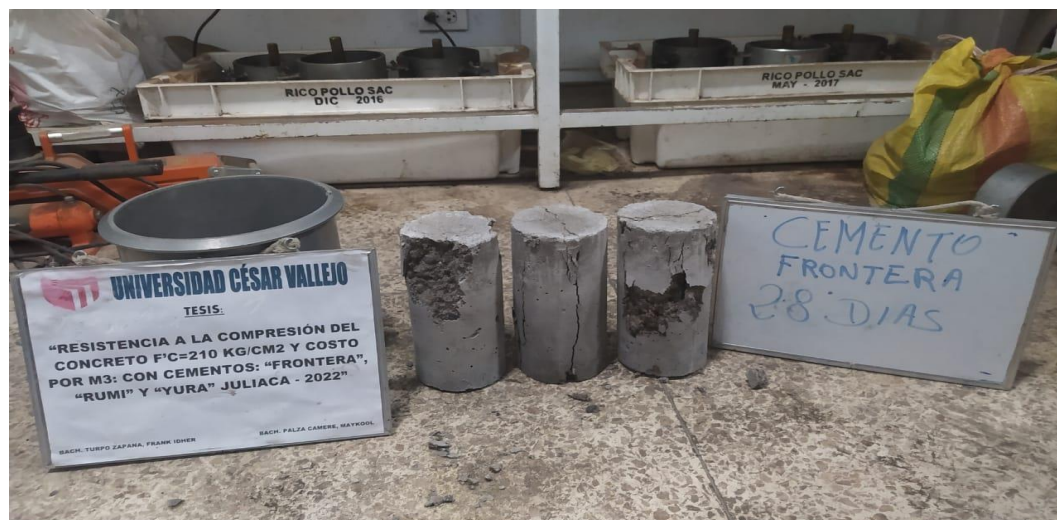
Fotografía N° 26: En la imagen se muestra la rotura de probeta de los 28 días con Cemento Frontera.
