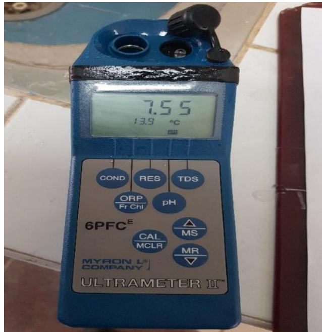
Figura 9. Medición de limite permisible pH laboratorio. Fuente: Elaborado por el equipo de investigador, abril - 2022.
