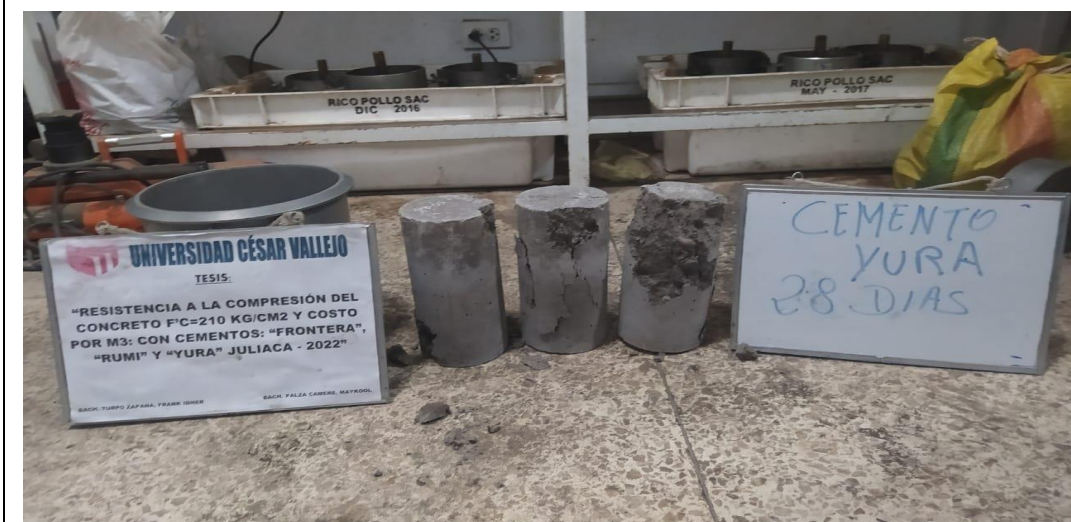
Fotografía N° 28: En la imagen se muestra la rotura de probeta de los 28 días con Cemento Yura.
