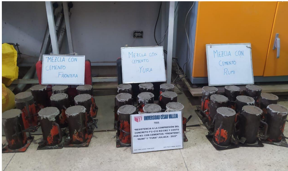
Figura 2. Elaboración de las probetas de concreto. Fuente: Elaborado por el equipo de investigador, abril - 2022.
