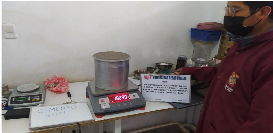
Fotografía N° 9: Control de peso, Cemento Rumi.
