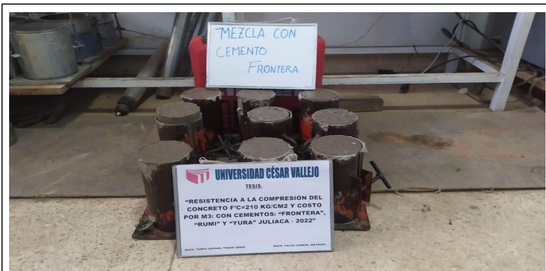
Fotografía N° 11: Probetas de concreto preparados para la resistencia a la compresión durante los 7 días con Cemento Frontera.
