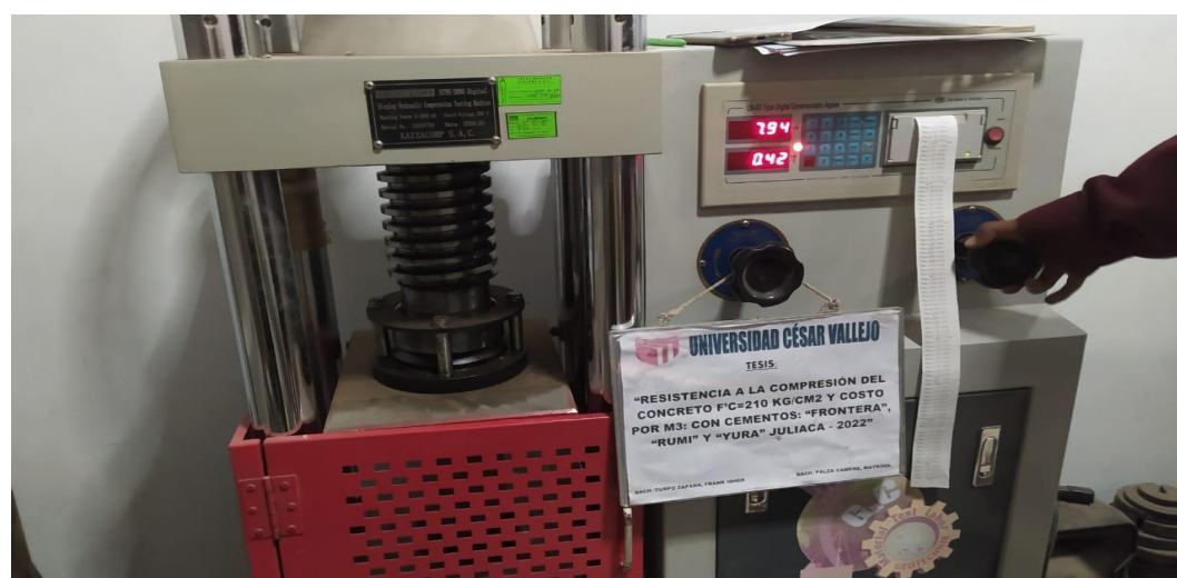
Fotografía N° 24: Lectura de rotura de probeta con Cemento Frontera a los 28 días.
