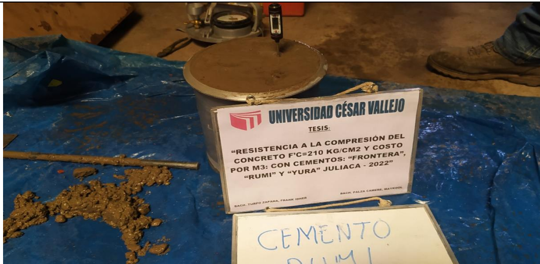
Fotografía N° 8: Control de temperatura, preparado con Cemento Rumi.
