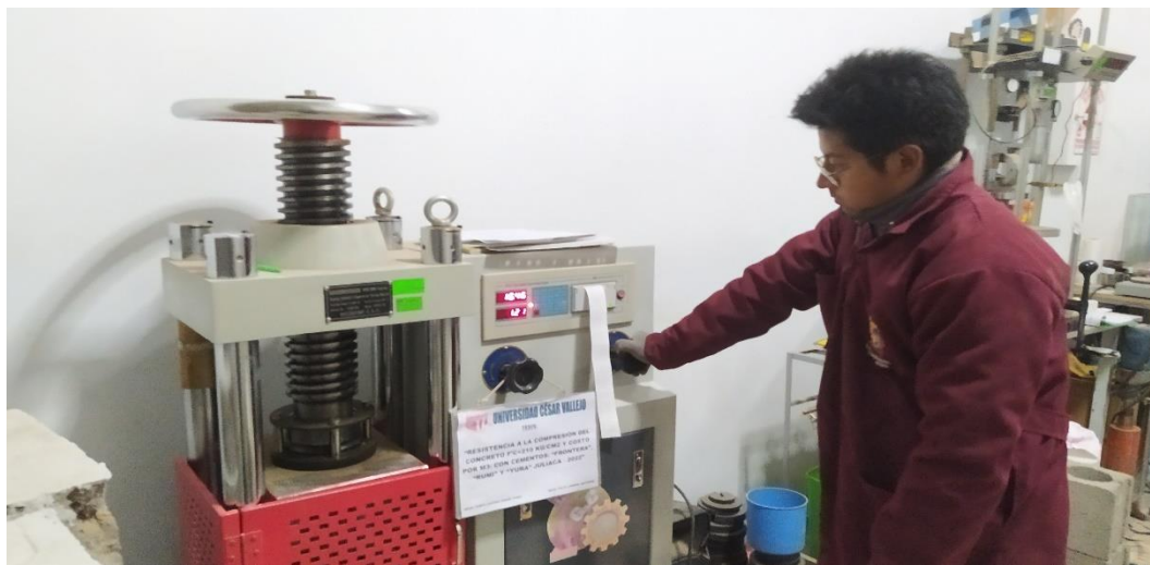
Fotografía N° 16: Rotura de probeta de concreto.
