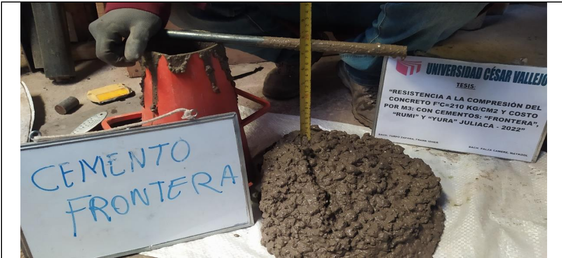
Fotografía N° 5: Asentamiento de concreto con Cemento Frontera.
