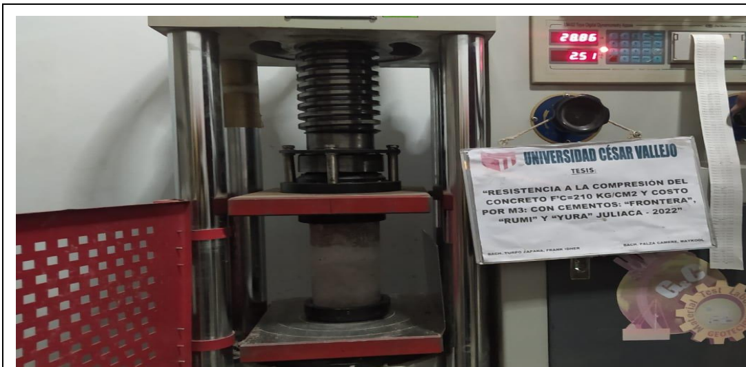
Fotografía N° 25: Lectura de rotura de probeta con Cemento Rumi a los 28 días.
