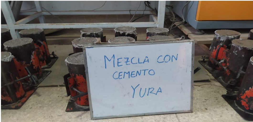
Fotografía N° 13: Probetas de concreto preparados para la resistencia a la compresión durante los 7 días con Cemento Yura.
