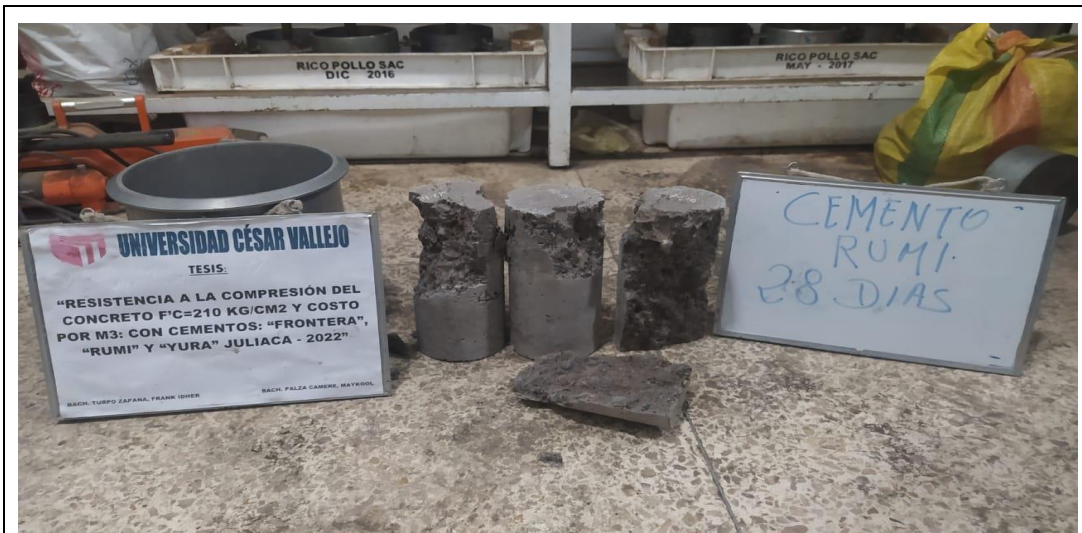
Fotografía N° 27: En la imagen se muestra la rotura de probeta de los 28 días con Cemento Rumi.
