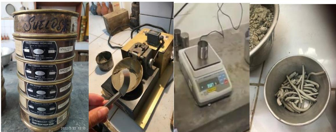
Polietileno cortado y dosificación al peso del suelo seco
