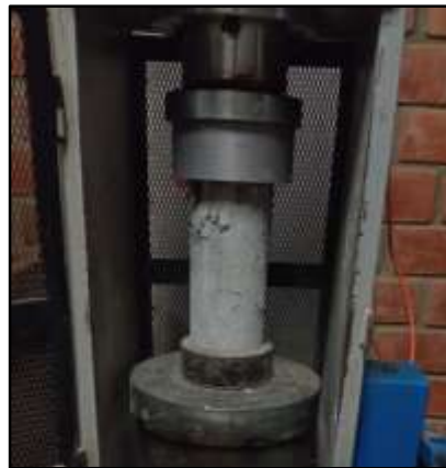
Figura 10. Esquema ensayo a compresión
