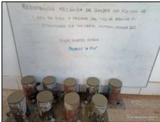
Figura 4. Probetas cilíndricas muestra patrón
