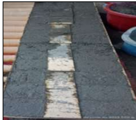
Figura 5. Probetas prismáticas muestra patrón
