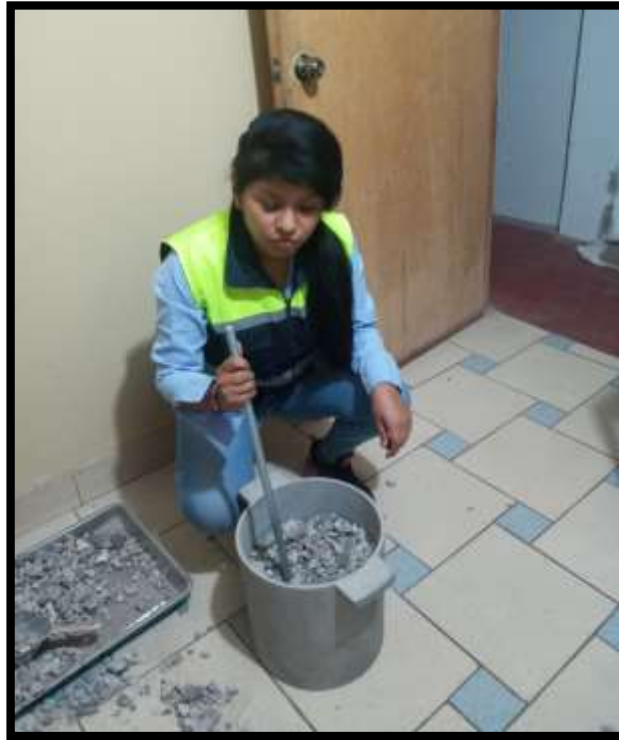
Figura 12. Se aprecia realización de ensayo: Peso unitario y compactado de agregado grueso.
