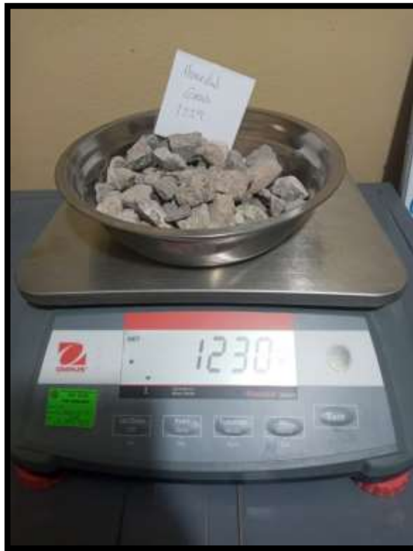
Figura 18. Pesamos muestra para ensayo: Contenido de humedad.
