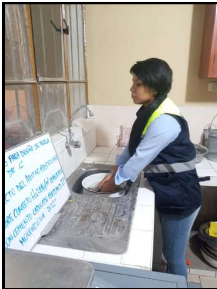
Figura 15. Lavando muestra de agregado grueso.
