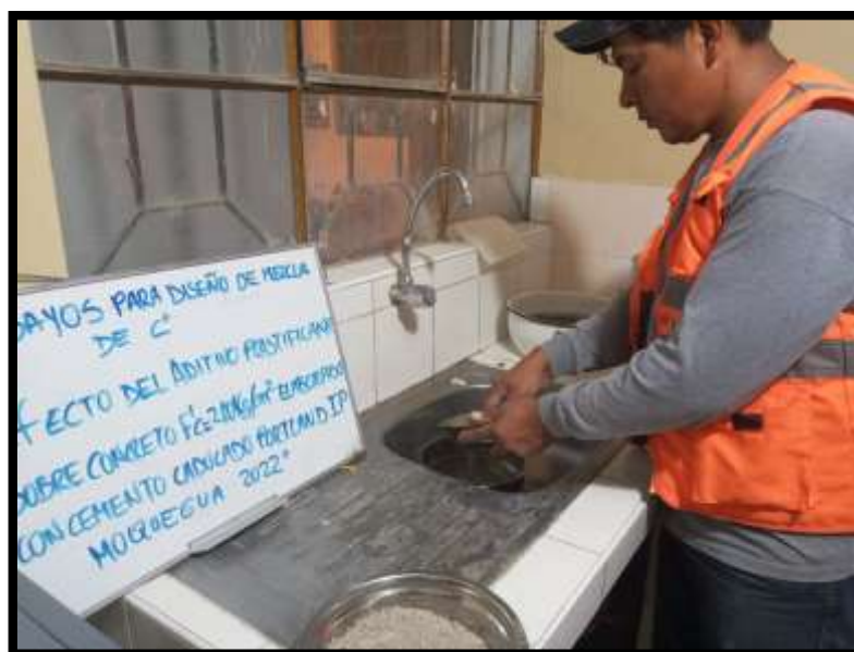
Figura 17. Lavando muestra agregado fino.
