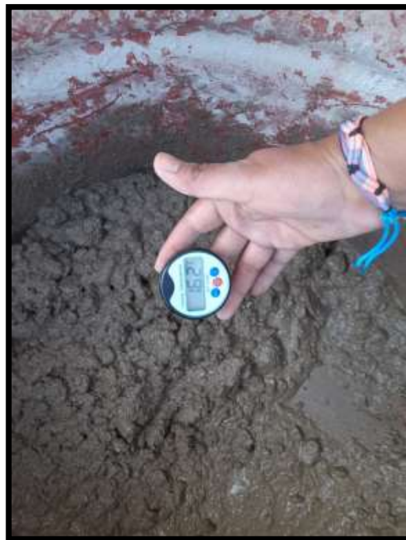
Figura 31. Se aprecia temperatura del concreto en esta fresco.
