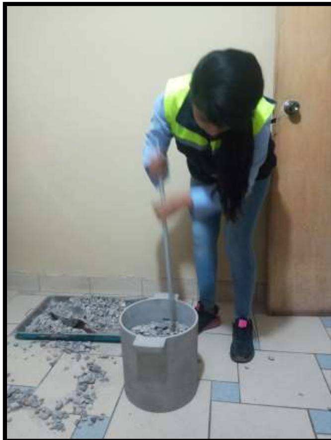
Figura 11. Realizando ensayo: Peso unitario de los agregados.
