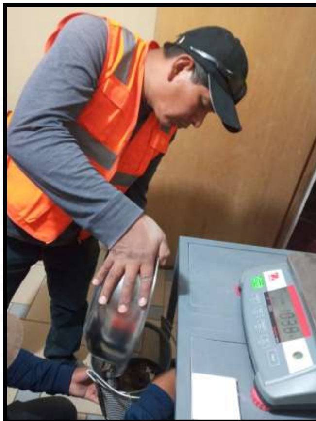
Figura 23. Incorporación de muestra para realización ensayo: Gravedad específica.
