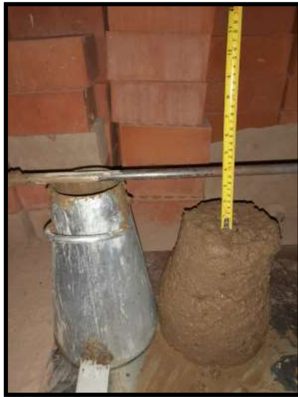
Figura 32. Determinación de Slump o asentamiento.
