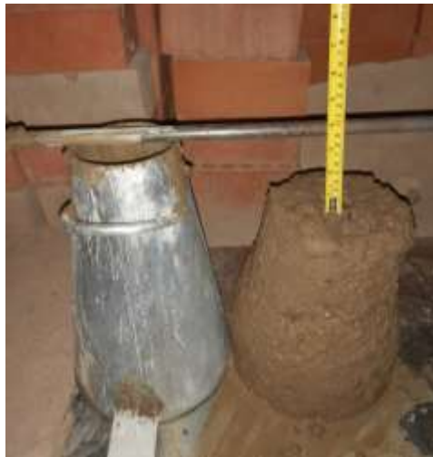
Figura 4. Determinación de slump para el ensayo del concreto FUENTE: Elaboración propia.
