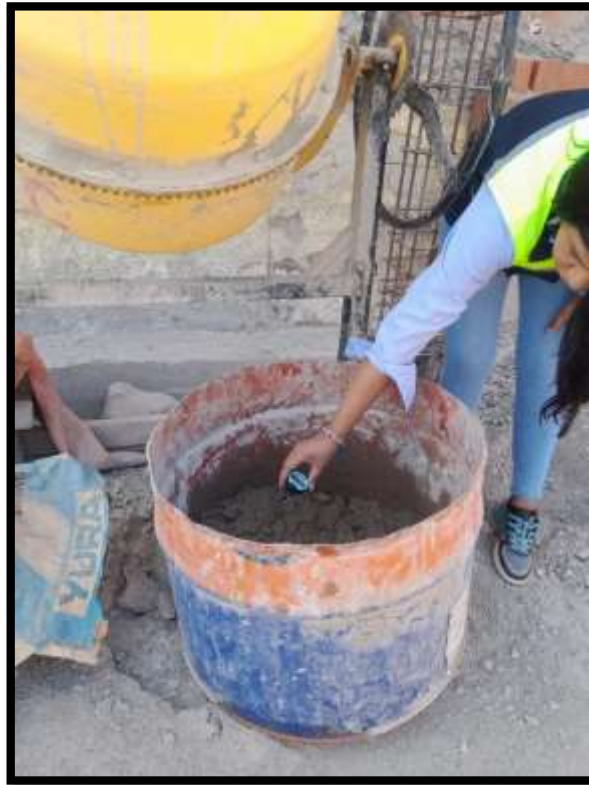
Figura 30. Medición de la temperatura.
