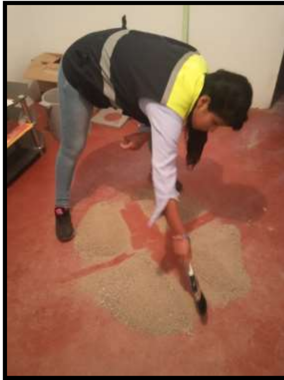
Figura 6. Se aprecia cuarteo de los agregados para el análisis granulométrico.
