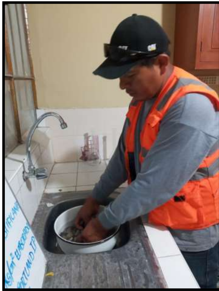
Figura 16. Lavando muestra agregado grueso.
