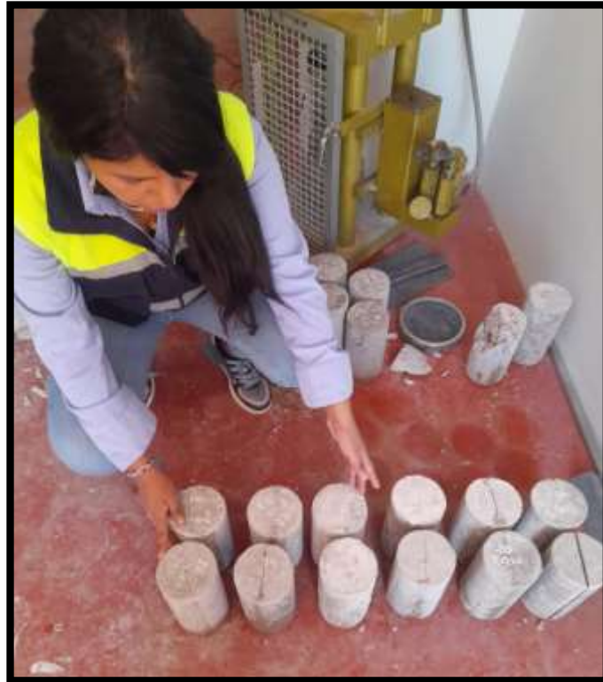
Figura 38. Probetas expuestas a: Esfuerzo a la tracción por compresión diametral – método brasilero.
