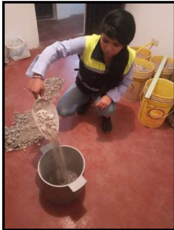
Figura 8. Inicio de Ensayo para determinación del peso unitario de los agregados.
