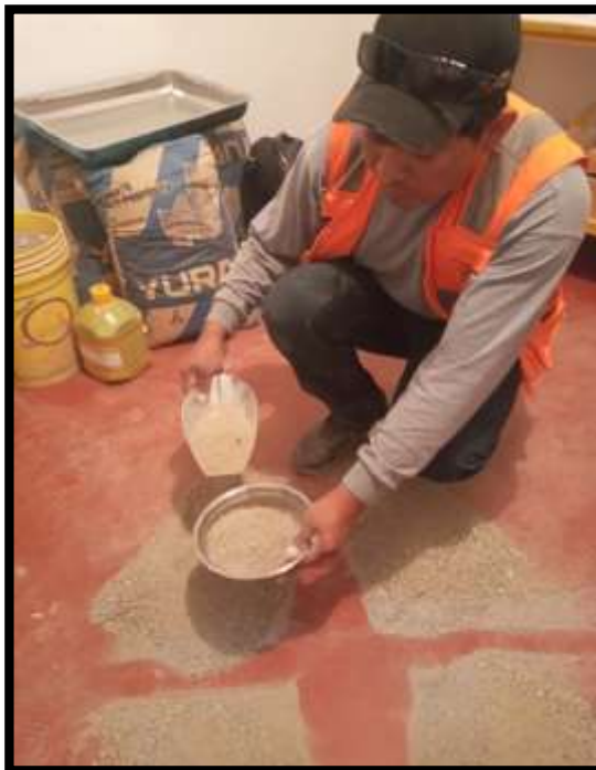
Figura 7. Se aprecia recojo de muestra ya cuarteada.
