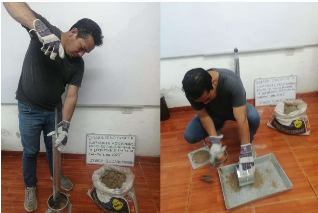
Imágenes de procedimiento del ensayo proctor
