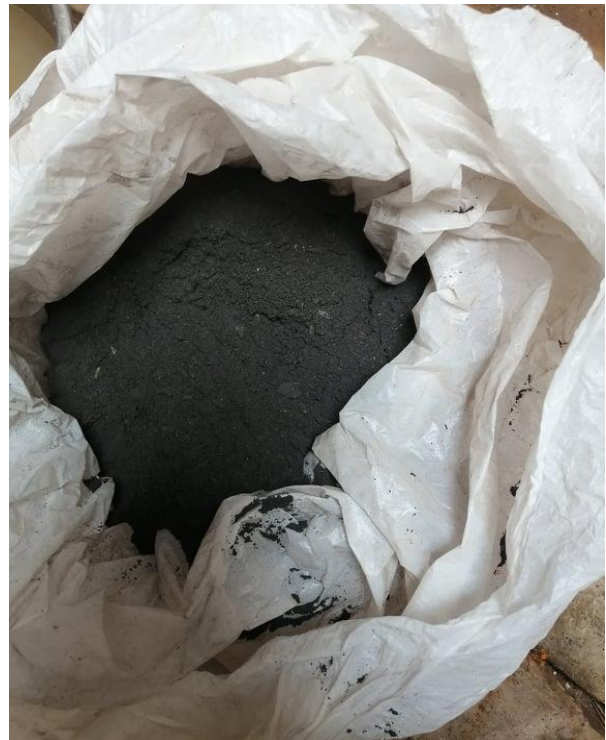
Fotografía 5: Incinerado de fibra de maíz y tamizado de ceniza de fibra de maíz
