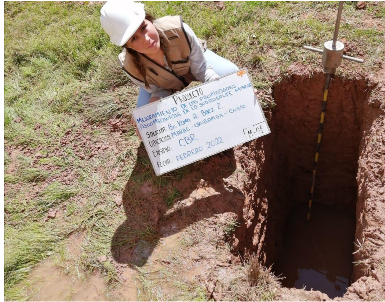
Fotografía 1: Extracción de calicatas
