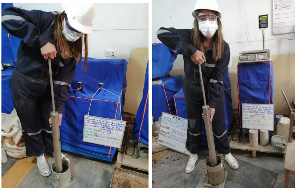
Fotografía 10: Ensayos de Proctor Modificado en material en estado natural y con adición de ceniza de fibra de maíz
