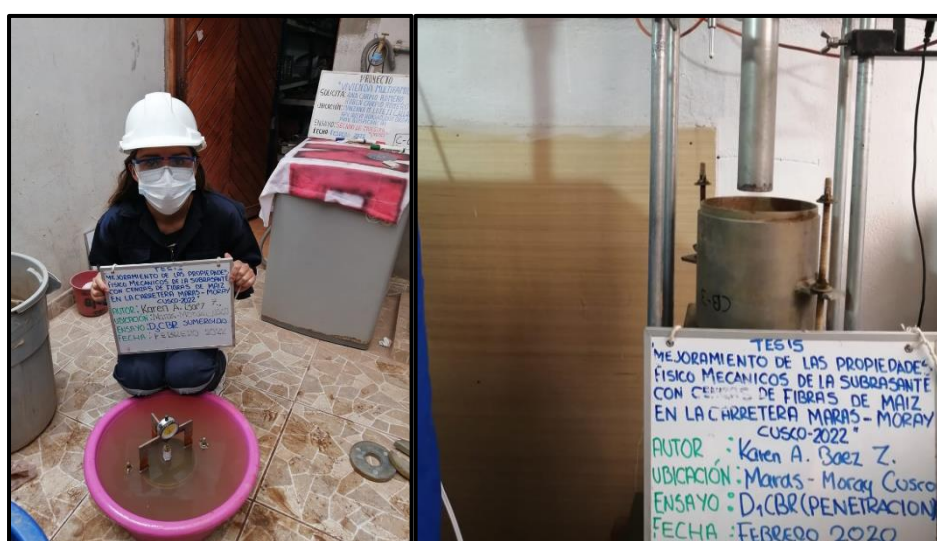
Figura 24 Ensayo de CBR del material en C-1 con adición de ceniza de fibra de maíz
