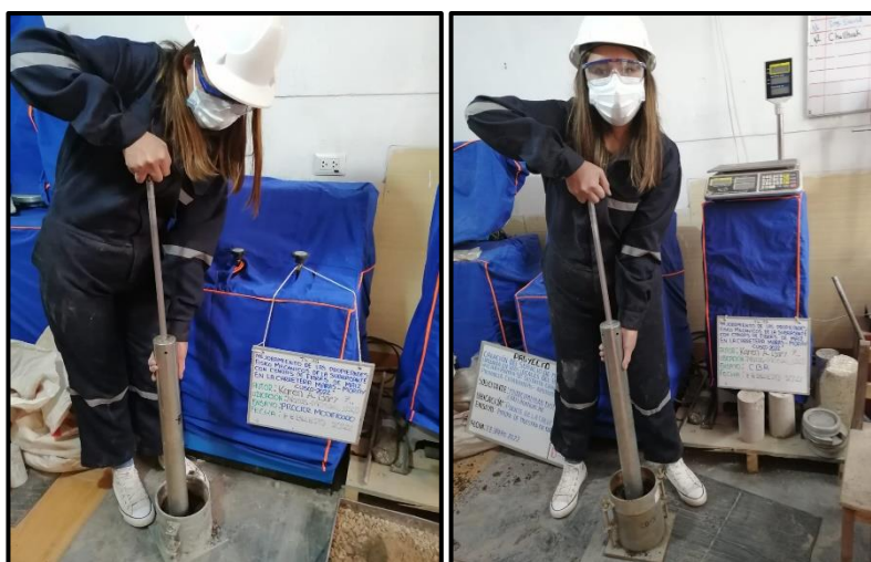
Figura 19 Ensayo de Proctor Modificado del material en C-3 con adición de ceniza de fibra de maíz
