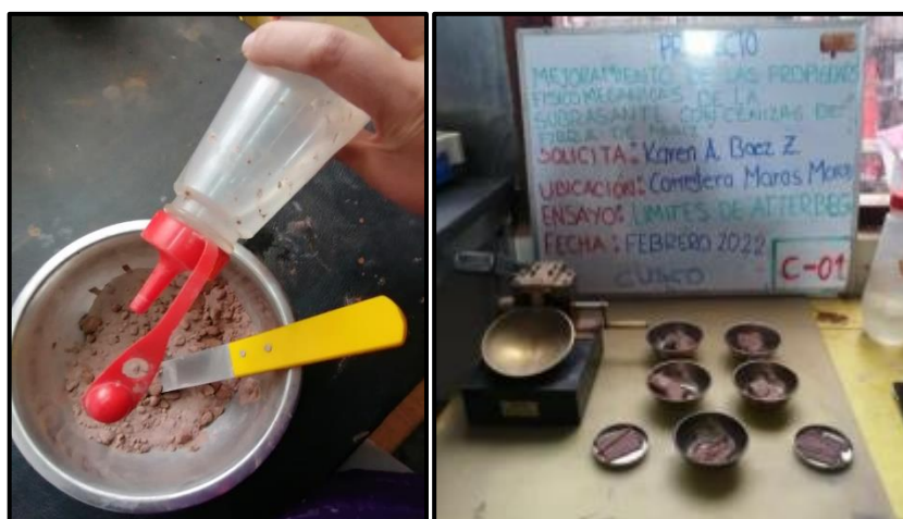
Figura 16 Ensayo de límites de Atterberg del material en C-1 con adición de ceniza de fibra de maíz
