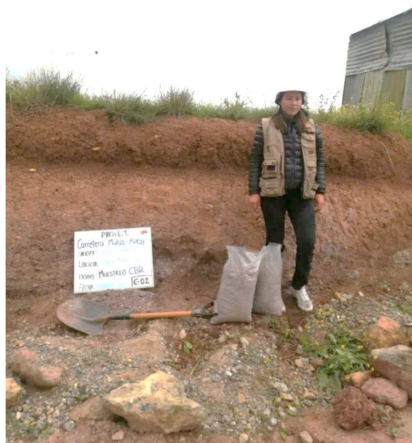
Fotografía 2: Extracción de calicatas
