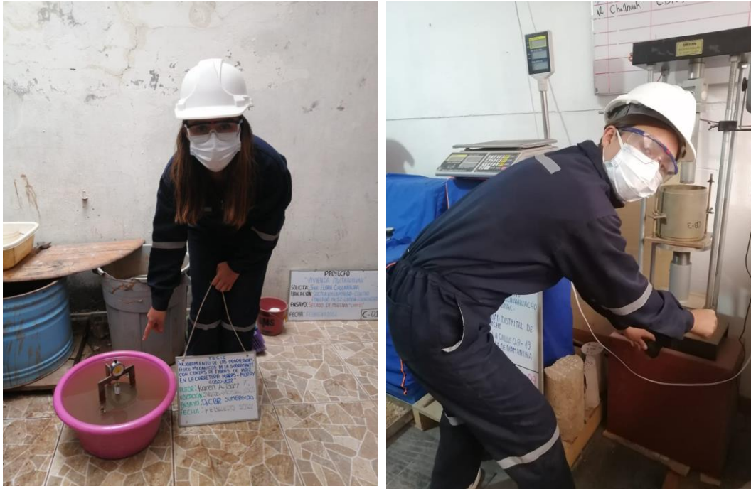
Fotografía 11: Ensayos de Relación de Soporte de California (CBR) en material en estado natural y con adición de ceniza de fibra de maíz
