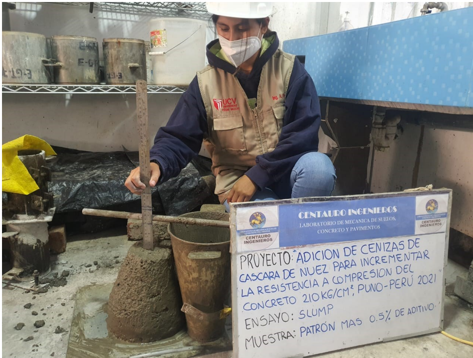
Prueba de Slump
