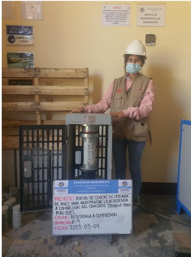
Ensayo de resistencia a la compresión
