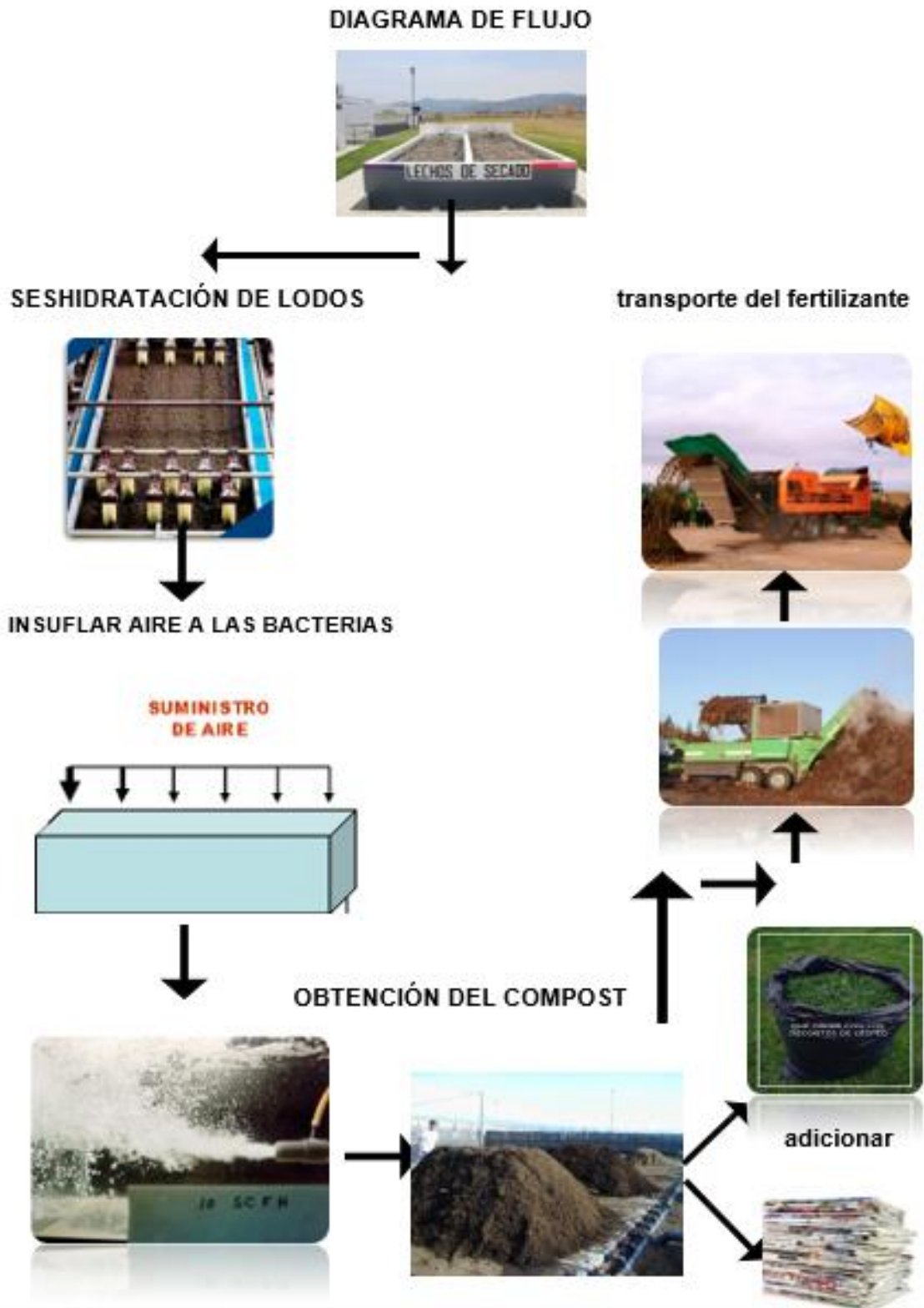
Figura 7 Diagrama de flujo de la reutilización de los lodos residuales en fertilizantes
