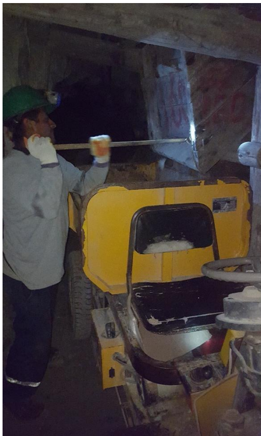
Llenado de mineral desde el buzón al Mini Dumper Eléctrico en el acarreo
