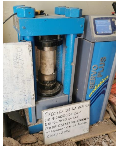
Figura 41. Briqueta en la máquina.
