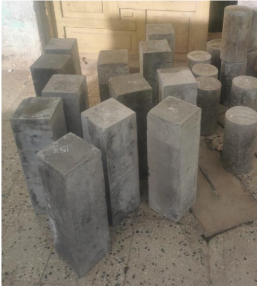
Figura 43. Prismas de concreto
