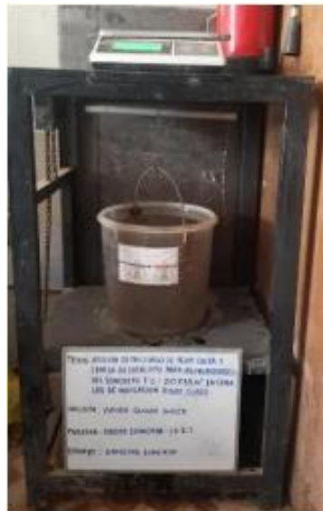
Figura 17. Ensayo de gravedad específica.
