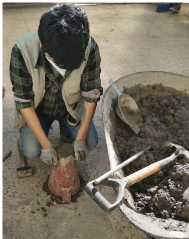
Figura 37. Ensayo del cono de Abrams.
