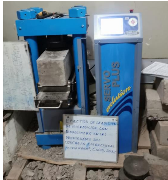
Figura 44. Prisma de concreto en el ensayo
