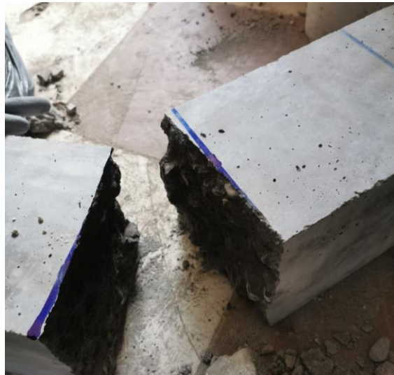
Figura 45. Prisma de concreto ensayado.
