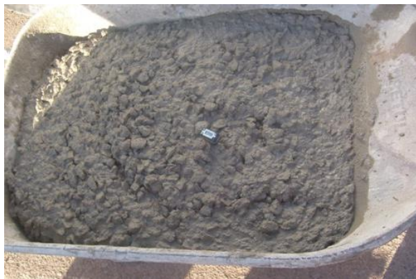
Figura 39. Termómetro sumergido en el concreto.
