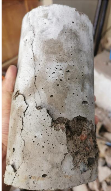
Figura 42. Briqueta después de aplicada la carga que la rompa.
