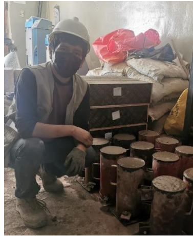
Figura 34. Vigas y briquetas.
