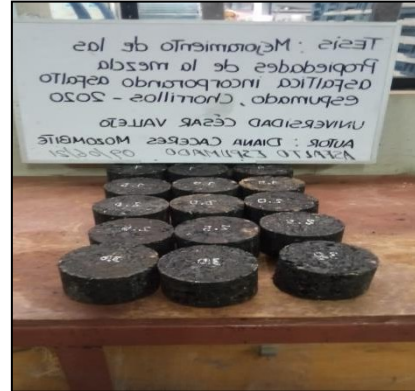
Figura 12. Briquetas de Asfalto espumado
