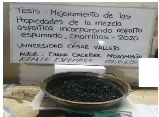
Figura 24. Mezcla asfáltica caliente
