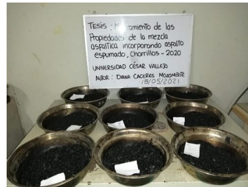
Figura 16. Mezcla asfáltica espumada
