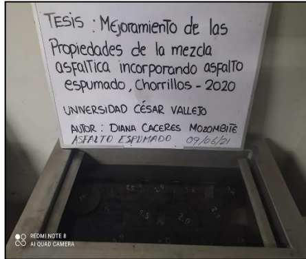
Figura 10. Briquetas en baño María
