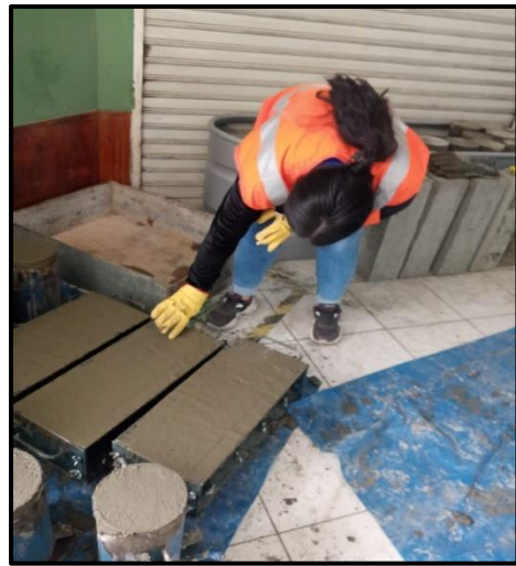
Foto 12. Elaboración de especímenes, compresión, tracción y viga
