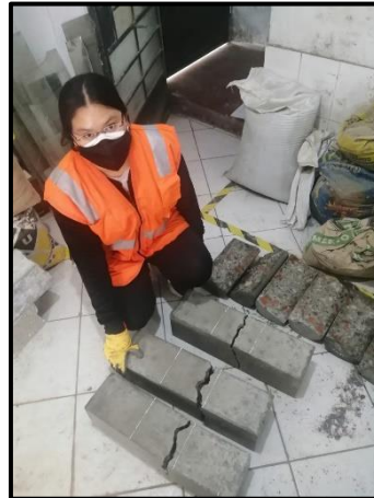
Foto 15. Ensayo de tracción indirecta a los 7, 14 y 28 días de edad
