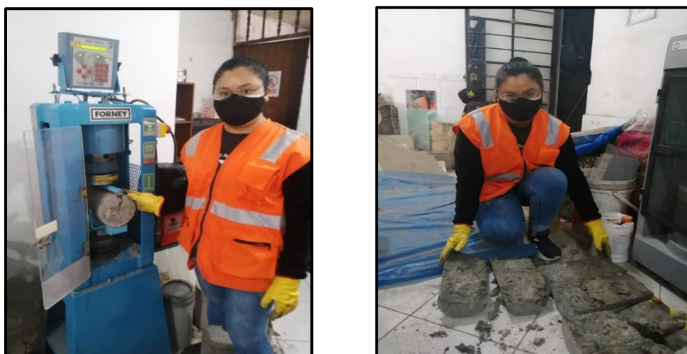
Figura 14. Ensayo de Resistencia a Tracción Indirecta
