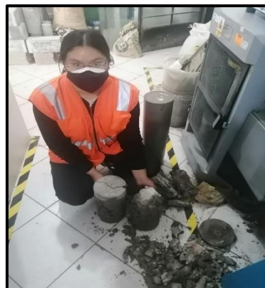
Foto 14. Ensayo de compresión a los 7, 14 y 28 días de edad
