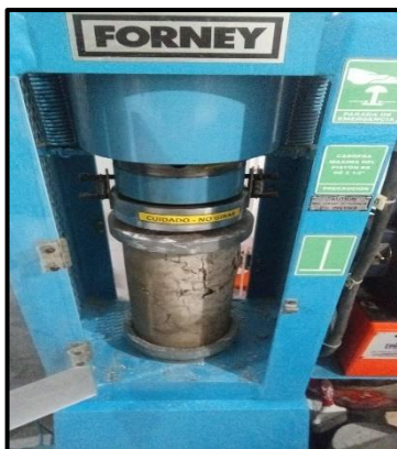
Foto 14. Ensayo de compresión a los 7, 14 y 28 días de edad
