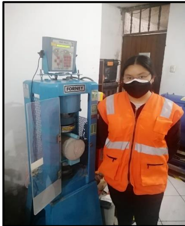
Foto 15. Ensayo de tracción indirecta a los 7, 14 y 28 días de edad
