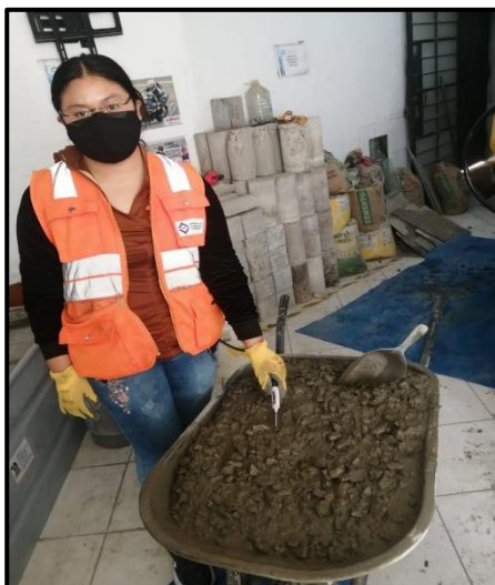
Foto 11. Temperatura y Ensayo de asentamiento
